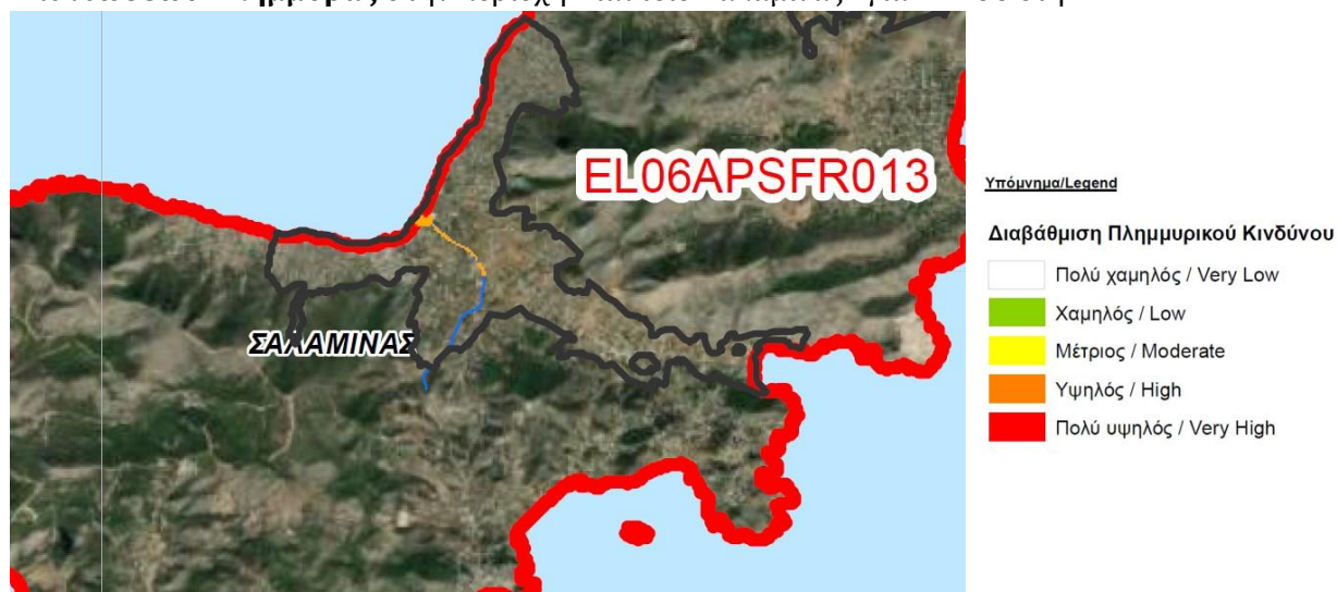
Σχήμα 3.25: Απόσπασμα Χάρτη (EL06-07-FRES-100-80-50-4160-02) Αποτίμησης Επιπτώσεων Πλημμύρας στην περιοχή Αιάντειο Σαλαμίνας για T=100 έτη
