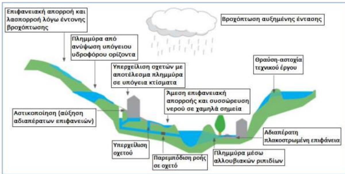
Σχήμα 4.2.3-1: Κύρια αίτια και τύποι πλημμυρών
