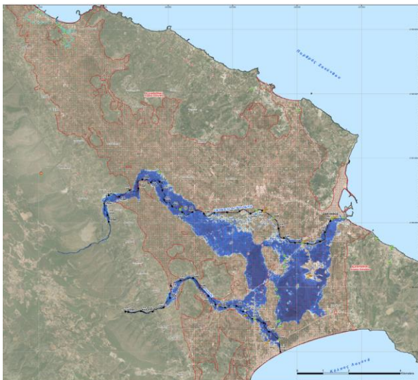
Σχήμα 4.4: Μέγιστο βάθος ροής στη Ζάκυνθο για T=100 έτη σύμφωνα με τους ΧΕΠ
