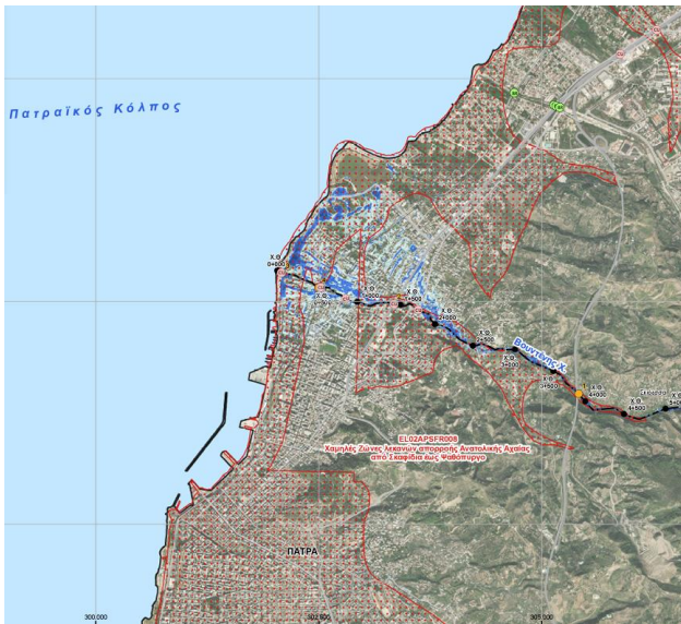
Σχήμα 3.22 : Μέγιστο βάθος ροής στην Πάτρα από χ. Βουντένη για T=100 έτη σύμφωνα με τους ΧΕΠ
