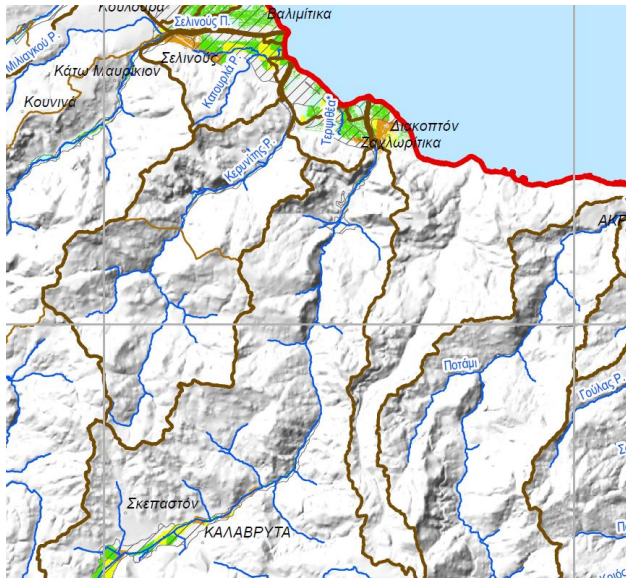
Σχήμα 3.24 : Αποτίμηση επιπτώσεων πλημμυρικού κινδύνου στην Ακράτα, στα Καλάβρυτα και στα Μελίσσια Αχαΐας εντός της ΖΔΥΚΠ ΕΛ02ΑΡSFR007 για T=100 έτη
