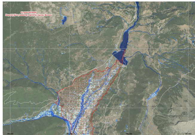
Σχήμα 3.11 : Μέγιστο βάθος ροής στην Γκούρα Κορινθίας για T=100 έτη σύμφωνα με τους ΧΕΠ
