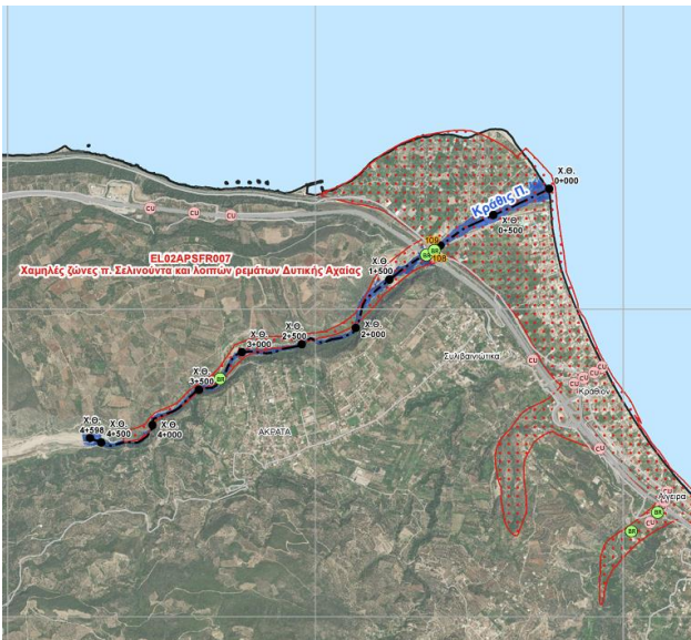
Σχήμα 3.18 : Μέγιστο βάθος ροής στην Ακράτα για T=100 έτη σύμφωνα με τους ΧΕΠ
