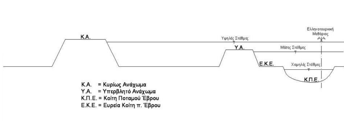
Εικόνα 2-11: Τυπική διατομή διευθέτησης του π. Έβρου (Ελληνοτουρκική μεθόριος)
