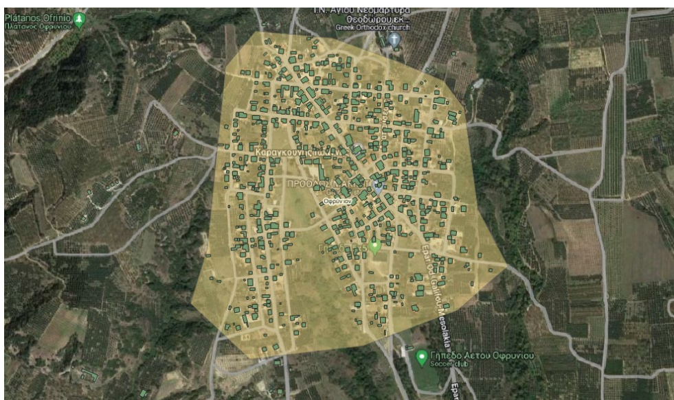
Εικόνα 4-10: Κατασκευή πολυγώνων κτηρίων για τον υπολογισμό του σταθμισμένου συντελεστή Manning του οικισμού Ορφνίου του Δήμου Παγγαίου
