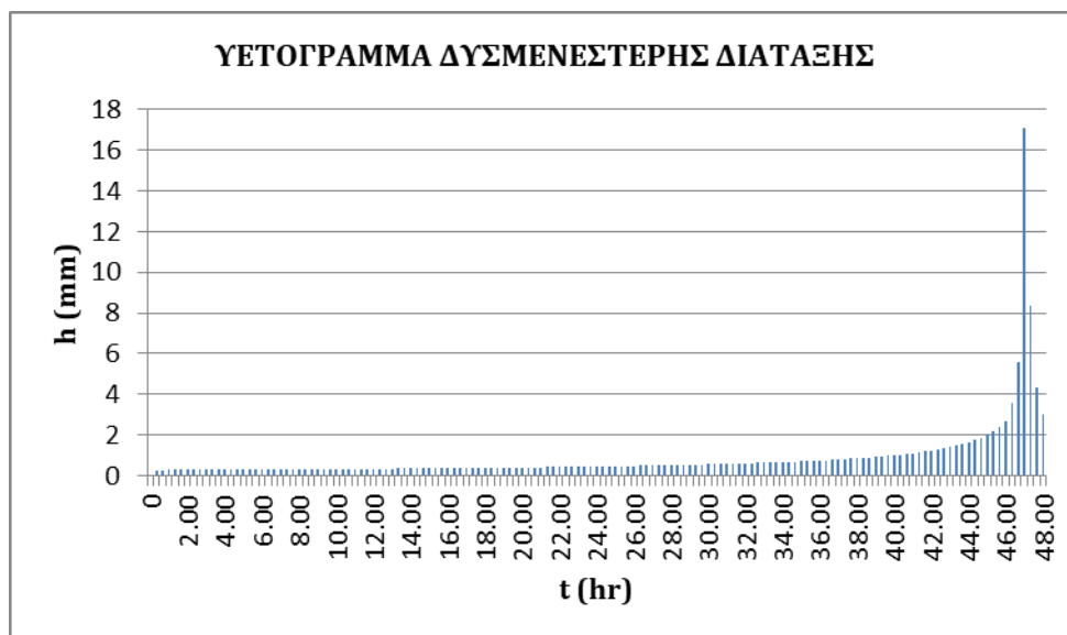
Σχήμα 3-3: Υετόγραμμα δυσμενέστερης διάταξης
