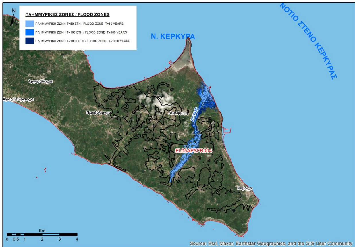
Χάρτης 4.4.2-2: Ζώνες κατάκλυσης για T=50, T=100 και T=1000 έτη για την EL05APFR004.
