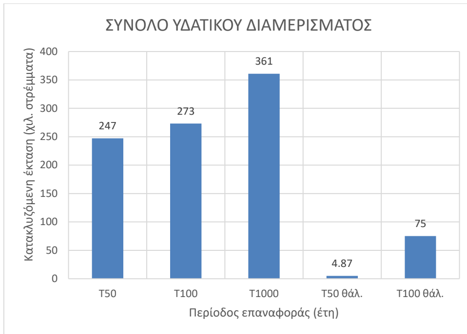
Σχήμα 1.2.3-1: Κατακλυζόμενες εκτάσεις στο ΥΔ Δυτ. Στερεάς Ελλάδας (EL04) για τις πλημμύρες περιόδου επαναφοράς 50, 100 και 1 000 ετών καθώς και για τις θαλάσσιες πλημμύρες περιόδου επαναφοράς 50 και 100 ετών
