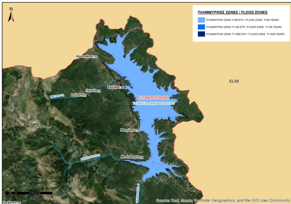
Χάρτης 4.4.2-6: Ζώνες κατάκλυσης για T=50, T=100 και T=1000 έτη για την EL04APSFR006.
