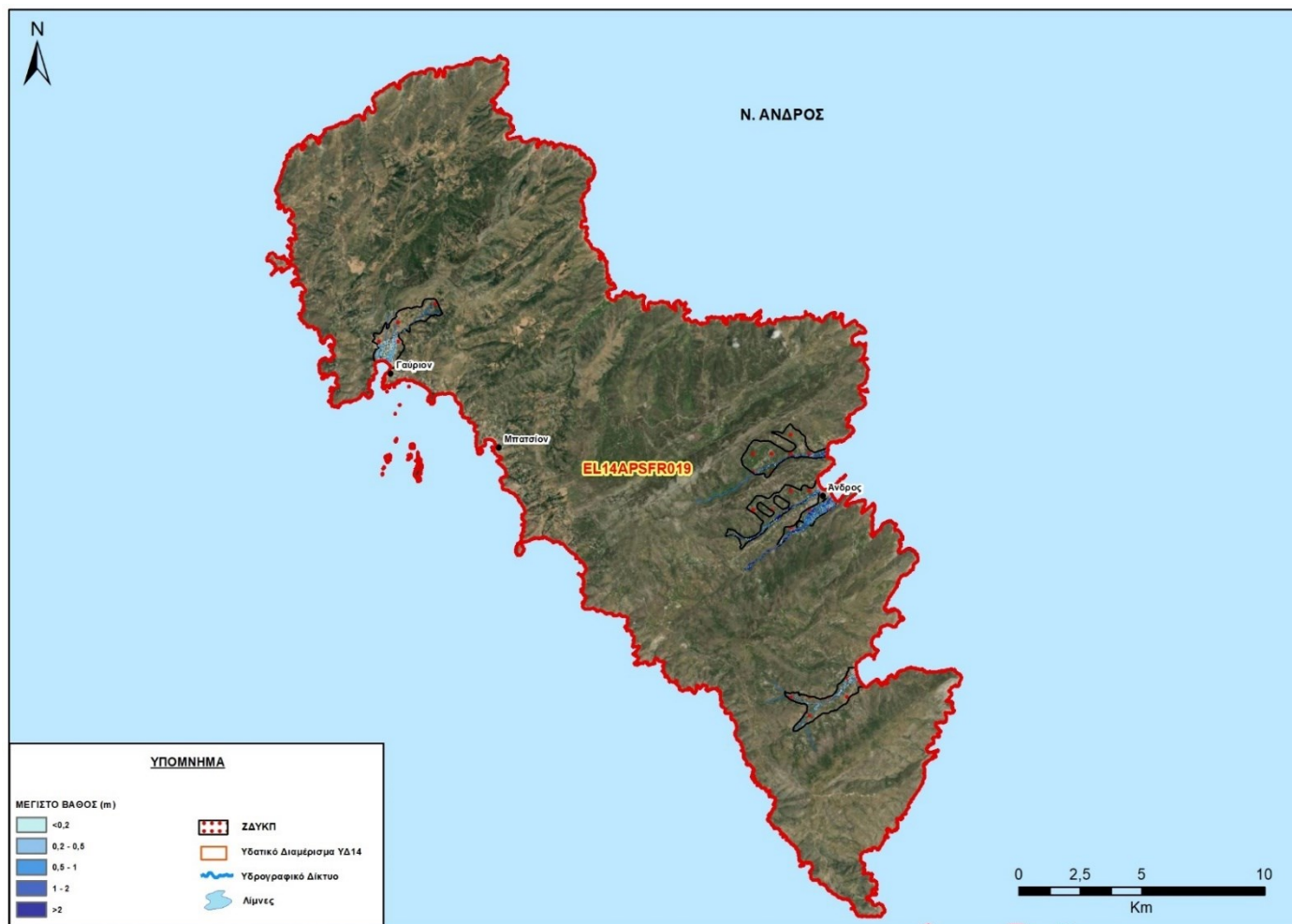
Σχήμα 3.47: Επιφάνειες κατάκλυσης και μέγιστα βάθη ροής Νήσος Άνδρος (T=50 έτη)
