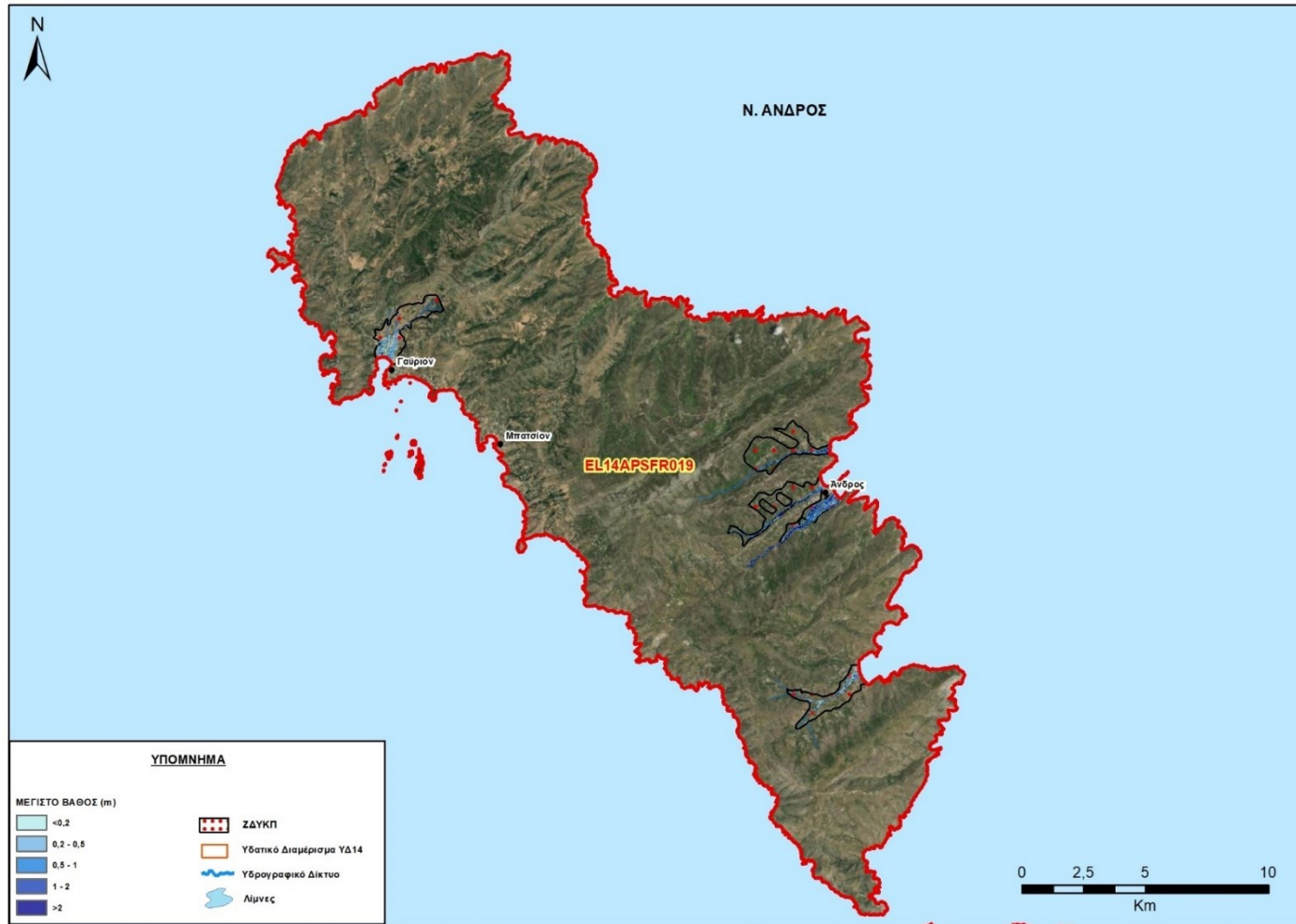
Σχήμα 3.48: Επιφάνειες κατάκλυσης και μέγιστα βάθη ροής Νήσος Άνδρος (T=100 έτη)
