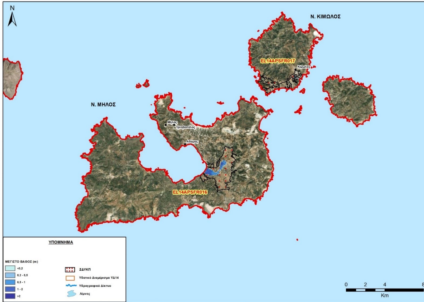
Σχήμα 3.42: Επιφάνειες κατάκλυσης και μέγιστα βάθη ροής Νήσοι Μήλος και Κίμωλος (T=100 έτη)
