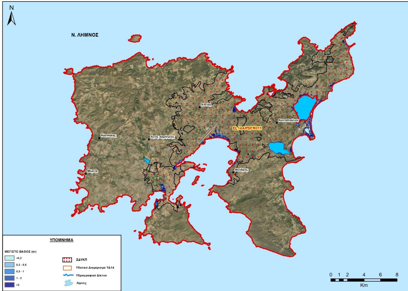
Σχήμα 3.91: Επιφάνειες κατάκλυσης και μέγιστα βάθη ροής από παράκτια πλημμύρα, Νήσος Λήμνος ( T = 100 έτη)
