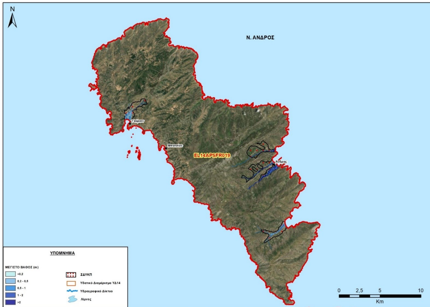
Σχήμα 3.49: Επιφάνειες κατάκλυσης και μέγιστα βάθη ροής Νήσος Άνδρος (T=1 000 έτη)
