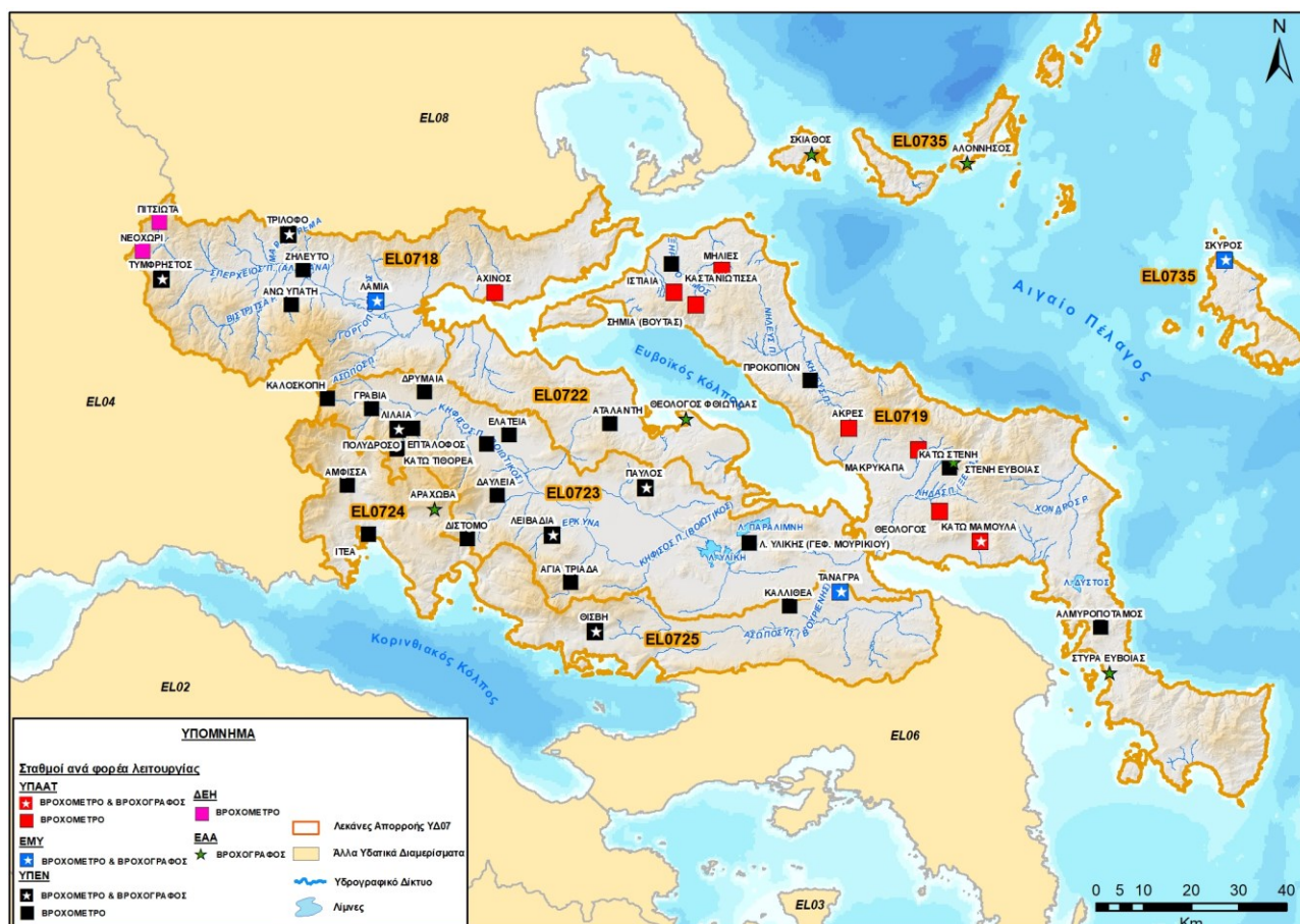
Σχήμα 3-10: Δίκτυο βροχομετρικών και βροχογραφικών σταθμών που χρησιμοποιήθηκαν για την παραγωγή των όμβριων καμπυλών
