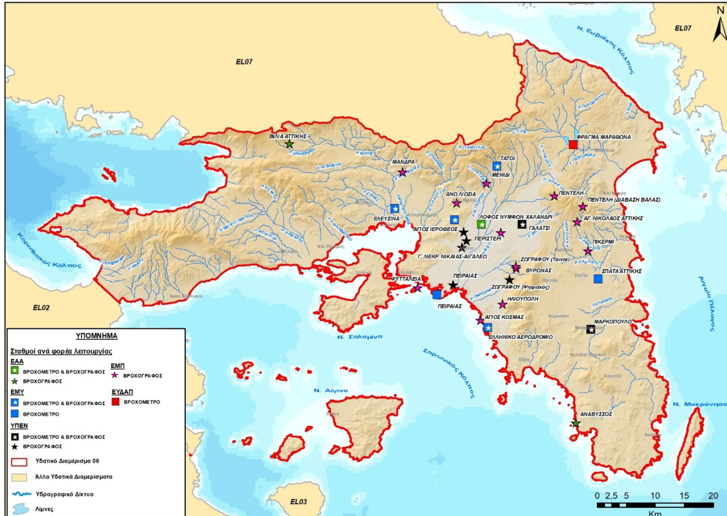
Σχήμα 3.11: Δίκτυο βροχομετρικών και βροχογραφικών σταθμών που χρησιμοποιήθηκαν για την παραγωγή των όμβριων καμπυλών
