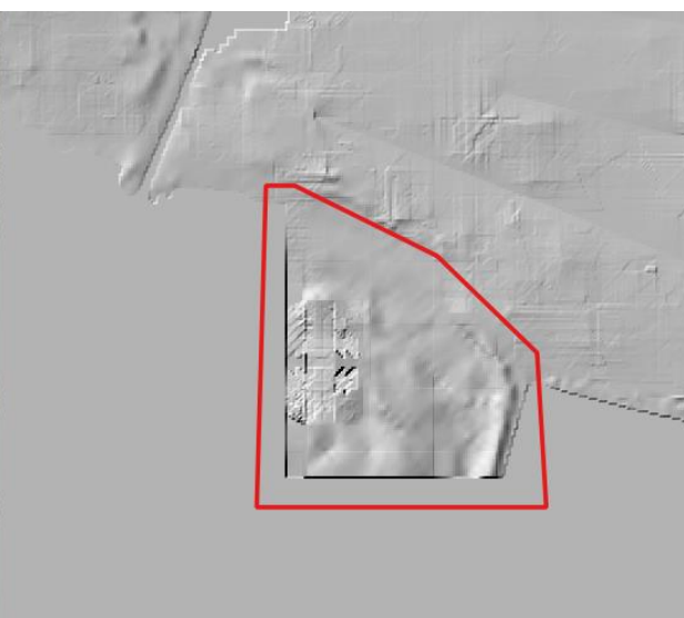
Σχήμα 3.22 : Αστοχία του ΨΜΕ λόγω αυτόματης φωτογραμμετρικής παραγωγής
