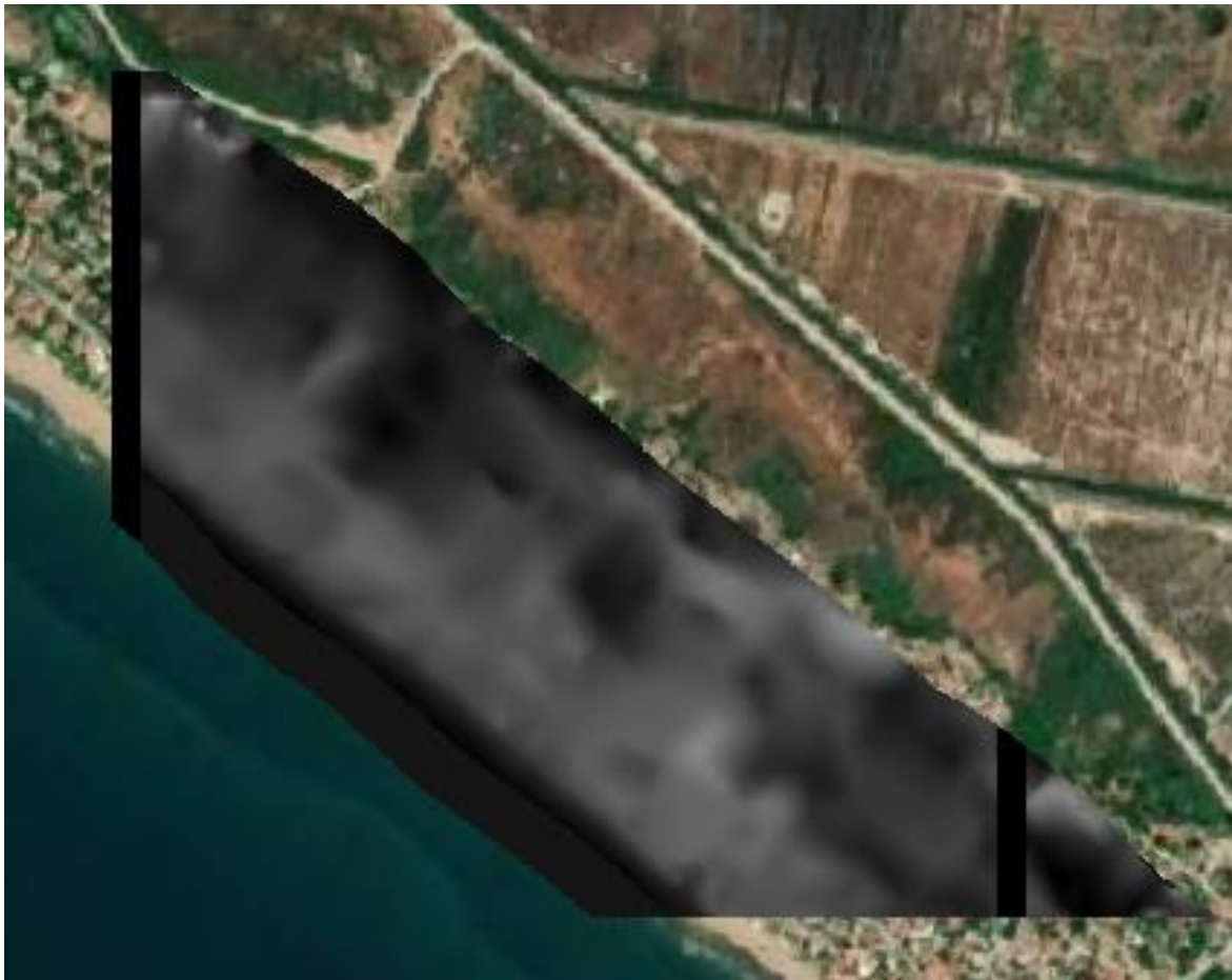
Σχήμα 3.28 : Παράδειγμα αστοχίας του ΨΜΕ στο επικαλυπτόμενο τμήμα διαδοχικών πινακίδων
