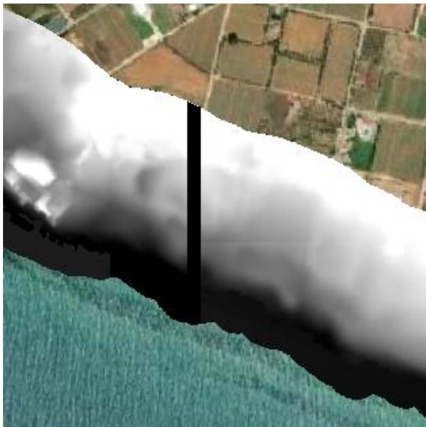
Σχήμα 3.29 : Παράδειγμα αστοχίας του ΨΜΕ στο επικαλυπτόμενο τμήμα διαδοχικών πινακίδων
