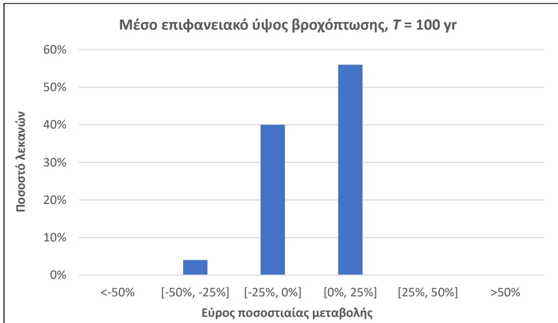
Εικόνα 4-2: Ραβδόγραμμα ποσοστιαίας μεταβολής του μέσου επιφανειακού ύψους βροχόπτωσης, για περίοδο επαναφοράς  $T = 100$  έτη.
