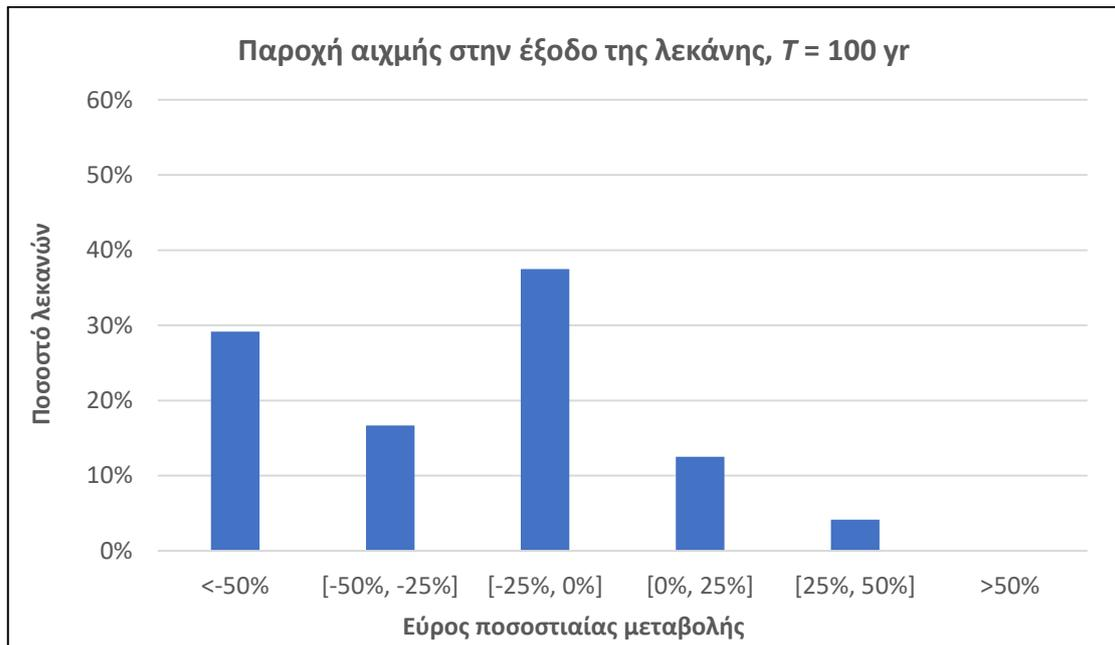
Εικόνα 4-8: Ραβδόγραμμα ποσοστιαίας μεταβολής των παροχών αιχμής στις εξόδους των λεκανών, για περίοδο επαναφοράς  $T = 100$  έτη.
