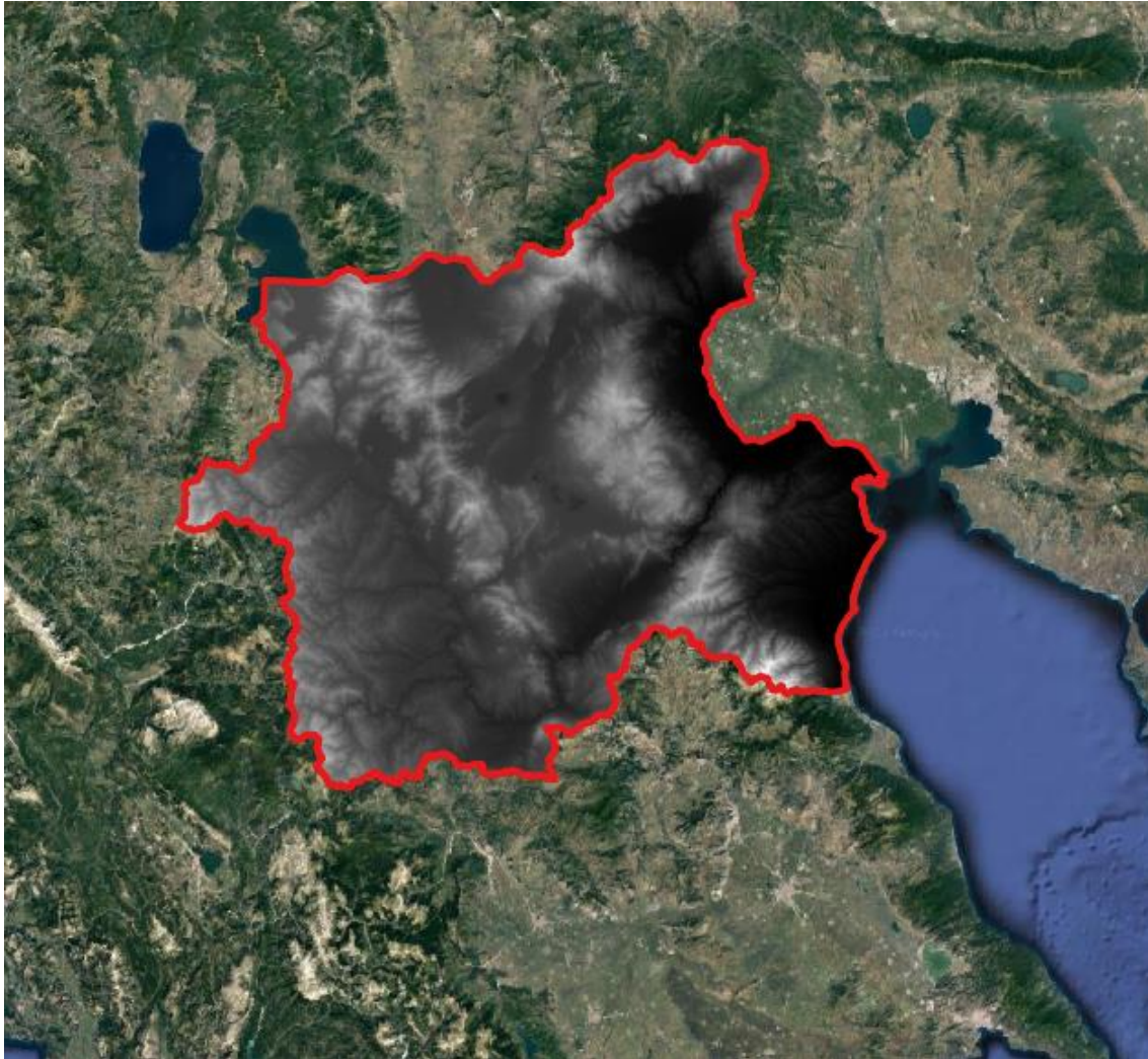
Εικόνα 3-13: Τελική μορφή ψηφιακού μοντέλου εδάφους
