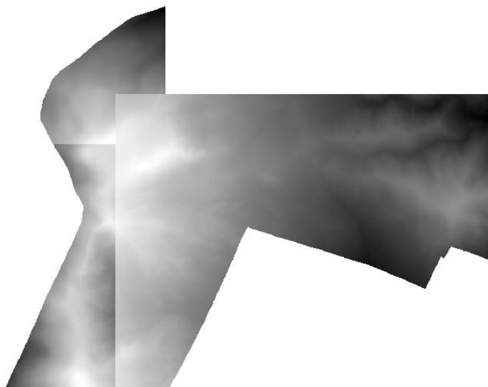
Εικόνα 3-4: Πρωτογενής μορφή διαθέσιμου ψηφιακού μοντέλου εδάφους 5x5
