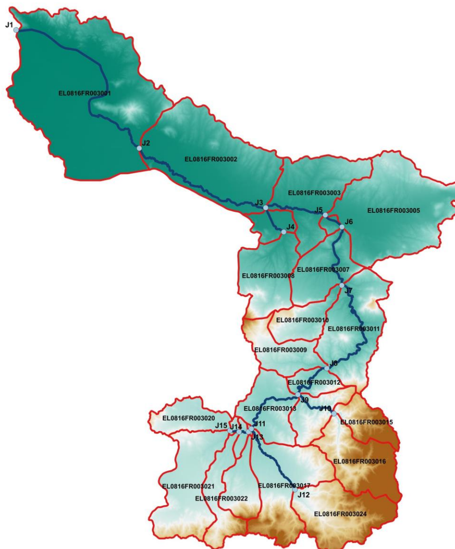
Εικόνα 6-3 Χάρτης περιοχής μελέτης, στον οποίο απεικονίζεται η σχηματοποίηση των κόμβων και κλάδων του υδρογραφικού δικτύου και των υπολεκανών
