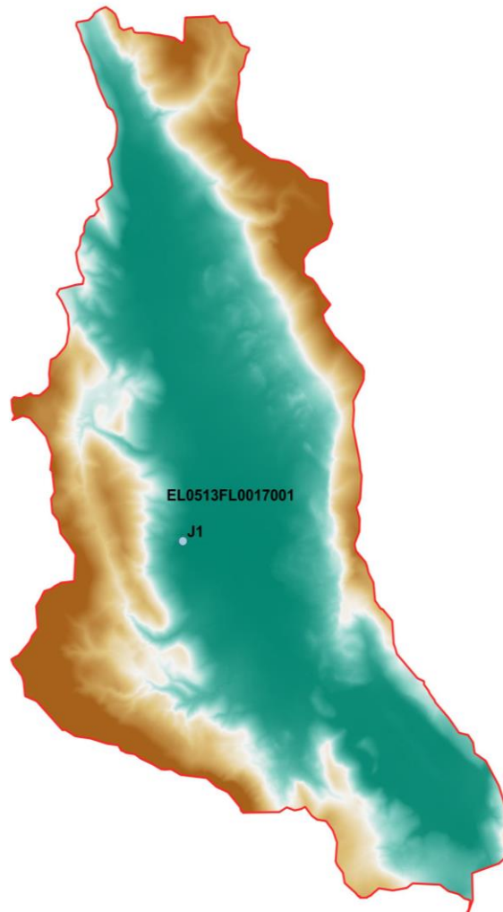
Εικόνα 5-23 Χάρτης περιοχής μελέτης, όπου απεικονίζεται η σχηματοποίηση των κόμβων και κλάδων του υδρογραφικού δικτύου και των υπολεκανών
