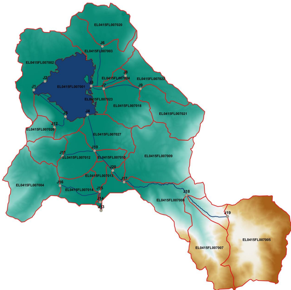
Εικόνα Error! No text of specified style in document.-1 Χάρτης περιοχής μελέτης, στον οποίο απεικονίζεται η σχηματοποίηση των κόμβων και κλάδων του υδρογραφικού δικτύου και των υπολεκανών
