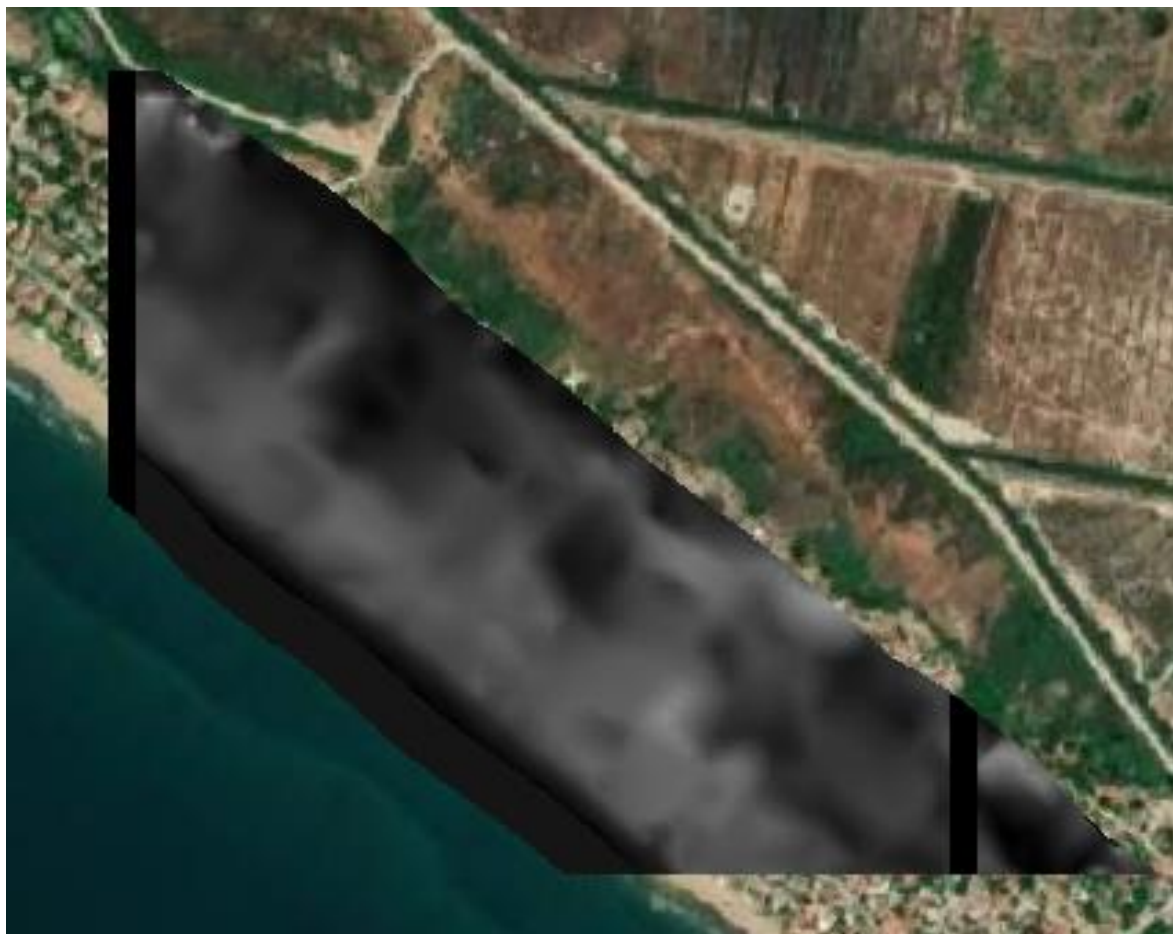
Σχήμα 3.30 : Παράδειγμα αστοχίας του ΨΜΕ στο επικαλυπτόμενο τμήμα διαδοχικών πινακίδων
