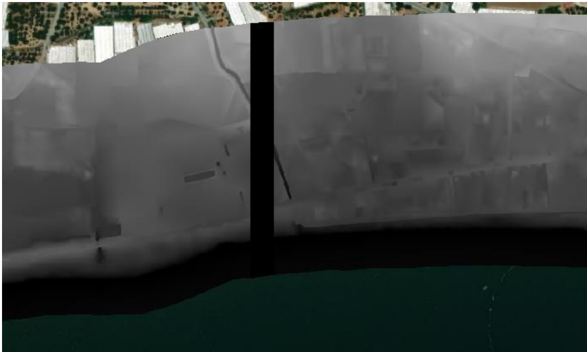
Σχήμα 3.33 : Παράδειγμα αστοχίας του ΨΜΕ στο επικαλυπτόμενο τμήμα διαδοχικών πινακίδων
