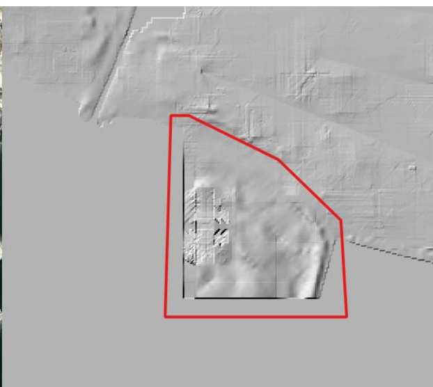
Σχήμα 3.24 : Αστοχία του ΨΜΕ λόγω αυτόματης φωτογραμμετρικής παραγωγής
