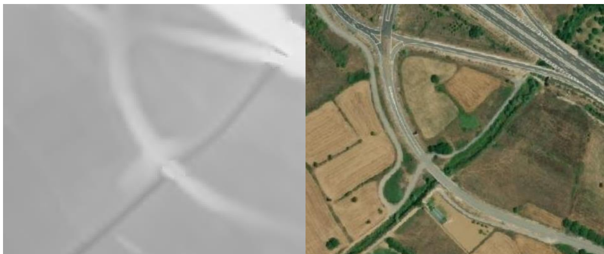
Σχήμα 3.26 : Παράδειγμα αστοχίας του ΨΜΕ - σε σημείο τεχνικού έργου
