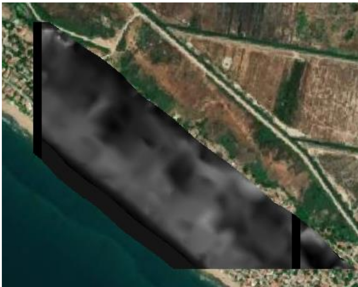
Σχήμα 3.31 : Παράδειγμα αστοχίας του ΨΜΕ στο επικαλυπτόμενο τμήμα διαδοχικών πινακίδων
