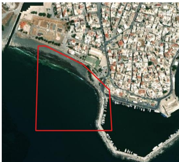
Σχήμα 3.25 : Αστοχία του ΨΜΕ λόγω αυτόματης φωτογραμμετρικής παραγωγής
