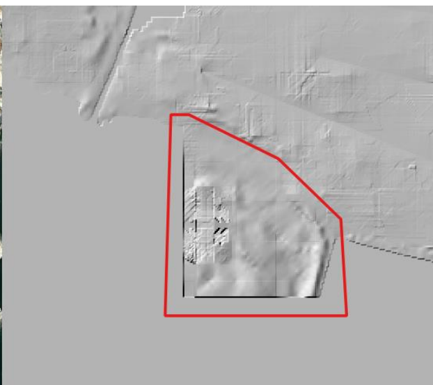
Σχήμα 3.25 : Αστοχία του ΨΜΕ λόγω αυτόματης φωτογραμμετρικής παραγωγής
