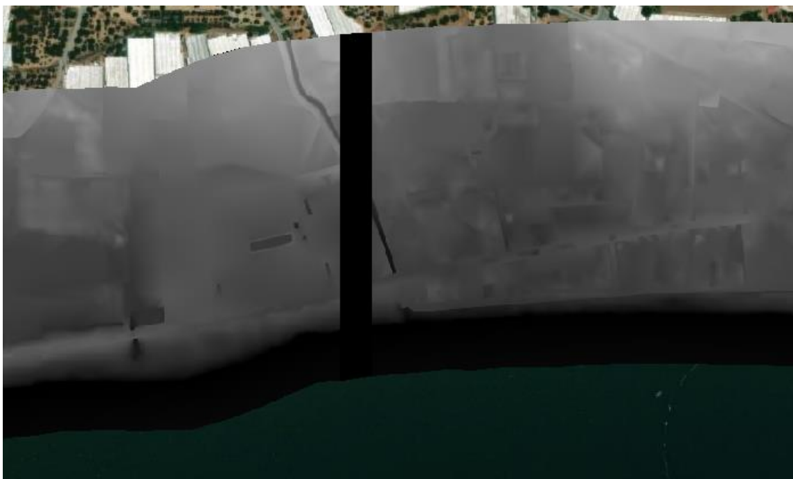
Σχήμα 3.34 : Παράδειγμα αστοχίας του ΨΜΕ στο επικαλυπτόμενο τμήμα διαδοχικών πινακίδων
