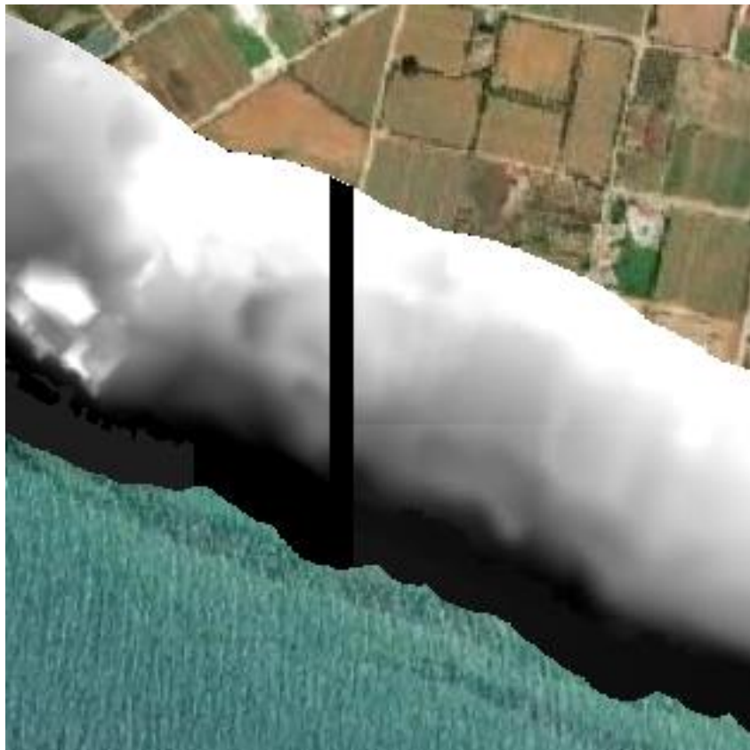
Σχήμα 3.32 : Παράδειγμα αστοχίας του ΨΜΕ στο επικαλυπτόμενο τμήμα διαδοχικών πινακίδων
