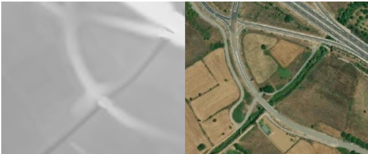
Σχήμα 3.27 : Παράδειγμα αστοχίας του ΨΜΕ - σε σημείο τεχνικού έργου
