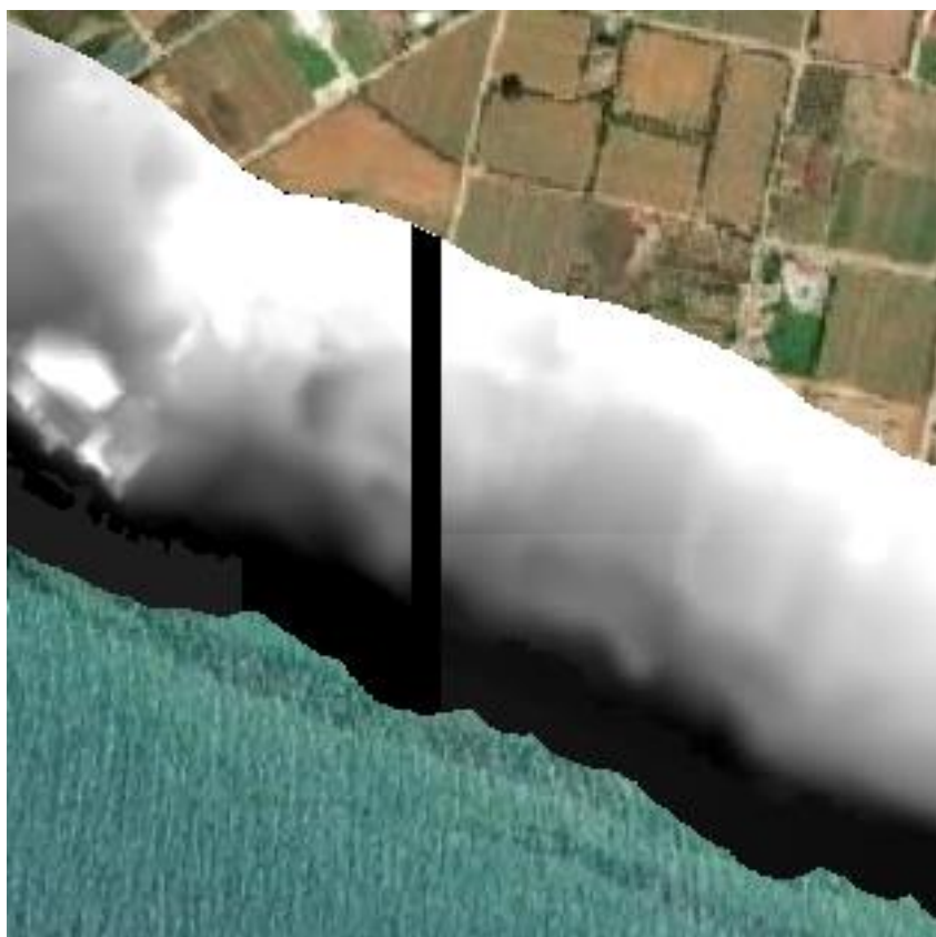
Σχήμα 3.28 : Παράδειγμα αστοχίας του ΨΜΕ στο επικαλυπτόμενο τμήμα διαδοχικών πινακίδων
