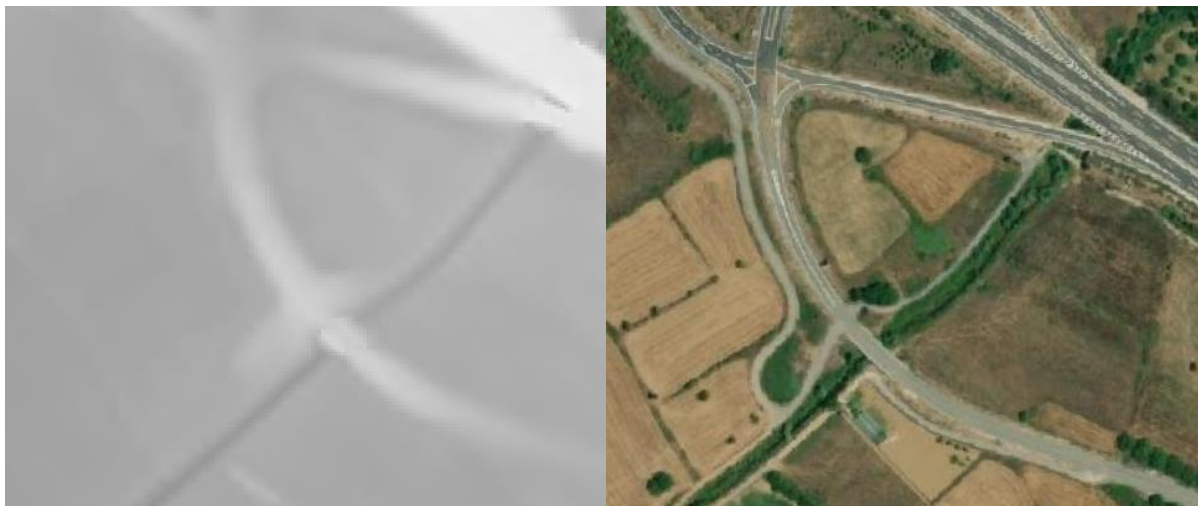
Σχήμα 3.23 : Παράδειγμα αστοχίας του ΨΜΕ - σε σημείο τεχνικού έργου
