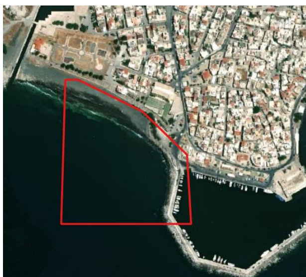
Σχήμα 3.21 : Αστοχία του ΨΜΕ λόγω αυτόματης φωτογραμμετρικής παραγωγής
