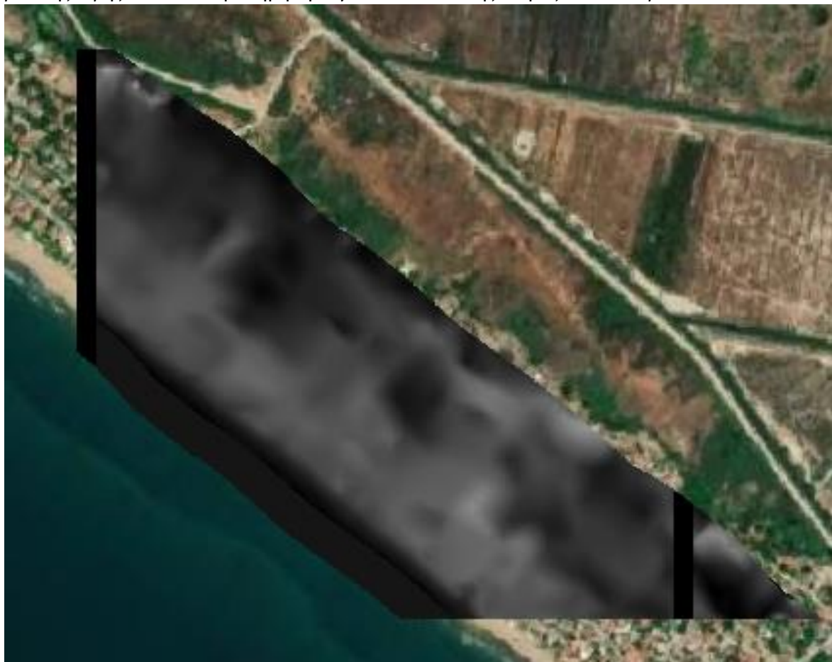
Σχήμα 3.27 : Παράδειγμα αστοχίας του ΨΜΕ στο επικαλυπτόμενο τμήμα διαδοχικών πινακίδων
