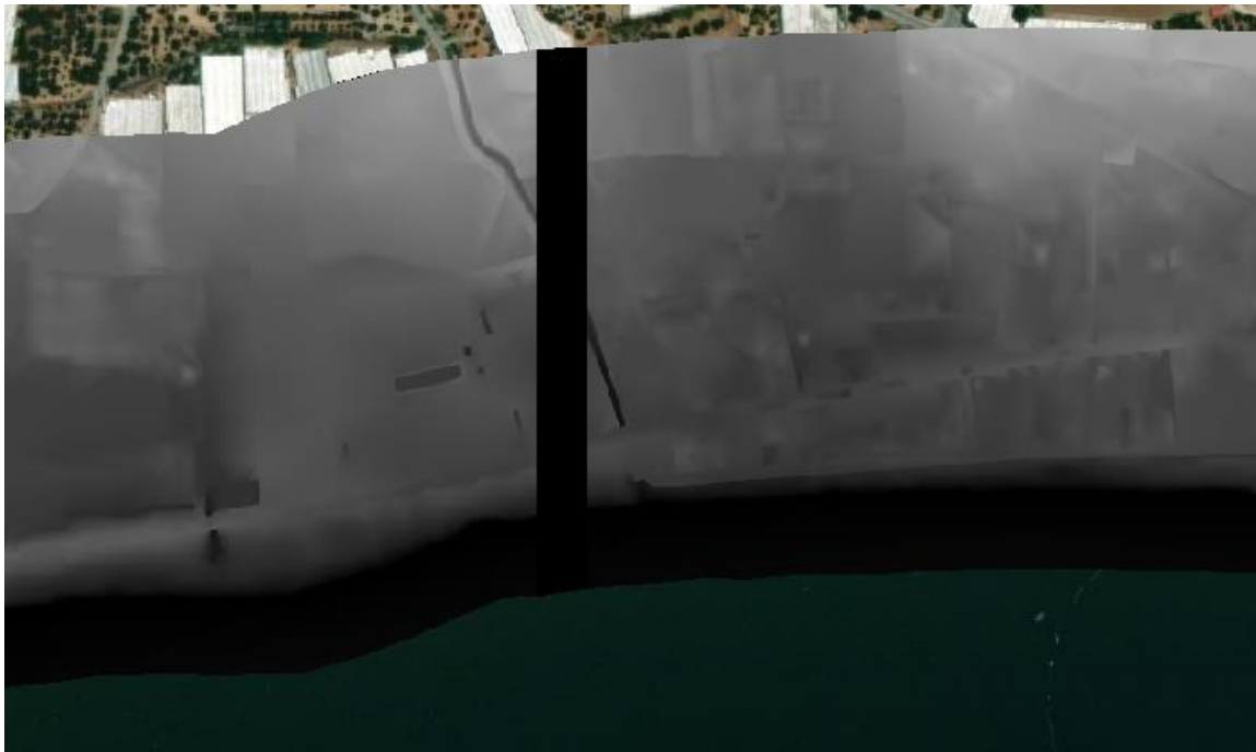
Σχήμα 3.30 : Παράδειγμα αστοχίας του ΨΜΕ στο επικαλυπτόμενο τμήμα διαδοχικών πινακίδων
