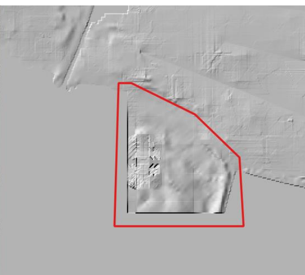
Σχήμα 3.21 : Αστοχία του ΨΜΕ λόγω αυτόματης φωτογραμμετρικής παραγωγής
