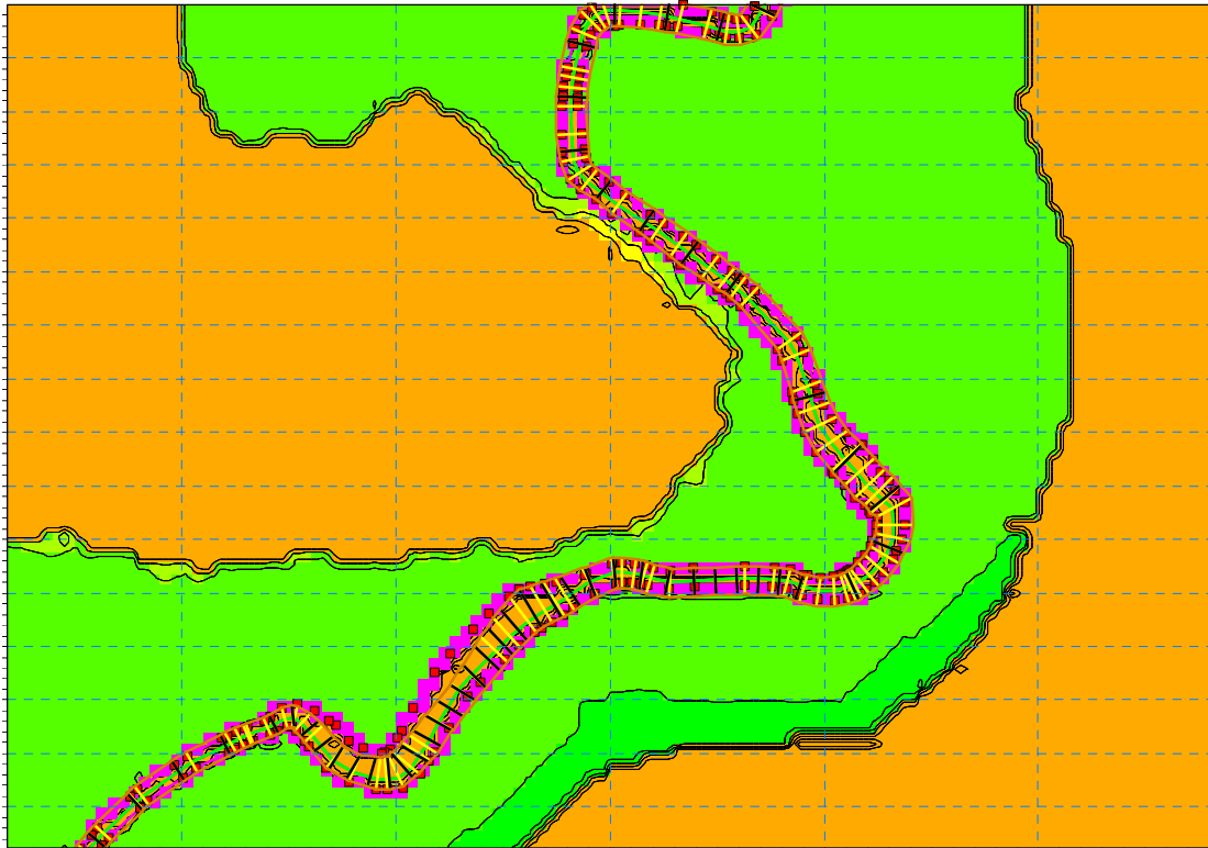
Εικόνα 7.14 Σύνδεση του μονοδιάστατου (MIKE11) και δισδιάστατου (MIKE21) υδραυλικού ομοιώματος στην περιοχή της Γεμιστής
