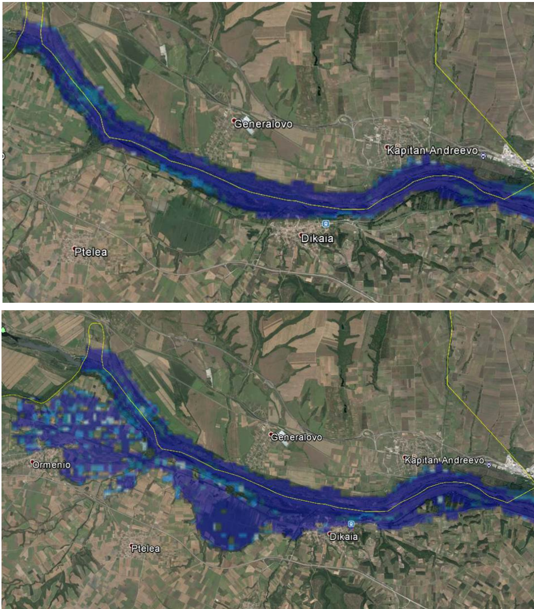
Εικόνα 8.4 Κατάκλυση βόρειου Έβρου, τμήμα Ορμένιο – Δίκαια, σενάρια SclI (πάνω) και SclIII (κάτω)
