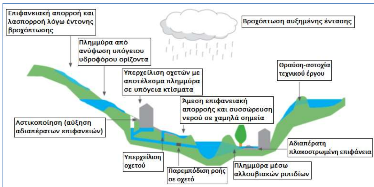
Σχήμα 5.1: Κύρια αίτια και τύποι πλημμυρών.
