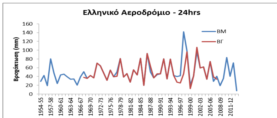
Σχήμα 3.7: Παράδειγμα σύγκρισης δεδομένων βροχογράφου και βροχομέτρου ετήσιων μέγιστων εντάσεων βροχής 24h στο σταθμό Ελληνικό Αεροδρόμιο ΥΔ Αττικής.
