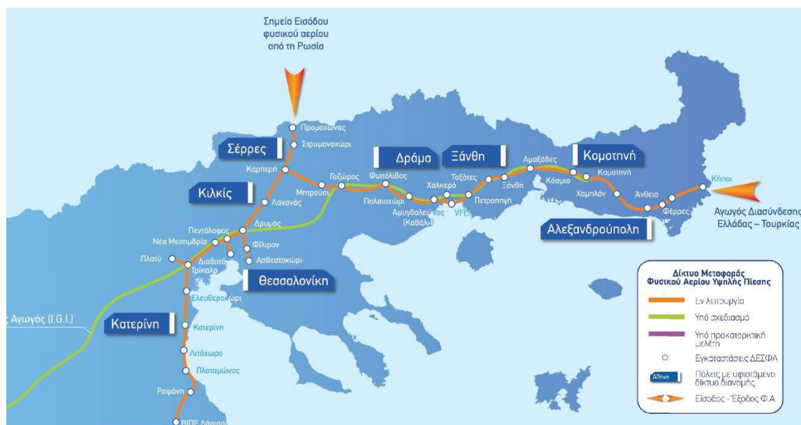
Σχήμα 7.33: Όδευση του κεντρικού αγωγού μεταφοράς φυσικού αερίου
