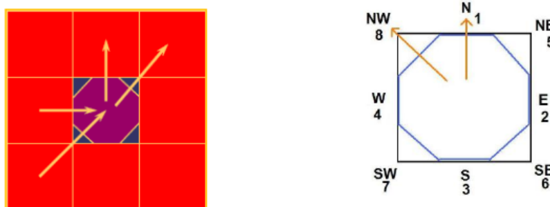
Σχήμα 2.1 : Υπολογισμός ταχύτητας ροής σε κάθε κύτταρο του κανάβου (FLO-2d Software Inc, 2009)
