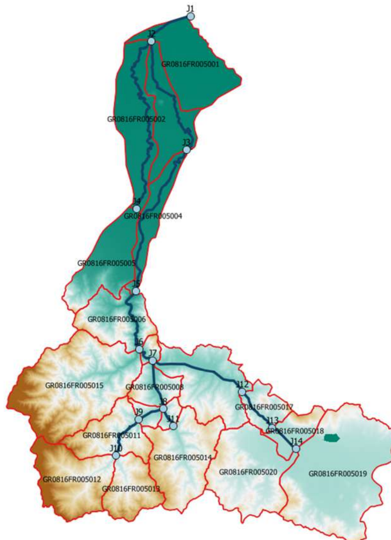
Εικόνα 7.14: Χάρτης περιοχής μελέτης, στον οποίο απεικονίζεται η σχηματοποίηση των κόμβων και κλάδων του υδρογραφικού δικτύου και των υπολεκανών
