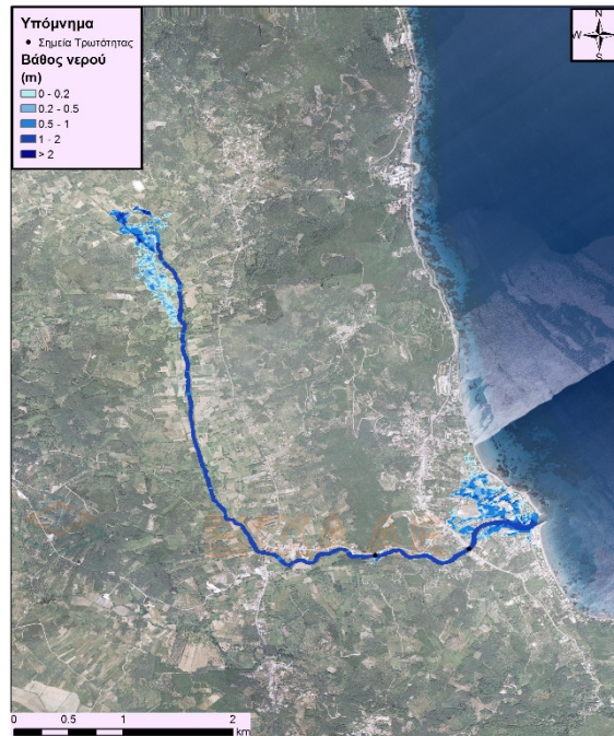
Σχήμα 4.4.2-13: Σχηματική απεικόνιση έκτασης βάθους πλημμύρας του ρ. Μεσανγής για περίοδο επαναφοράς T=50 ετών, μέσες συνθήκες (Σενάριο 4)
