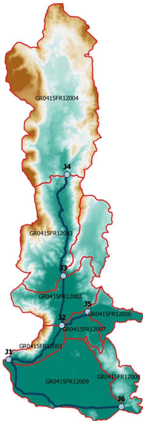
Εικόνα 7.2: Η λεκάνη απορροής του ρέματος Γεροπόρου (με μπλε γραμμή απεικονίζεται το ρέμα του Γεροπόρου, με κόκκινο περίγραμμα οι υπολεκάνες του και με γαλάζιο σημείο οι κόμβοι των υπολεκανών) (πηγή: Υδρολογική ανάλυση)
