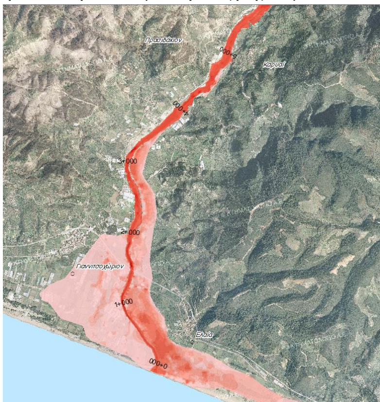
Σχήμα 5.9: Σχηματική απεικόνιση αποτελεσμάτων ταχύτητας του μοντέλου διάδευσης πλημμύρας
