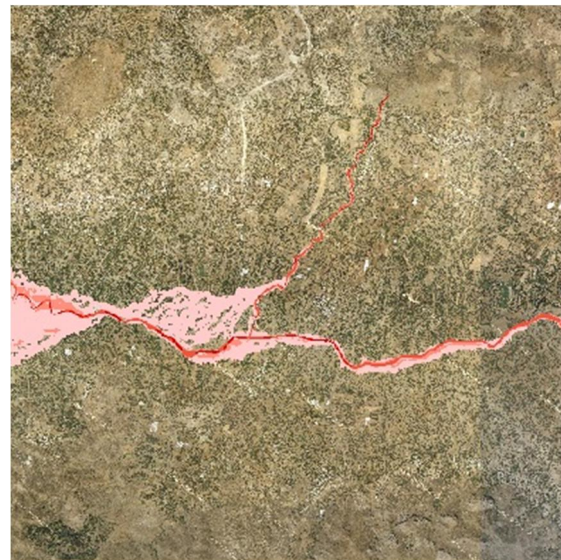
Σχήμα 3.26: Σχηματική απεικόνιση έκτασης - βάθους και ταχυτήτων ροής πλημμύρας του ρ. Λιθαίου με περίοδο επαναφοράς T=50 ετών για μη μόνιμη ροή (MIKE FLOOD).
