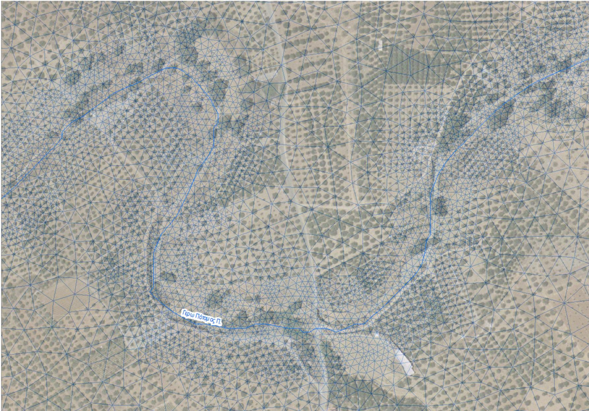
Σχήμα 2.24: Σχηματική απεικόνιση μοντελοποίησης στο MIKE με τριγωνικά πεπερασμένα στοιχεία σε περιοχή εντός και εκτός κοίτης του ποταμού (π. Γερωπόταμος).
