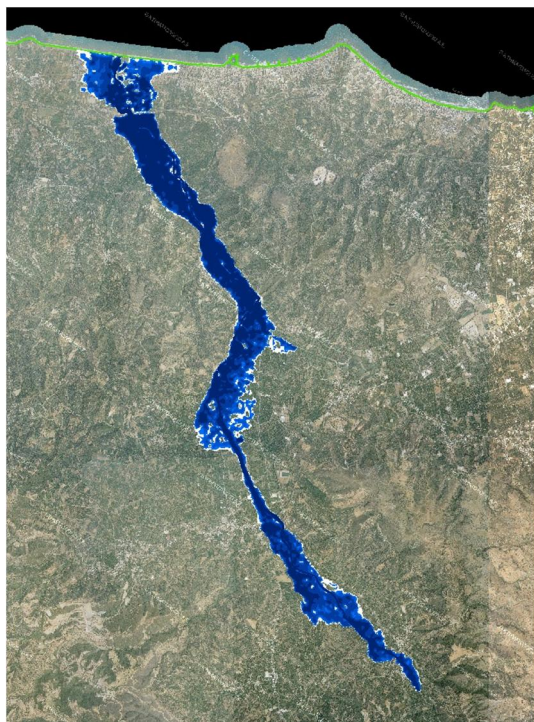
Σχήμα 3.97: Σχηματική απεικόνιση έκτασης - βάθους και ταχυτήτων ροής πλημμύρας του π. Πλατανιά με περίοδο επαναφοράς T=100 ετών για μη μόνιμη ροή (MIKE FLOOD).
