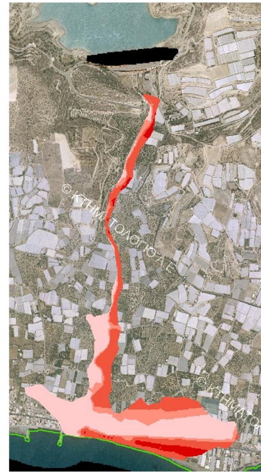
Σχήμα 3.11: Σχηματική απεικόνιση έκτασης - βάθους και ταχυτήτων ροής πλημμύρας του π. Μπραμιανού με περίοδο επαναφοράς T=50 ετών για μη μόνιμη ροή (HEC-RAS).
