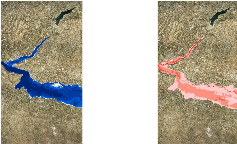
Σχήμα 3.33: Σχηματική απεικόνιση έκτασης - βάθους και ταχυτήτων ροής πλημμύρας του ρ. Κουτσουλίδη με περίοδο επαναφοράς T=1000 ετών για μη μόνιμη ροή (MIKE FLOOD).
