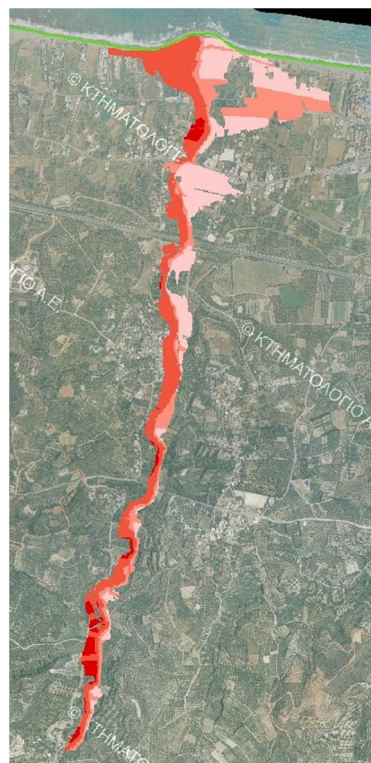
Σχήμα 3.78: Σχηματική απεικόνιση έκτασης - βάθους και ταχυτήτων ροής πλημμύρας του ρ. Σπήλιος με περίοδο επαναφοράς T=1000 ετών για μη μόνιμη ροή (HEC-RAS).
