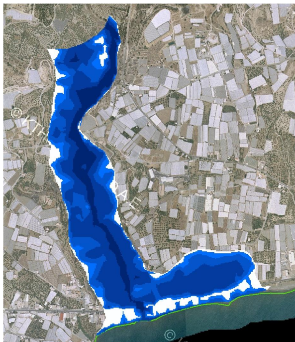
Σχήμα 3.8: Σχηματική απεικόνιση έκτασης - βάθους και ταχυτήτων ροής πλημμύρας του ρ. Καλαμαουκιανού με περίοδο επαναφοράς T=1000 ετών για μη μόνιμη ροή (HEC-RAS).
