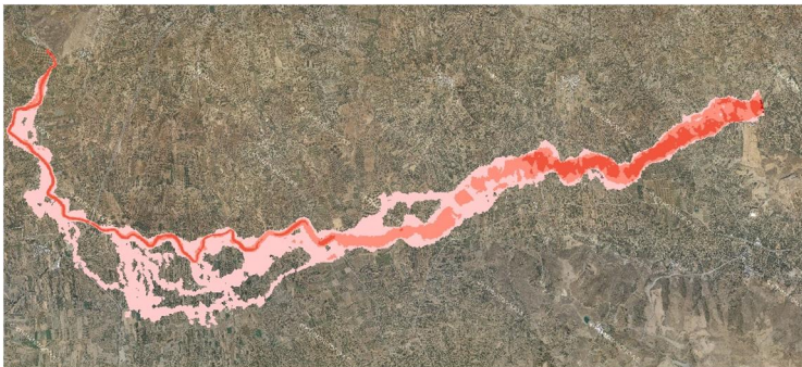
Σχήμα 3.22: Σχηματική απεικόνιση έκτασης - βάθους και ταχυτήτων ροής πλημμύρας του π. Αναποδάρης με περίοδο επαναφοράς T=100 ετών για μη μόνιμη ροή (MIKE FLOOD).
