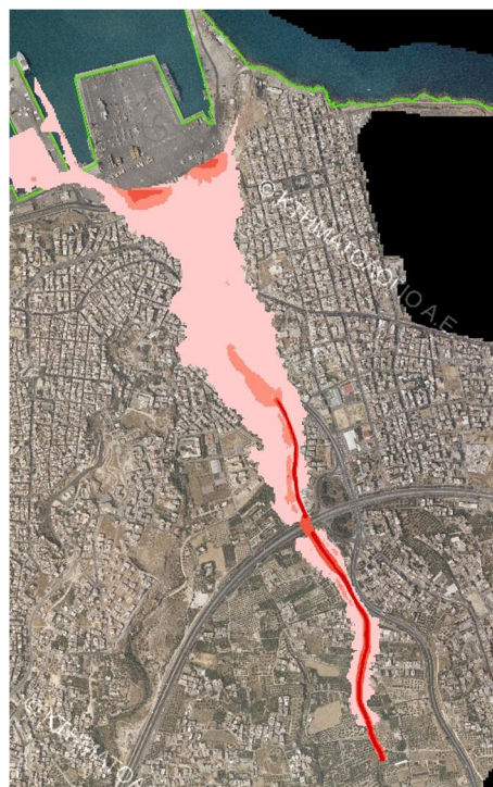
Σχήμα 3.68: Σχηματική απεικόνιση έκτασης - βάθους και ταχυτήτων ροής πλημμύρας του ρ. Κατσαμπαδιανού με περίοδο επαναφοράς T=1000 ετών για μη μόνιμη ροή (MIKE FLOOD).
