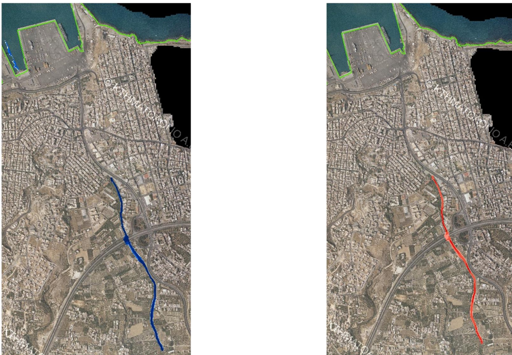
Σχήμα 3.66: Σχηματική απεικόνιση έκτασης - βάθους και ταχυτήτων ροής πλημμύρας του ρ. Κατσαμπαδιανού με περίοδο επαναφοράς T=50 ετών για μη μόνιμη ροή (MIKE FLOOD).
