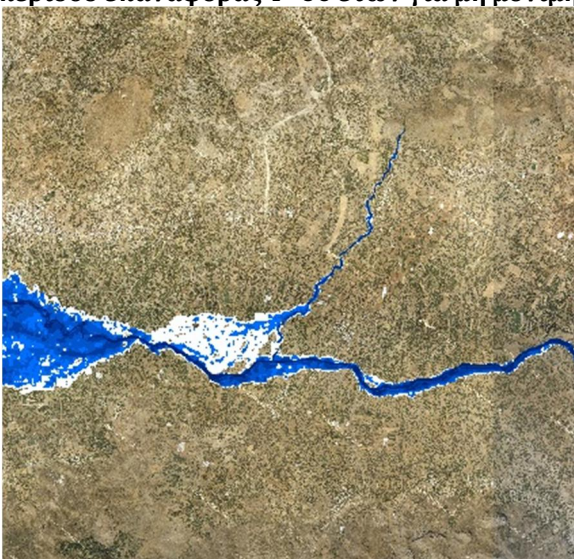
Σχήμα 3.27: Σχηματική απεικόνιση έκτασης - βάθους και ταχυτήτων ροής πλημμύρας του ρ. Λιθαίου με περίοδο επαναφοράς T=100 ετών για μη μόνιμη ροή (MIKE FLOOD).
