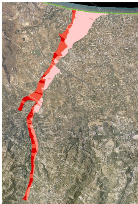
Σχήμα 3.52: Σχηματική απεικόνιση έκτασης - βάθους και ταχυτήτων ροής πλημμύρας του ρ. Γαζανός με περίοδο επαναφοράς T=100 ετών για μη μόνιμη ροή (HEC-RAS).
