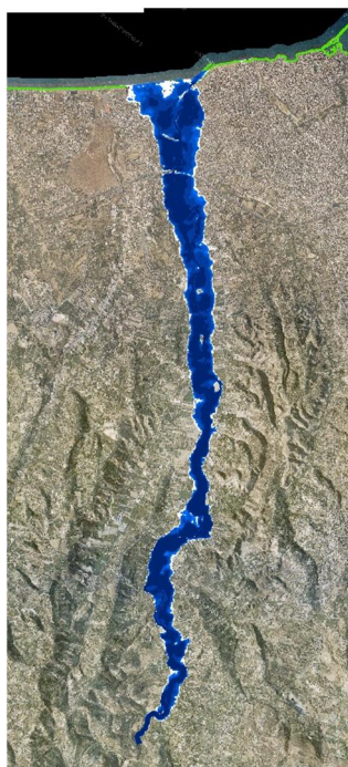
Σχήμα 3.57: Σχηματική απεικόνιση έκτασης - βάθους και ταχυτήτων ροής πλημμύρας του ρ. Γιόφυρου με περίοδο επαναφοράς T=100 ετών για μη μόνιμη ροή (MIKE FLOOD).
