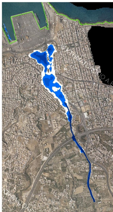
Σχήμα 3.67: Σχηματική απεικόνιση έκτασης - βάθους και ταχυτήτων ροής πλημμύρας του ρ. Κατσαμπαδιανού με περίοδο επαναφοράς T=100 ετών για μη μόνιμη ροή (MIKE FLOOD).
