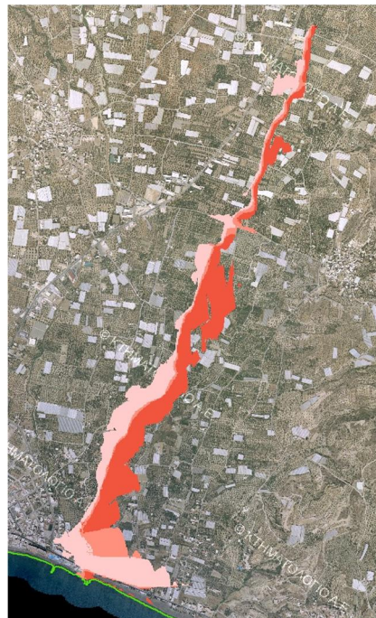
Σχήμα 3.17: Σχηματική απεικόνιση έκτασης - βάθους και ταχυτήτων ροής πλημμύρας του ρ. Κοτοβιανού με περίοδο επαναφοράς T=100 ετών για μη μόνιμη ροή (HEC-RAS).
