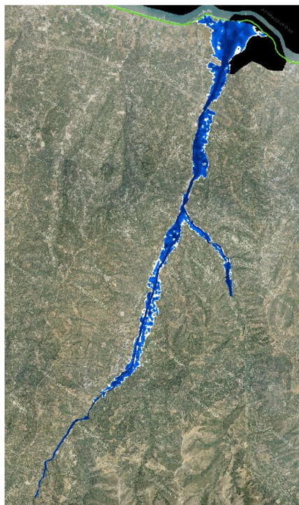
Σχήμα 3.87: Σχηματική απεικόνιση έκτασης - βάθους και ταχυτήτων ροής πλημμύρας του π. Ταυρωνίτη με περίοδο επαναφοράς T=100 ετών για μη μόνιμη ροή (MIKE FLOOD).
