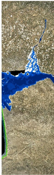
Σχήμα 3.38: Σχηματική απεικόνιση έκτασης - βάθους και ταχυτήτων ροής πλημμύρας του ρ. Μαγείρου με περίοδο επαναφοράς T=1000 ετών για μη μόνιμη ροή (MIKE FLOOD).
