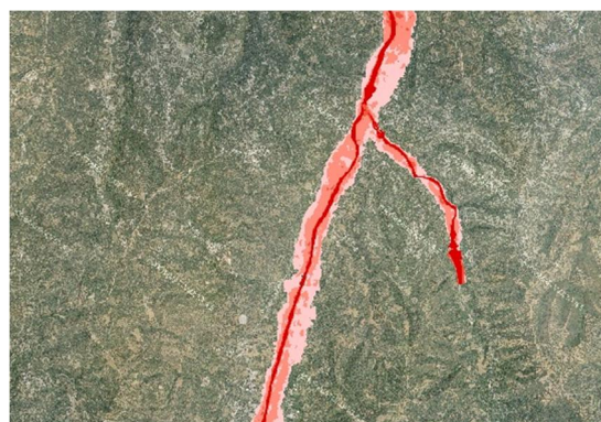
Σχήμα 3.93: Σχηματική απεικόνιση έκτασης - βάθους και ταχυτήτων ροής πλημμύρας του ρ. Ντεριανού με περίοδο επαναφοράς T=1000 ετών για μη μόνιμη ροή (MIKE FLOOD).
