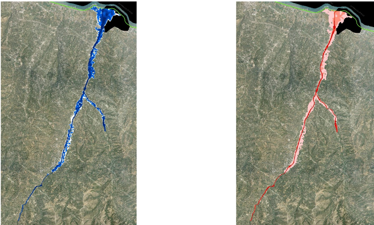
Σχήμα 3.86: Σχηματική απεικόνιση έκτασης - βάθους και ταχυτήτων ροής πλημμύρας του π. Ταυρωνίτη με περίοδο επαναφοράς T=50 ετών για μη μόνιμη ροή (MIKE FLOOD).
