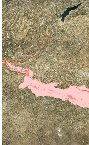
Σχήμα 3.31: Σχηματική απεικόνιση έκτασης - βάθους και ταχυτήτων ροής πλημμύρας του ρ. Κουτσουλίδη με περίοδο επαναφοράς T=50 ετών για μη μόνιμη ροή (MIKE FLOOD).
