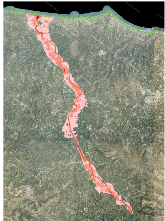
Σχήμα 3.96: Σχηματική απεικόνιση έκτασης - βάθους και ταχυτήτων ροής πλημμύρας του π. Πλατανιά με περίοδο επαναφοράς T=50 ετών για μη μόνιμη ροή (MIKE FLOOD).
