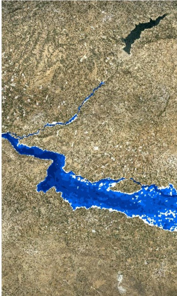
Σχήμα 3.31: Σχηματική απεικόνιση έκτασης - βάθους και ταχυτήτων ροής πλημμύρας του ρ. Κουτσουλίδη με περίοδο επαναφοράς T=50 ετών για μη μόνιμη ροή (MIKE FLOOD).
