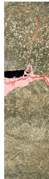
Σχήμα 3.36: Σχηματική απεικόνιση έκτασης - βάθους και ταχυτήτων ροής πλημμύρας του ρ. Μαγείρου με περίοδο επαναφοράς T=50 ετών για μη μόνιμη ροή (MIKE FLOOD).
