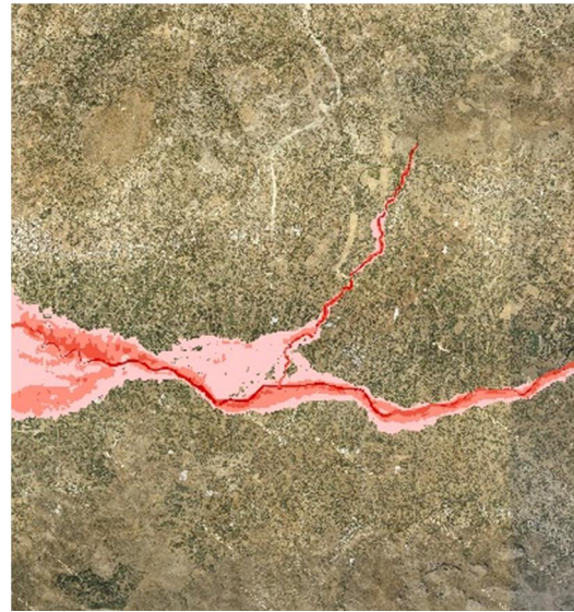
Σχήμα 3.28: Σχηματική απεικόνιση έκτασης - βάθους και ταχυτήτων ροής πλημμύρας του ρ. Λιθαίου με περίοδο επαναφοράς T=1000 ετών για μη μόνιμη ροή (MIKE FLOOD).
