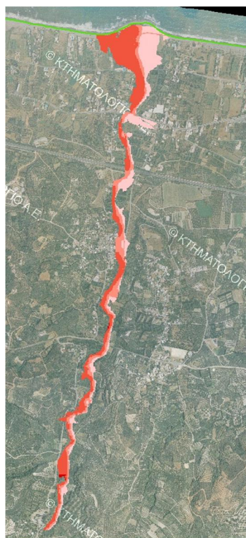
Σχήμα 3.77: Σχηματική απεικόνιση έκτασης - βάθους και ταχυτήτων ροής πλημμύρας του ρ. Σπήλιος με περίοδο επαναφοράς T=100 ετών για μη μόνιμη ροή (HEC-RAS).
