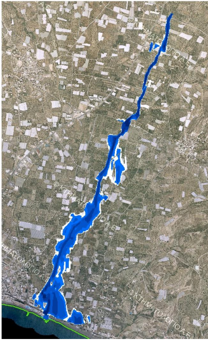
Σχήμα 3.16: Σχηματική απεικόνιση έκτασης - βάθους και ταχυτήτων ροής πλημμύρας του ρ. Κοτοβιανού με περίοδο επαναφοράς T=50 ετών για μη μόνιμη ροή (HEC-RAS).
