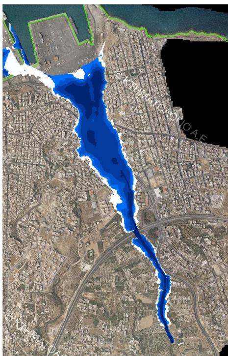
Σχήμα 3.68: Σχηματική απεικόνιση έκτασης - βάθους και ταχυτήτων ροής πλημμύρας του ρ. Κατσαμπαδιανού με περίοδο επαναφοράς T=1000 ετών για μη μόνιμη ροή (MIKE FLOOD).
