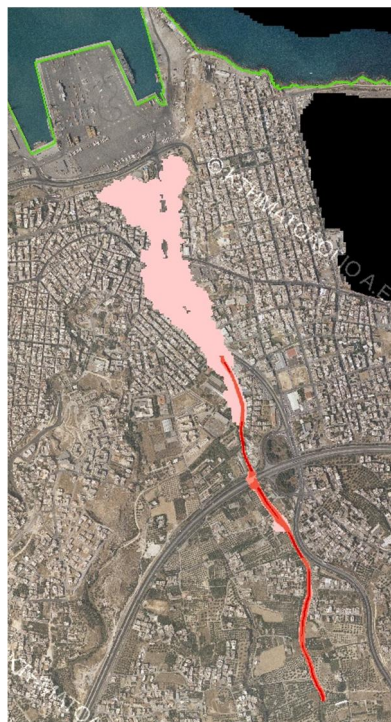
Σχήμα 3.67: Σχηματική απεικόνιση έκτασης - βάθους και ταχυτήτων ροής πλημμύρας του ρ. Κατσαμπαδιανού με περίοδο επαναφοράς T=100 ετών για μη μόνιμη ροή (MIKE FLOOD).
