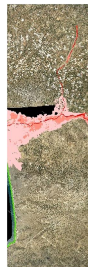
Σχήμα 3.37: Σχηματική απεικόνιση έκτασης - βάθους και ταχυτήτων ροής πλημμύρας του ρ. Μαγείρου με περίοδο επαναφοράς T=100 ετών για μη μόνιμη ροή (MIKE FLOOD).
