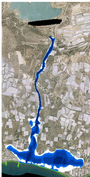
Σχήμα 3.12: Σχηματική απεικόνιση έκτασης - βάθους και ταχυτήτων ροής πλημμύρας του π. Μπραμιανού με περίοδο επαναφοράς T=100 ετών για μη μόνιμη ροή (HEC-RAS).
