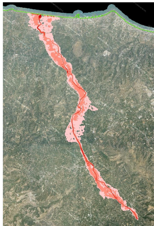
Σχήμα 3.97: Σχηματική απεικόνιση έκτασης - βάθους και ταχυτήτων ροής πλημμύρας του π. Πλατανιά με περίοδο επαναφοράς T=100 ετών για μη μόνιμη ροή (MIKE FLOOD).
