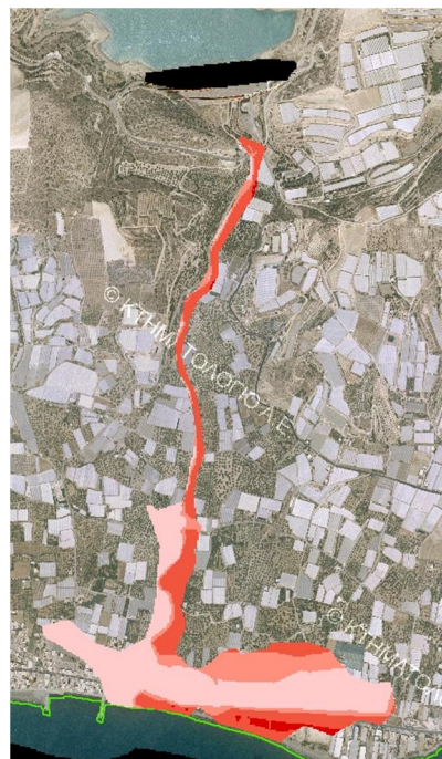
Σχήμα 3.12: Σχηματική απεικόνιση έκτασης - βάθους και ταχυτήτων ροής πλημμύρας του π. Μπραμιανού με περίοδο επαναφοράς T=100 ετών για μη μόνιμη ροή (HEC-RAS).
