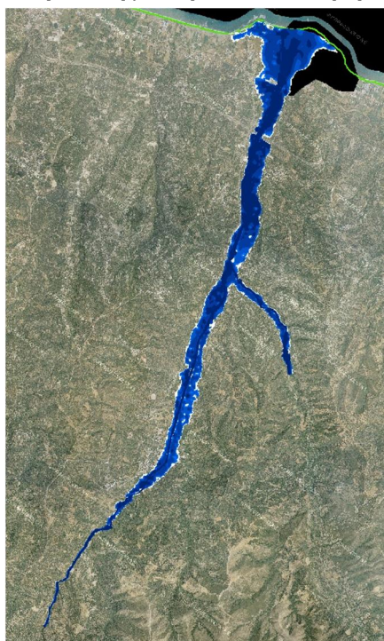
Σχήμα 3.87: Σχηματική απεικόνιση έκτασης - βάθους και ταχυτήτων ροής πλημμύρας του π. Ταυρωνίτη με περίοδο επαναφοράς T=100 ετών για μη μόνιμη ροή (MIKE FLOOD).
