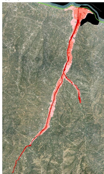
Σχήμα 3.87: Σχηματική απεικόνιση έκτασης - βάθους και ταχυτήτων ροής πλημμύρας του π. Ταυρωνίτη με περίοδο επαναφοράς T=100 ετών για μη μόνιμη ροή (MIKE FLOOD).
