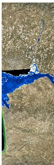
Σχήμα 3.37: Σχηματική απεικόνιση έκτασης - βάθους και ταχυτήτων ροής πλημμύρας του ρ. Μαγείρου με περίοδο επαναφοράς T=100 ετών για μη μόνιμη ροή (MIKE FLOOD).
