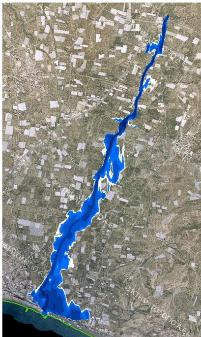
Σχήμα 3.17: Σχηματική απεικόνιση έκτασης - βάθους και ταχυτήτων ροής πλημμύρας του ρ. Κοτοβιανού με περίοδο επαναφοράς T=100 ετών για μη μόνιμη ροή (HEC-RAS).
