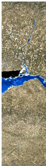
Σχήμα 3.36: Σχηματική απεικόνιση έκτασης - βάθους και ταχυτήτων ροής πλημμύρας του ρ. Μαγείρου με περίοδο επαναφοράς T=50 ετών για μη μόνιμη ροή (MIKE FLOOD).
