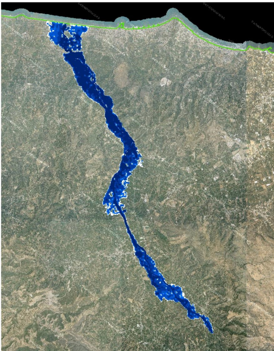
Σχήμα 3.96: Σχηματική απεικόνιση έκτασης - βάθους και ταχυτήτων ροής πλημμύρας του π. Πλατανιά με περίοδο επαναφοράς T=50 ετών για μη μόνιμη ροή (MIKE FLOOD).
