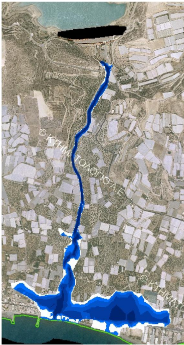
Σχήμα 3.11: Σχηματική απεικόνιση έκτασης - βάθους και ταχυτήτων ροής πλημμύρας του π. Μπραμιανού με περίοδο επαναφοράς T=50 ετών για μη μόνιμη ροή (HEC-RAS).
