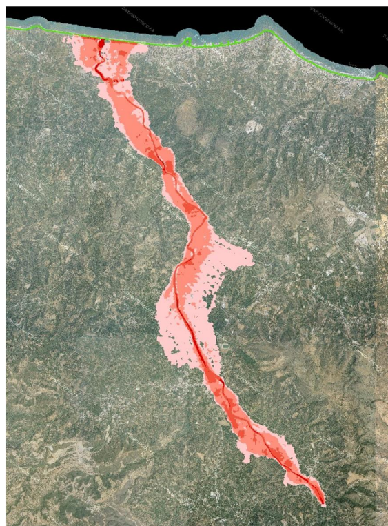
Σχήμα 3.97: Σχηματική απεικόνιση έκτασης - βάθους και ταχυτήτων ροής πλημμύρας του π. Πλατανιά με περίοδο επαναφοράς T=100 ετών για μη μόνιμη ροή (MIKE FLOOD).
