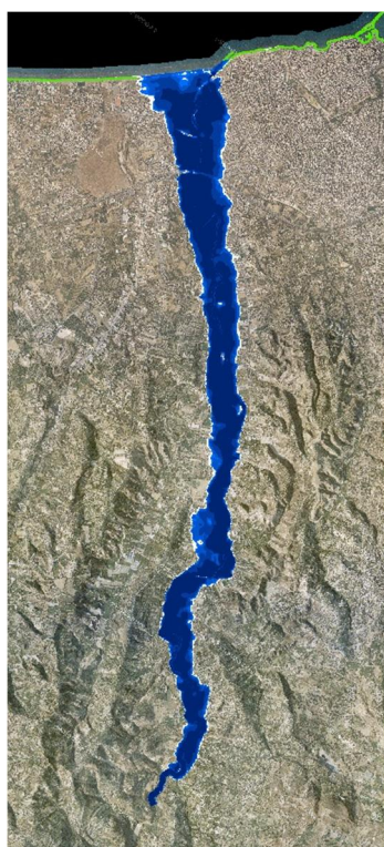
Σχήμα 3.58: Σχηματική απεικόνιση έκτασης - βάθους και ταχυτήτων ροής πλημμύρας του ρ. Γιόφυρου με περίοδο επαναφοράς T=1000 ετών για μη μόνιμη ροή (MIKE FLOOD).
