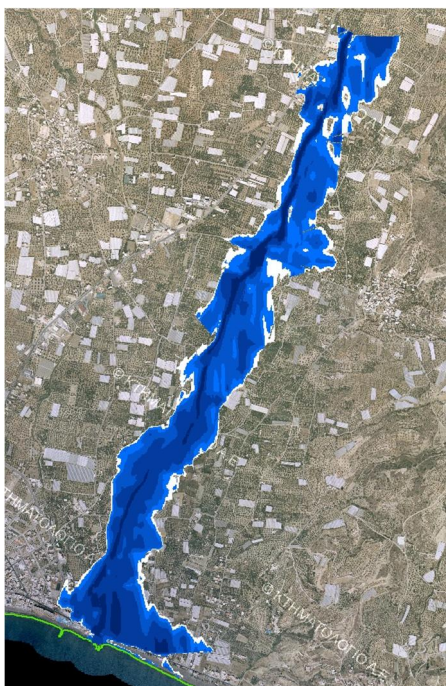
Σχήμα 3.18: Σχηματική απεικόνιση έκτασης - βάθους και ταχυτήτων ροής πλημμύρας του ρ. Κοτοβιανού με περίοδο επαναφοράς T=1000 ετών για μη μόνιμη ροή (HEC-RAS).
