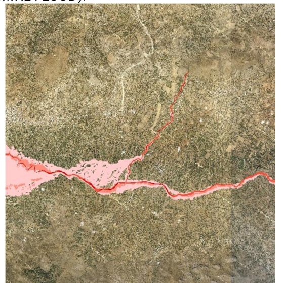
Σχήμα 3.27: Σχηματική απεικόνιση έκτασης - βάθους και ταχυτήτων ροής πλημμύρας του ρ. Λιθαίου με περίοδο επαναφοράς T=100 ετών για μη μόνιμη ροή (MIKE FLOOD).
