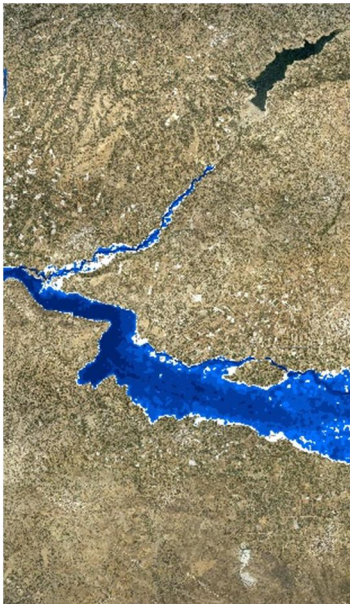
Σχήμα 3.32: Σχηματική απεικόνιση έκτασης - βάθους και ταχυτήτων ροής πλημμύρας του ρ. Κουτσουλίδη με περίοδο επαναφοράς T=100 ετών για μη μόνιμη ροή (MIKE FLOOD).
