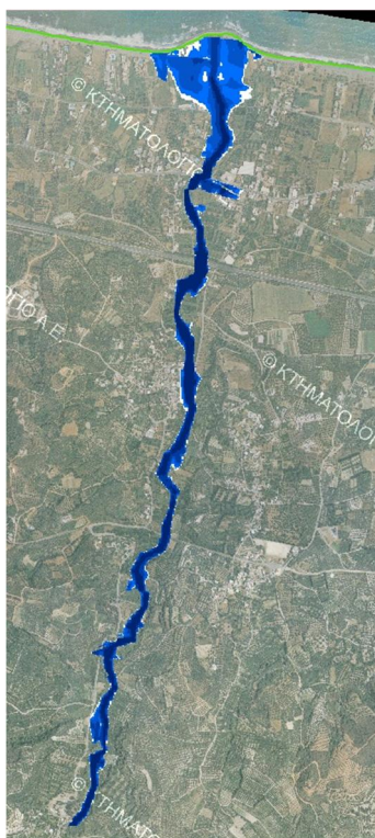
Σχήμα 3.77: Σχηματική απεικόνιση έκτασης - βάθους και ταχυτήτων ροής πλημμύρας του ρ. Σπήλιος με περίοδο επαναφοράς T=100 ετών για μη μόνιμη ροή (HEC-RAS).
