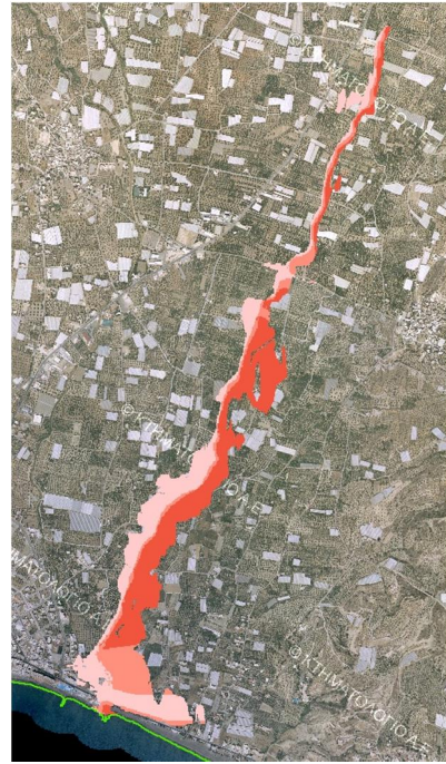
Σχήμα 3.16: Σχηματική απεικόνιση έκτασης - βάθους και ταχυτήτων ροής πλημμύρας του ρ. Κοτοβιανού με περίοδο επαναφοράς T=50 ετών για μη μόνιμη ροή (HEC-RAS).
