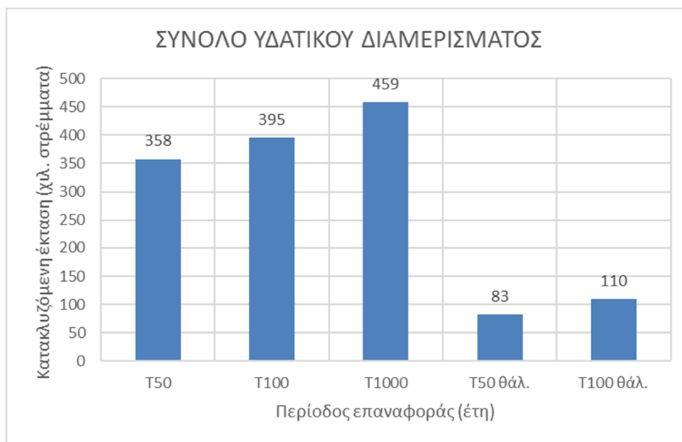
Εικόνα 3.1: Κατακλυζόμενες εκτάσεις για τις πλημμύρες περιόδου επαναφοράς 50, 100 και 1.000 ετών καθώς και για τις θαλάσσιες πλημμύρες περιόδου επαναφοράς 50 και 100 ετών
