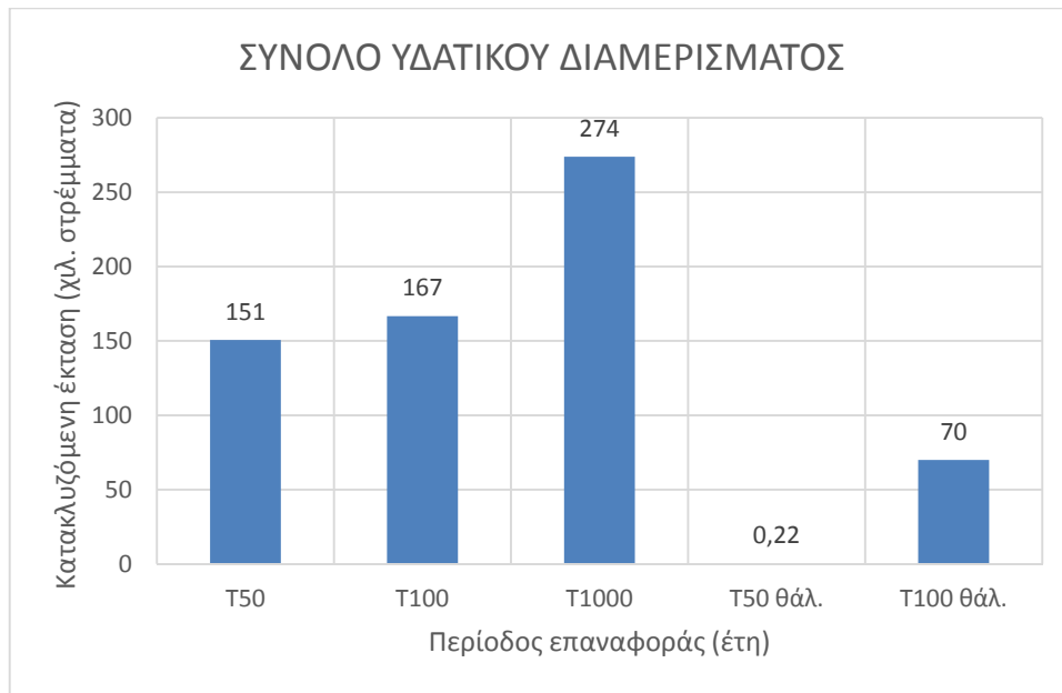
Σχήμα 1.2.3-1: Κατακλυζόμενες εκτάσεις στο ΥΔ Δυτικής Στερεάς Ελλάδας (EL04) για τις πλημμύρες περιόδου επαναφοράς 50, 100 και 1 000 ετών καθώς και για τις θαλάσσιες πλημμύρες περιόδου επαναφοράς 50 και 100 ετών
