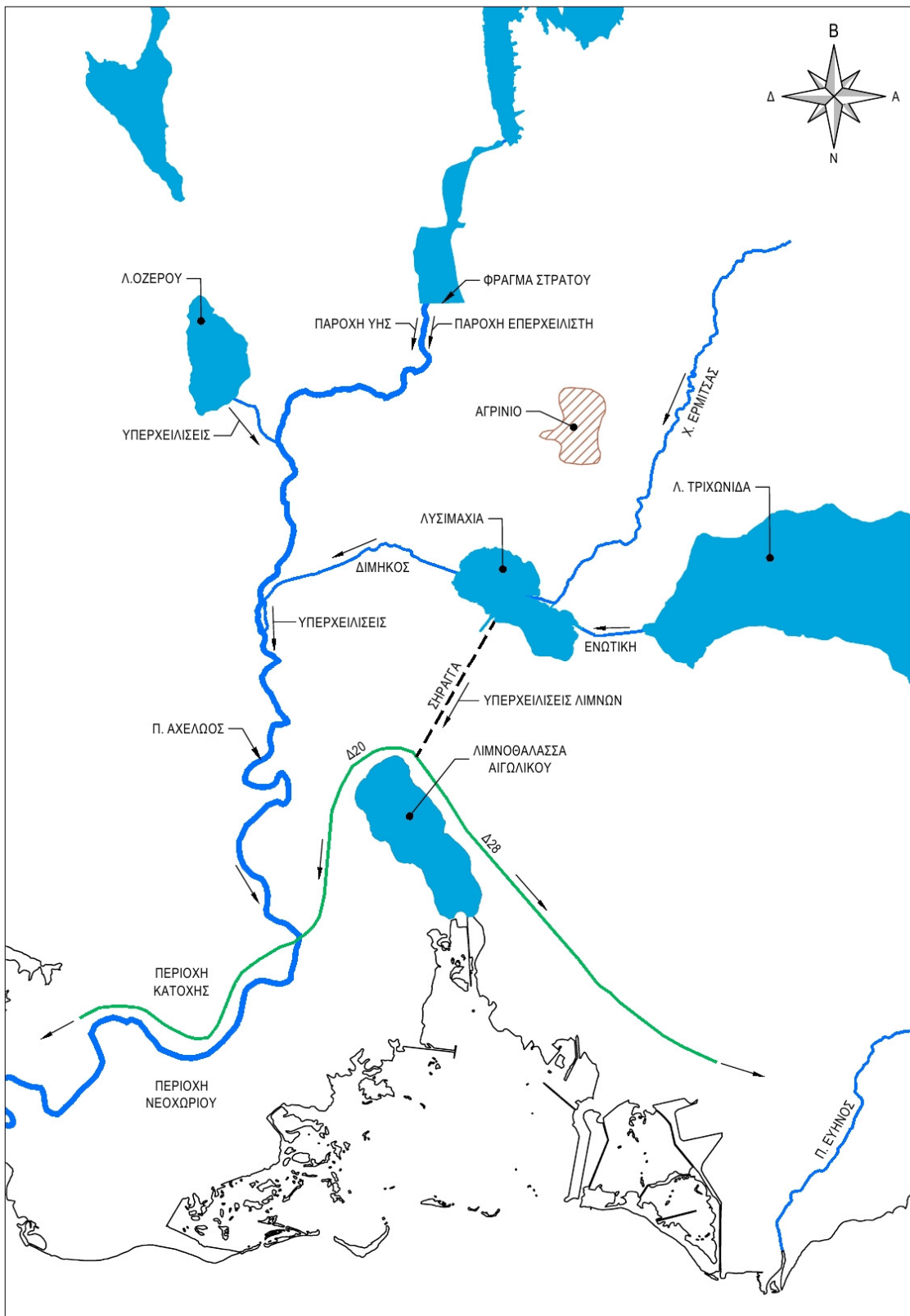
Σχ. 5-10: Σύστημα Κ. Αχελώου - Μηχανισμοί Πλημμύρας
