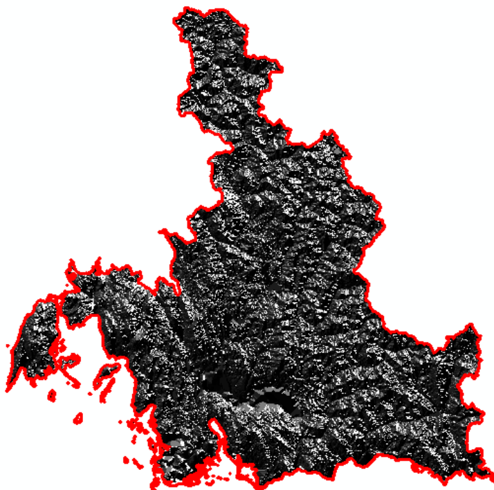
Σχ. 4-10: Grid κατεύθυνσης ροής ΥΔ Δυτικής Στερεάς Ελλάδας (GR04)
