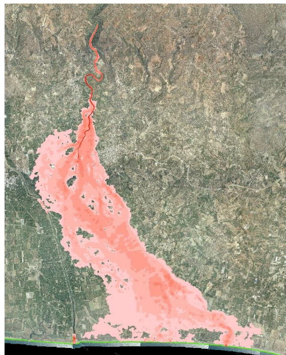
Σχήμα 3.17: Σχηματική απεικόνιση έκτασης - βάθους και ταχυτήτων ροής πλημμύρας του ρ. Μαριόρρεμα με περίοδο επαναφοράς T=100 ετών για μη μόνιμη ροή (MIKE FLOOD).
