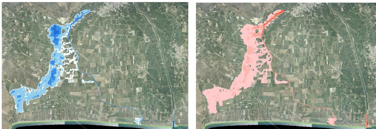
Σχήμα 3.7: Σχηματική απεικόνιση έκτασης - βάθους και ταχυτήτων ροής πλημμύρας του ρ. Βασιλοπόταμου με περίοδο επαναφοράς T=100 ετών για μη μόνιμη ροή (MIKE FLOOD).
