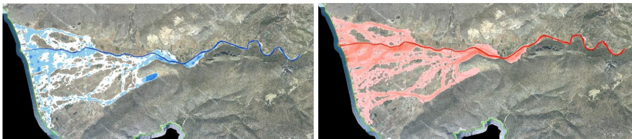
Σχήμα 3.50: Σχηματική απεικόνιση έκτασης - βάθους και ταχυτήτων ροής πλημμύρας του π. Ράδου με περίοδο επαναφοράς T=50 ετών για μη μόνιμη ροή (MIKE FLOOD).
