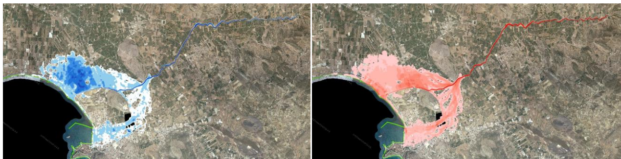
Σχήμα 3.89: Σχηματική απεικόνιση έκτασης - βάθους και ταχυτήτων ροής πλημμύρας του ρ. Μεγάλο Ρέμα με περίοδο επαναφοράς T=1000 ετών για μη μόνιμη ροή (MIKE FLOOD).
