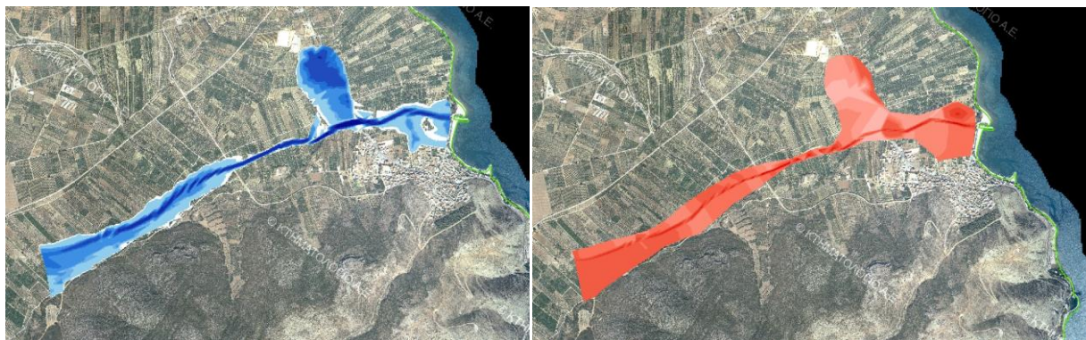
Σχήμα 3.58: Σχηματική απεικόνιση έκτασης - βάθους και ταχυτήτων ροής πλημμύρας του ρ. Ξοβριό με περίοδο επαναφοράς T=50 ετών για μη μόνιμη ροή (HEC-RAS).
