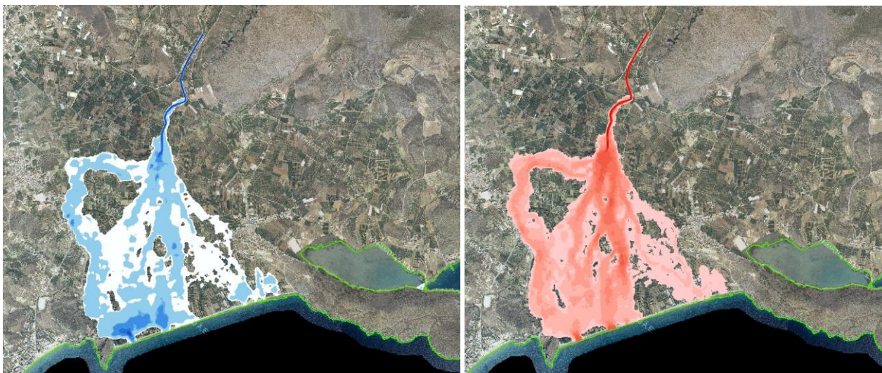
Σχήμα 3.84: Σχηματική απεικόνιση έκτασης - βάθους και ταχυτήτων ροής πλημμύρας του ρ. Δαφνόρρεμα με περίοδο επαναφοράς T=50 ετών για μη μόνιμη ροή (MIKE FLOOD).
