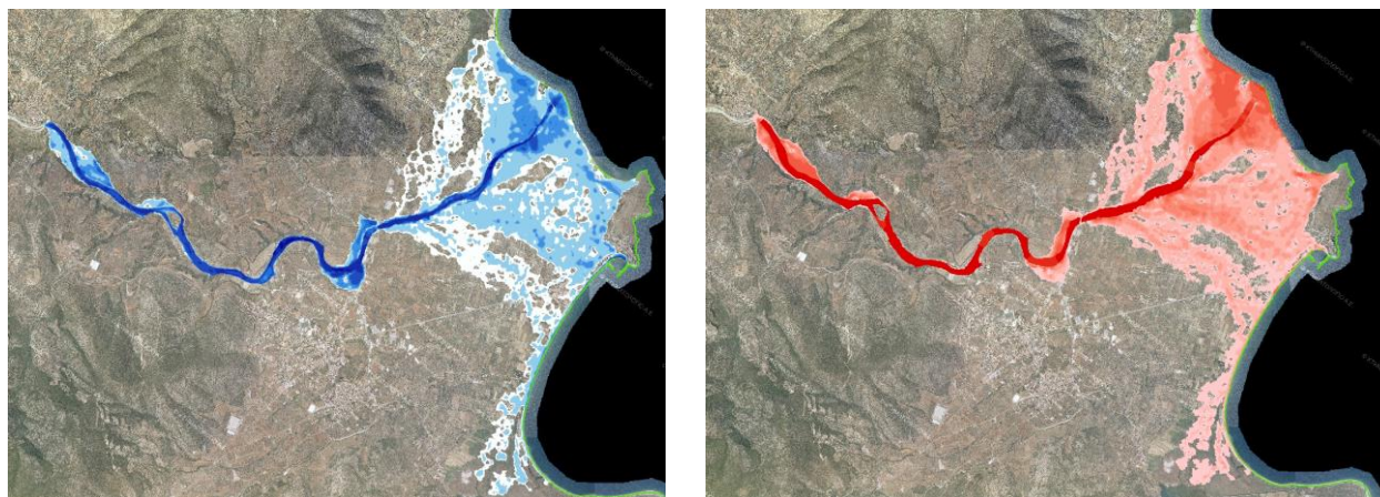
Σχήμα 3.47: Σχηματική απεικόνιση έκτασης - βάθους και ταχυτήτων ροής πλημμύρας του π. Τάνου με περίοδο επαναφοράς T=1000 ετών για μη μόνιμη ροή (MIKE FLOOD).
