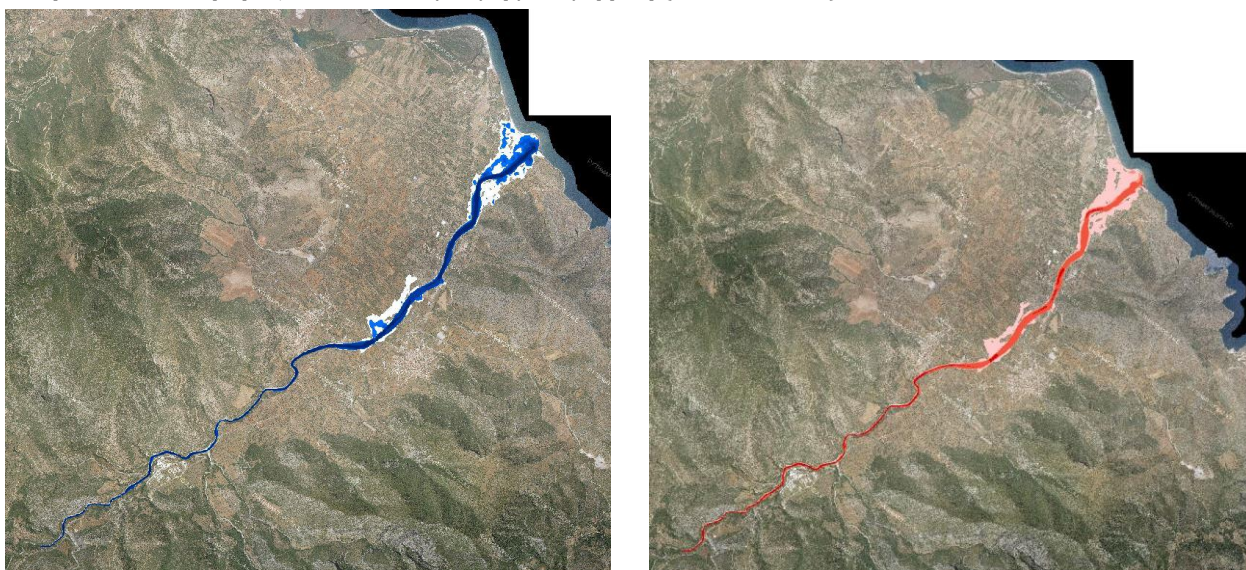
Σχήμα 3.40: Σχηματική απεικόνιση έκτασης - βάθους και ταχυτήτων ροής πλημμύρας του ρ. Βρασιάτης με περίοδο επαναφοράς T=50 ετών για μη μόνιμη ροή (MIKE FLOOD).
