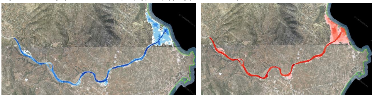
Σχήμα 3.45: Σχηματική απεικόνιση έκτασης - βάθους και ταχυτήτων ροής πλημμύρας του π. Τάνου με περίοδο επαναφοράς T=50 ετών για μη μόνιμη ροή (MIKE FLOOD).
