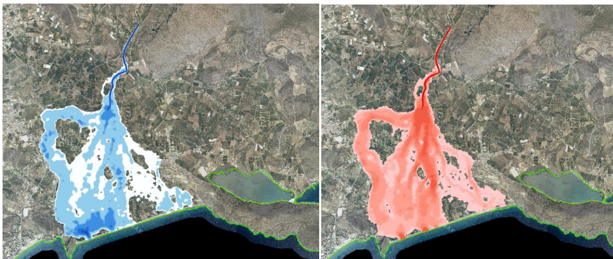
Σχήμα 3.85: Σχηματική απεικόνιση έκτασης - βάθους και ταχυτήτων ροής πλημμύρας του ρ. Δαφνόρρεμα με περίοδο επαναφοράς T=100 ετών για μη μόνιμη ροή (MIKE FLOOD).
