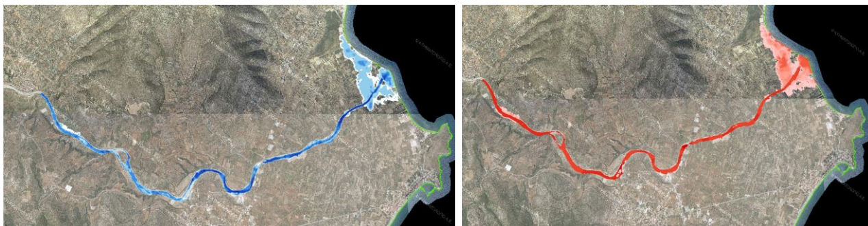
Σχήμα 3.45: Σχηματική απεικόνιση έκτασης - βάθους και ταχυτήτων ροής πλημμύρας του π. Τάνου με περίοδο επαναφοράς T=50 ετών για μη μόνιμη ροή (MIKE FLOOD).
