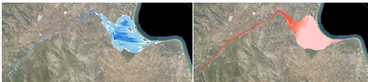
Σχήμα 3.36: Σχηματική απεικόνιση έκτασης - βάθους και ταχυτήτων ροής πλημμύρας του ρ. Πλακούλα με περίοδο επαναφοράς T=100 ετών για μη μόνιμη ροή (HEC-RAS).
