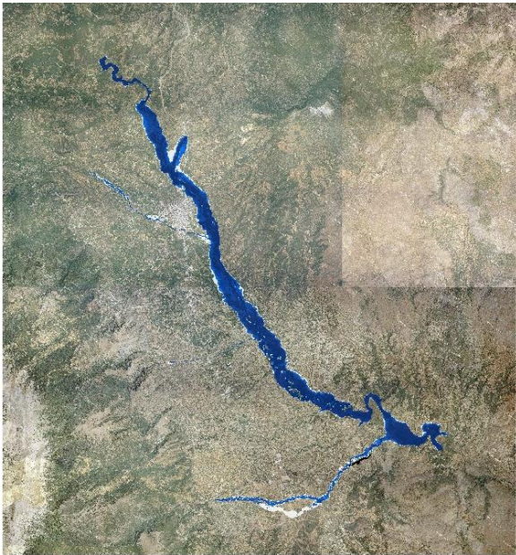
Σχήμα 3.27: Σχηματική απεικόνιση έκτασης - βάθους και ταχυτήτων ροής πλημμύρας του π. Ευρώτα με περίοδο επαναφοράς T=100 ετών για μη μόνιμη ροή (MIKE FLOOD).
