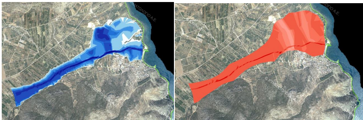
Σχήμα 3.59: Σχηματική απεικόνιση έκτασης - βάθους και ταχυτήτων ροής πλημμύρας του ρ. Ξοβριό με περίοδο επαναφοράς T=100 ετών για μη μόνιμη ροή (HEC-RAS).
