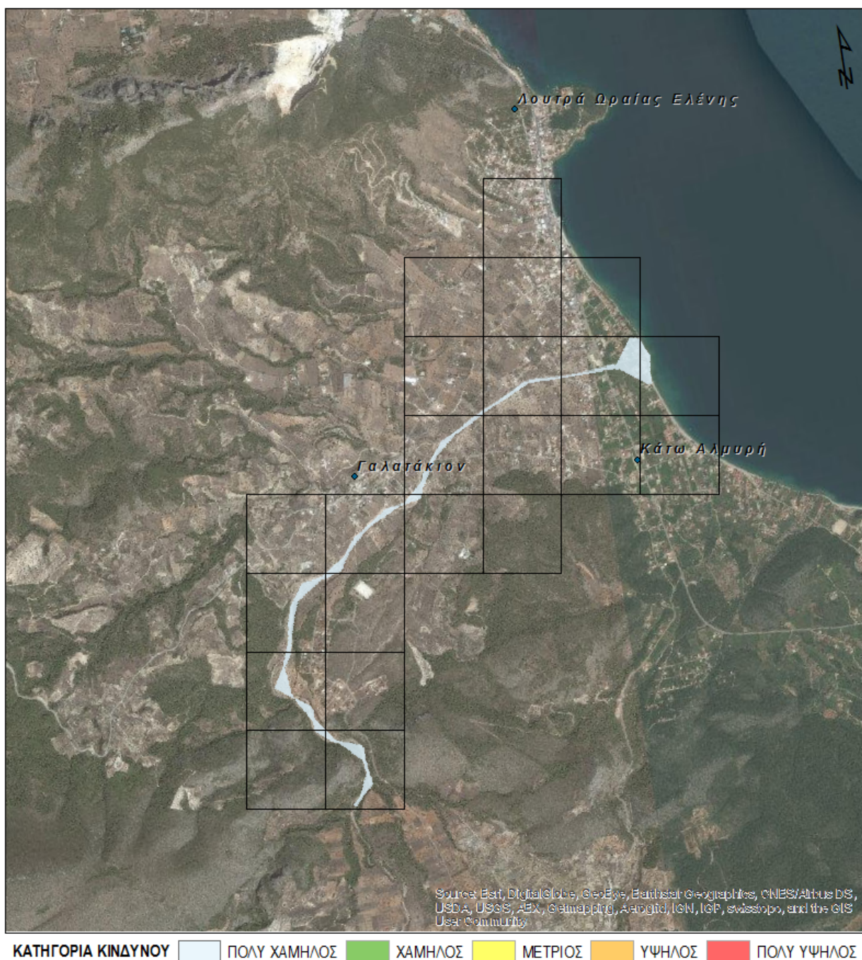
Εικόνα 6.2: Αξιολόγηση επιπτώσεων πλημμύρας για T=100 έτη - ΖΔΥΚΠ GR02RAK0001- Πεδινή περιοχή Λουτρών Ωραίας Ελένης
