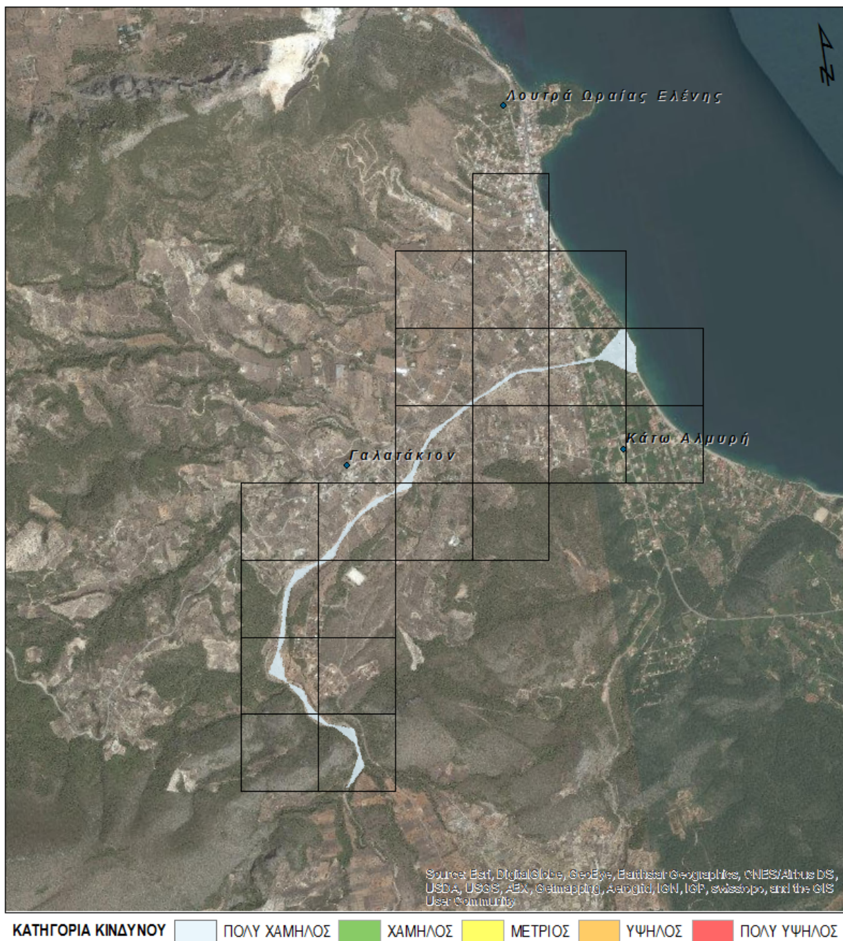
Εικόνα 6.1: Αξιολόγηση επιπτώσεων πλημμύρας για T=50 έτη - ΖΔΥΚΠ GR02RAK0001- Πεδινή περιοχή Λουτρών Ωραίας Ελένης
