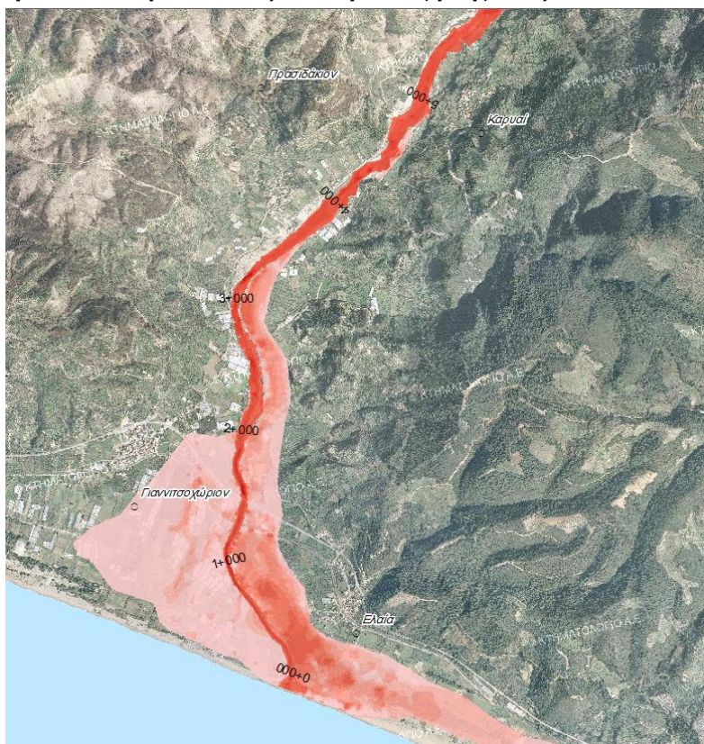
Σχήμα 5.10: Σχηματική απεικόνιση αποτελεσμάτων ταχύτητας του μοντέλου διόδευσης πλημμύρας
