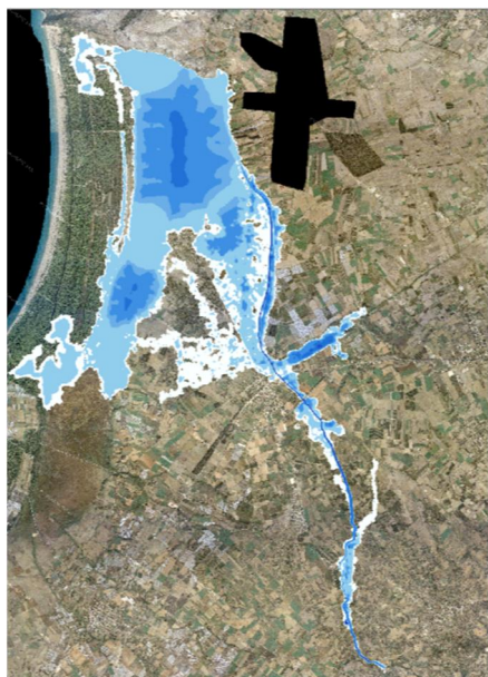
Σχήμα 3.150: Σχηματική απεικόνιση έκτασης - βάθους και ταχυτήτων ροής πλημμύρας του π. Λαρισσού ή Μάνα με περίοδο επαναφοράς T=100 ετών για μη μόνιμη ροή (MIKE FLOOD).
