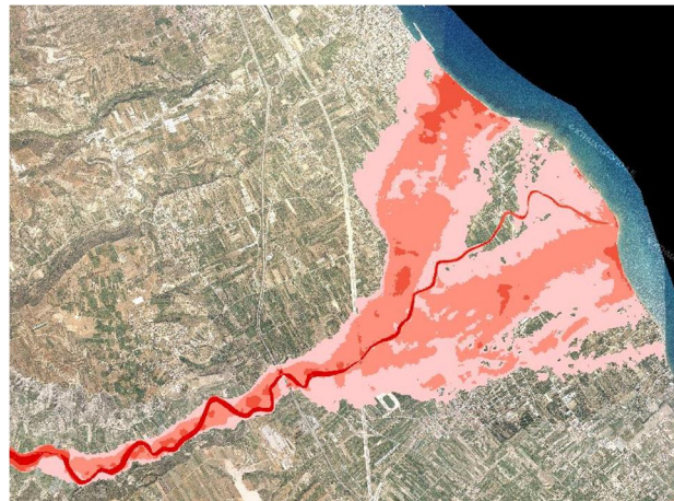
Σχήμα 3.46: Σχηματική απεικόνιση έκτασης - βάθους και ταχυτήτων ροής πλημμύρας του π. Ασωπού με περίοδο επαναφοράς T=1000 ετών για μη μόνιμη ροή (MIKE FLOOD).
