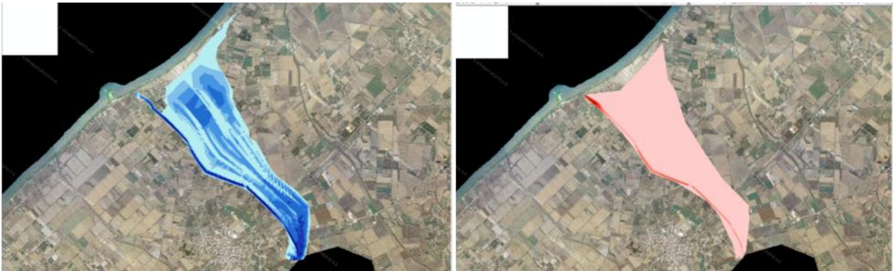
Σχήμα 3.113: Σχηματική απεικόνιση έκτασης - βάθους και ταχυτήτων ροής πλημμύρας του ρ. Λεχαινά με περίοδο επαναφοράς T=50 ετών για μη μόνιμη ροή (HEC-RAS).
