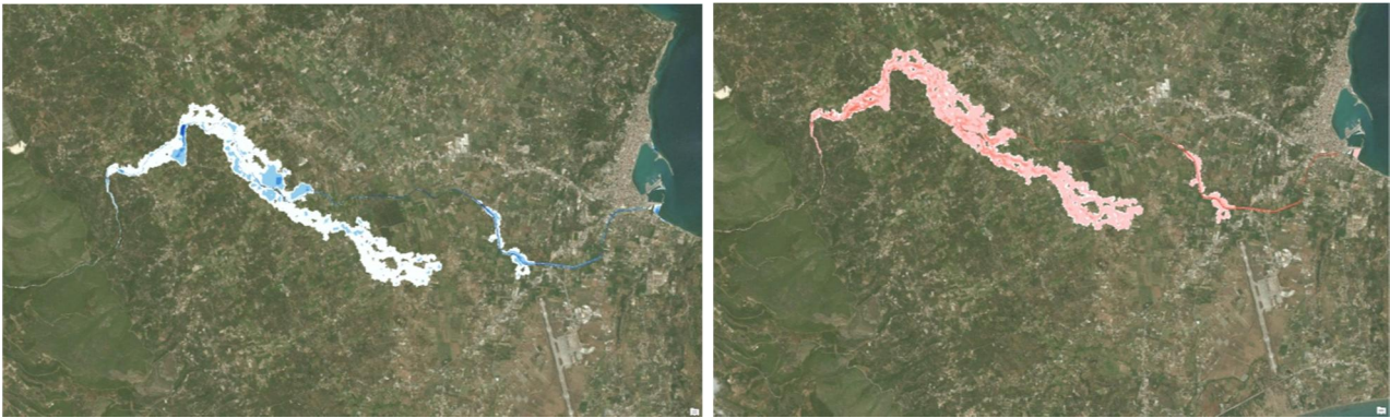
Σχήμα 3.16: Σχηματική απεικόνιση έκτασης - βάθους και ταχυτήτων ροής πλημμύρας του ρ. Αγίου Χαραλάμπη με περίοδο επαναφοράς T=50 ετών για μη μόνιμη ροή (MIKE FLOOD).
