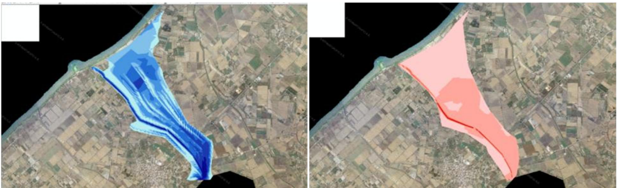
Σχήμα 3.115: Σχηματική απεικόνιση έκτασης - βάθους και ταχυτήτων ροής πλημμύρας του ρ. Λεχαινά με περίοδο επαναφοράς T=1000 ετών για μη μόνιμη ροή (HEC-RAS).
