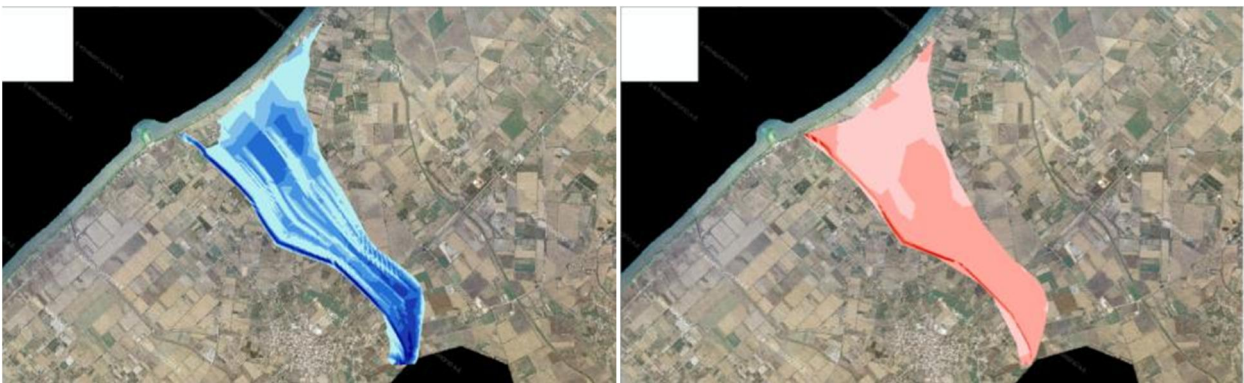
Σχήμα 3.114: Σχηματική απεικόνιση έκτασης - βάθους και ταχυτήτων ροής πλημμύρας του ρ. Λεχαινά με περίοδο επαναφοράς T=100 ετών για μη μόνιμη ροή (HEC-RAS).
