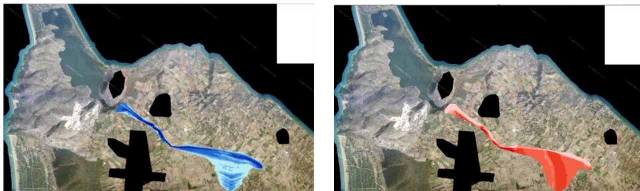
Σχήμα 3.90: Σχηματική απεικόνιση έκτασης - βάθους και ταχυτήτων ροής πλημμύρας του ρ. Καλογριά με περίοδο επαναφοράς T=1000 ετών για μη μόνιμη ροή (HEC-RAS).
