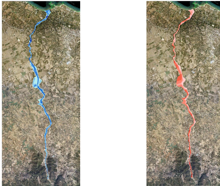
Σχήμα 3.85: Σχηματική απεικόνιση έκτασης - βάθους και ταχυτήτων ροής πλημμύρας του ρ. Ρέθι με περίοδο επαναφοράς T=1000 ετών για μη μόνιμη ροή (HEC-RAS).
