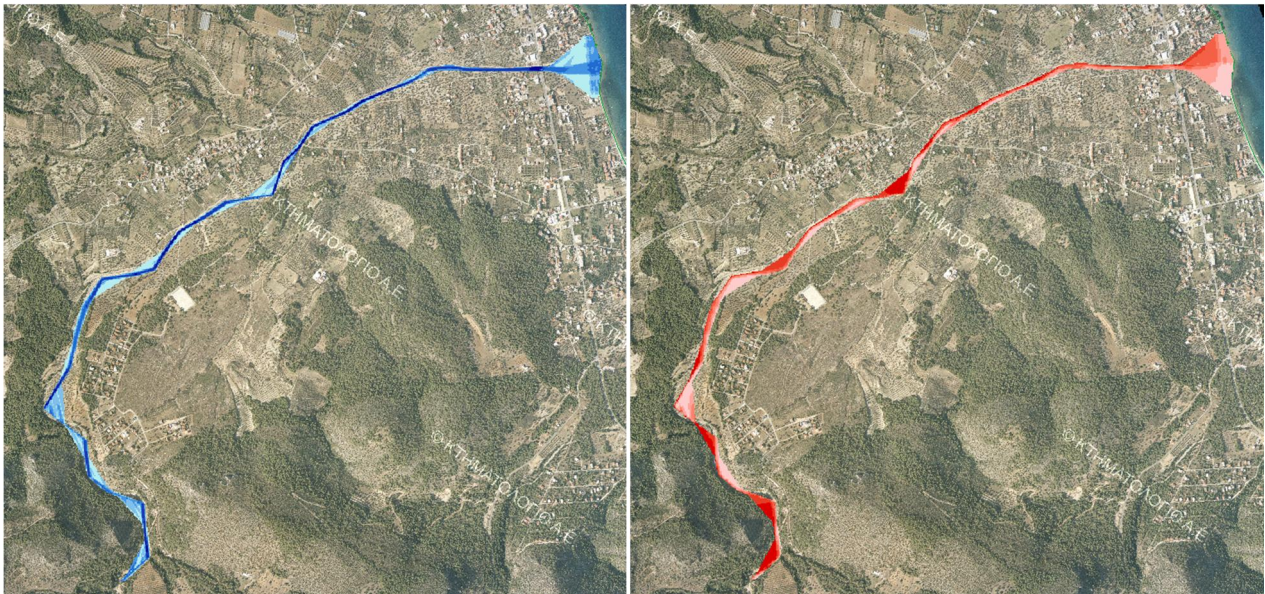
Σχήμα 3.1: Σχηματική απεικόνιση έκτασης - βάθους και ταχυτήτων ροής πλημμύρας του ρ. Φουρνιά με περίοδο επαναφοράς T=50 ετών για μη μόνιμη ροή (HEC-RAS).
