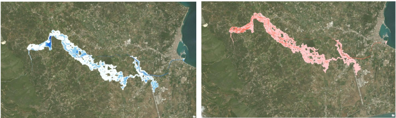
Σχήμα 3.17: Σχηματική απεικόνιση έκτασης - βάθους και ταχυτήτων ροής πλημμύρας του ρ. Αγίου Χαραλάμπη με περίοδο επαναφοράς T=100 ετών για μη μόνιμη ροή (MIKE FLOOD).
