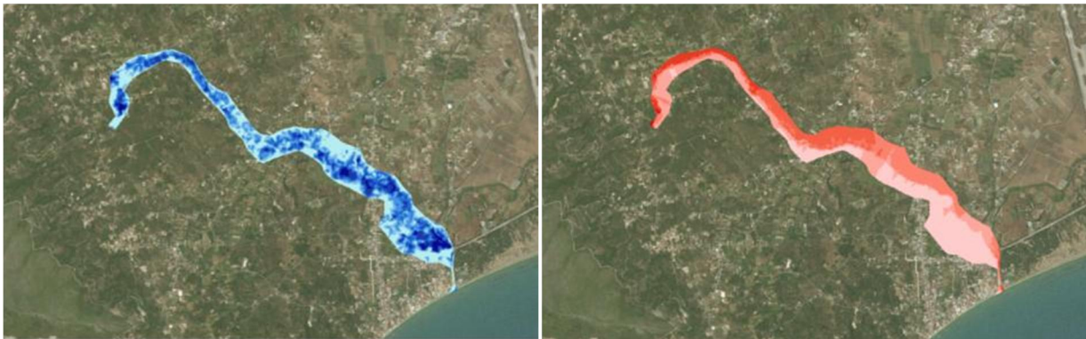
Σχήμα 3.12: Σχηματική απεικόνιση έκτασης - βάθους και ταχυτήτων ροής πλημμύρας του ρ. Λαγανά με περίοδο επαναφοράς T=100 ετών για μη μόνιμη ροή (HEC-RAS).
