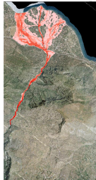
Σχήμα 3.56: Σχηματική απεικόνιση έκτασης - βάθους και ταχυτήτων ροής πλημμύρας του π. Βουραϊκού με περίοδο επαναφοράς T=50 ετών για μη μόνιμη ροή (MIKE FLOOD).
