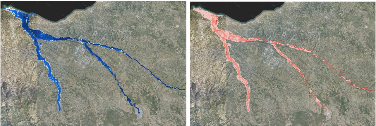
Σχήμα 3.145: Σχηματική απεικόνιση έκτασης - βάθους και ταχυτήτων ροής πλημμύρας του π. Πείρου με περίοδο επαναφοράς T=100 ετών για μη μόνιμη ροή (MIKE FLOOD).
