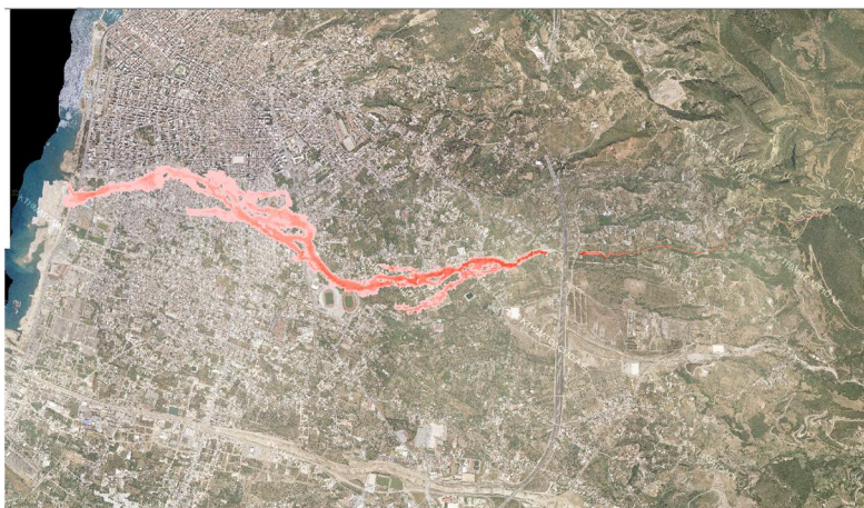
Σχήμα 3.138: Σχηματική απεικόνιση έκτασης - βάθους και ταχυτήτων ροής πλημμύρας του ρ. Διακονιάρη με περίοδο επαναφοράς T=1000 ετών για μη μόνιμη ροή (MIKE FLOOD).
