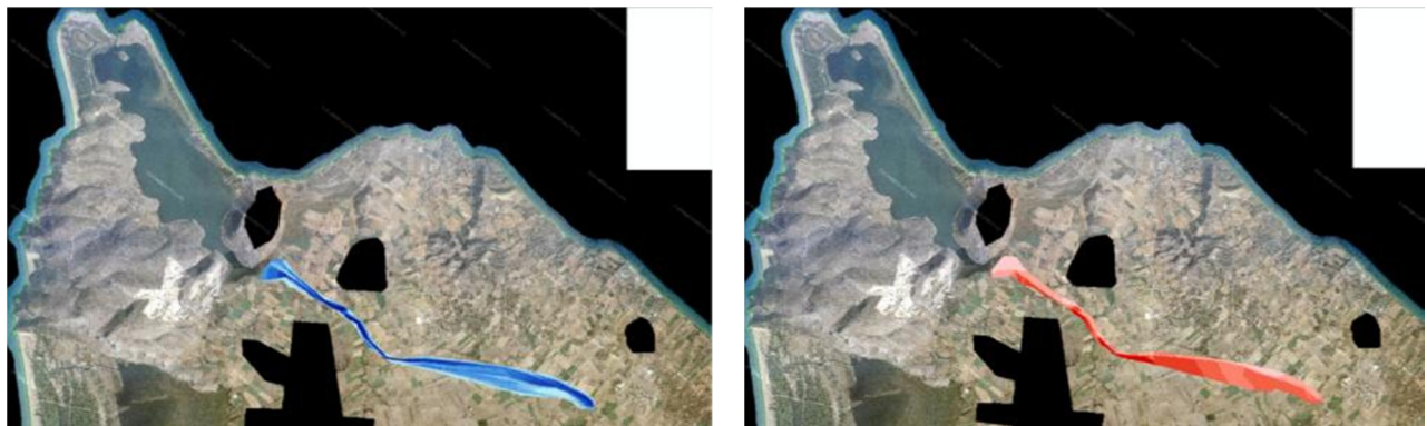
Σχήμα 3.89: Σχηματική απεικόνιση έκτασης - βάθους και ταχυτήτων ροής πλημμύρας του ρ. Καλογριά με περίοδο επαναφοράς T=100 ετών για μη μόνιμη ροή (HEC-RAS).
