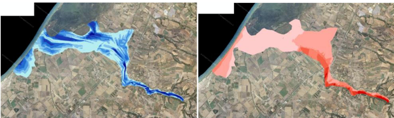
Σχήμα 3.110: Σχηματική απεικόνιση έκτασης - βάθους και ταχυτήτων ροής πλημμύρας του ρ. Γουβού με περίοδο επαναφοράς T=1000 ετών για μη μόνιμη ροή (HEC-RAS).
