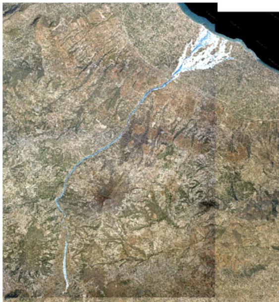
Σχήμα 3.40: Σχηματική απεικόνιση έκτασης - βάθους και ταχυτήτων ροής πλημμύρας του ρ. Ζαπάντη με περίοδο επαναφοράς T=100 ετών για μη μόνιμη ροή (MIKE FLOOD).
