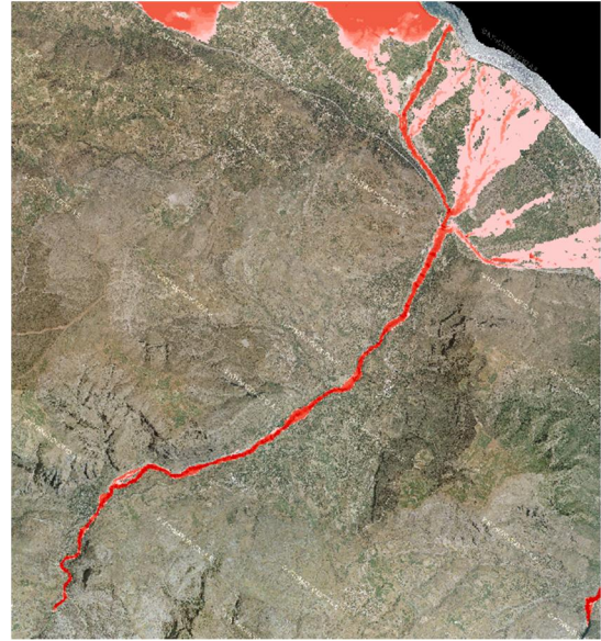
Σχήμα 3.63: Σχηματική απεικόνιση έκτασης - βάθους και ταχυτήτων ροής πλημμύρας του π. Κερυνίτη με περίοδο επαναφοράς T=1000 ετών για μη μόνιμη ροή (MIKE FLOOD).
