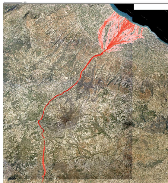
Σχήμα 3.41: Σχηματική απεικόνιση έκτασης - βάθους και ταχυτήτων ροής πλημμύρας του ρ. Ζαπάντη με περίοδο επαναφοράς T=1000 ετών για μη μόνιμη ροή (MIKE FLOOD).
