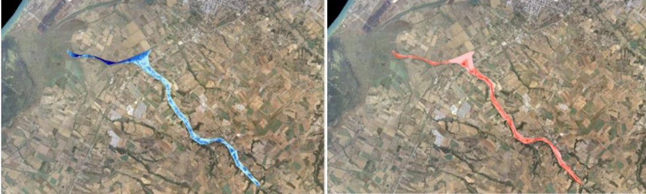
Σχήμα 3.103: Σχηματική απεικόνιση έκτασης - βάθους και ταχυτήτων ροής πλημμύρας του ρ. Καπελεταίικου με περίοδο επαναφοράς T=50 ετών για μη μόνιμη ροή (HEC-RAS).
