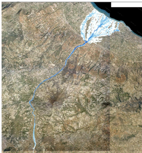
Σχήμα 3.41: Σχηματική απεικόνιση έκτασης - βάθους και ταχυτήτων ροής πλημμύρας του ρ. Ζαπάντη με περίοδο επαναφοράς T=1000 ετών για μη μόνιμη ροή (MIKE FLOOD).
