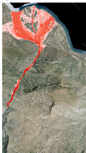
Σχήμα 3.57: Σχηματική απεικόνιση έκτασης - βάθους και ταχυτήτων ροής πλημμύρας του π. Βουραϊκού με περίοδο επαναφοράς T=100 ετών για μη μόνιμη ροή (MIKE FLOOD).
