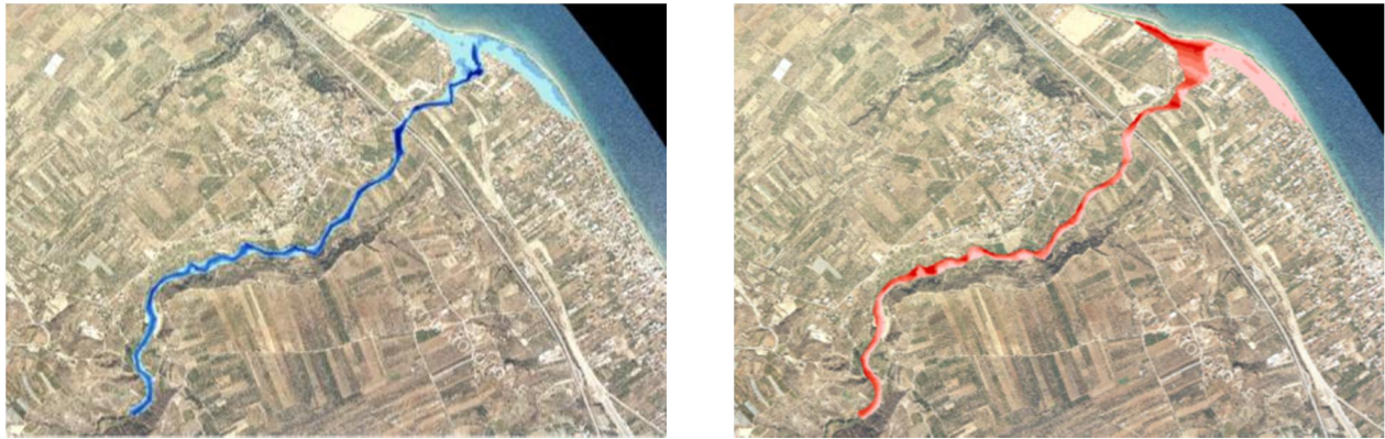
Σχήμα 3.53: Σχηματική απεικόνιση έκτασης - βάθους και ταχυτήτων ροής πλημμύρας του ρ. Σελιάνδρου με περίοδο επαναφοράς T=1000 ετών για μη μόνιμη ροή (HEC-RAS).
