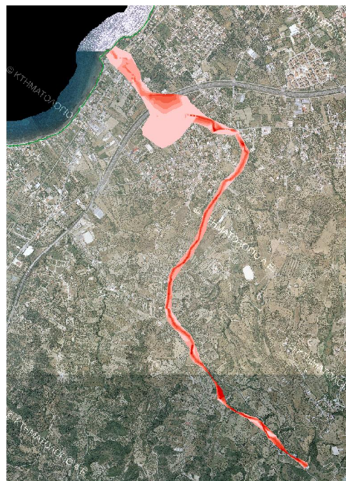
Σχήμα 3.78: Σχηματική απεικόνιση έκτασης - βάθους και ταχυτήτων ροής πλημμύρας του ρ. Κουριχάλη με περίοδο επαναφοράς T=50 ετών για μη μόνιμη ροή (HEC-RAS).
