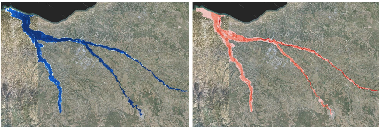
Σχήμα 3.146: Σχηματική απεικόνιση έκτασης - βάθους και ταχυτήτων ροής πλημμύρας του π. Πείρου με περίοδο επαναφοράς T=1000 ετών για μη μόνιμη ροή (MIKE FLOOD).
