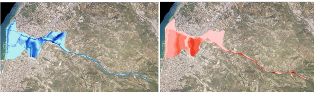
Σχήμα 3.75: Σχηματική απεικόνιση έκτασης - βάθους και ταχυτήτων ροής πλημμύρας του ρ. Βουντένη με περίοδο επαναφοράς T=1000 ετών για μη μόνιμη ροή (HEC-RAS).
