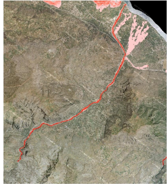
Σχήμα 3.61: Σχηματική απεικόνιση έκτασης - βάθους και ταχυτήτων ροής πλημμύρας του π. Κερυνίτη με περίοδο επαναφοράς T=50 ετών για μη μόνιμη ροή (MIKE FLOOD).
