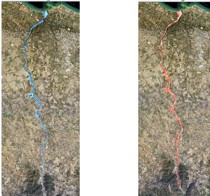
Σχήμα 3.83: Σχηματική απεικόνιση έκτασης - βάθους και ταχυτήτων ροής πλημμύρας του ρ. Ρέθι με περίοδο επαναφοράς T=50 ετών για μη μόνιμη ροή (HEC-RAS).
