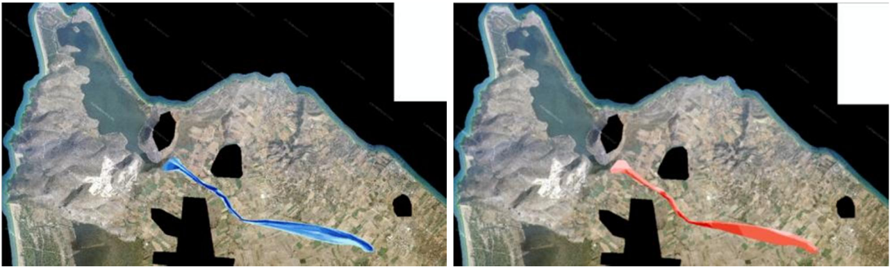
Σχήμα 3.88: Σχηματική απεικόνιση έκτασης - βάθους και ταχυτήτων ροής πλημμύρας του ρ. Καλογριά με περίοδο επαναφοράς T=50 ετών για μη μόνιμη ροή (HEC-RAS).
