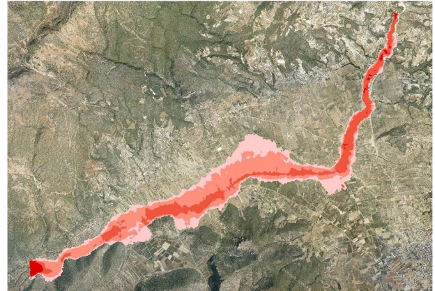
Σχήμα 3.8: Σχηματική απεικόνιση έκτασης - βάθους και ταχυτήτων ροής πλημμύρας του π. Ασωπού με περίοδο επαναφοράς T=1000 ετών για μη μόνιμη ροή (MIKE FLOOD).
