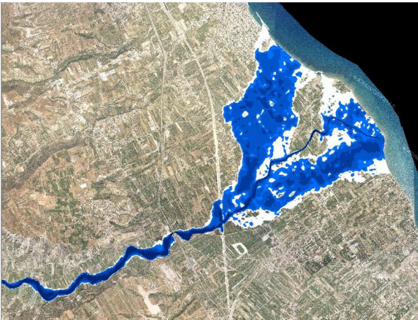
Σχήμα 3.44: Σχηματική απεικόνιση έκτασης - βάθους και ταχυτήτων ροής πλημμύρας του π. Ασωπού με περίοδο επαναφοράς T=50 ετών για μη μόνιμη ροή (MIKE FLOOD).
