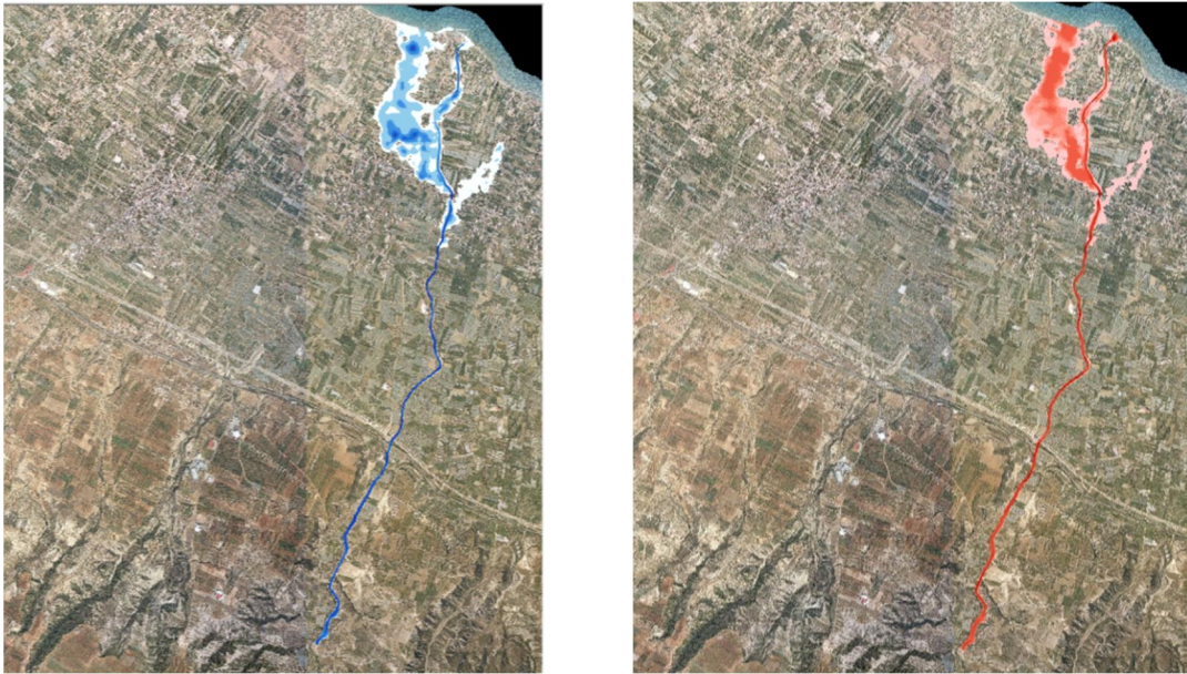
Σχήμα 3.34 : Σχηματική απεικόνιση έκτασης - βάθους και ταχυτήτων ροής πλημμύρας του ρ. Ραϊζάνη με περίοδο επαναφοράς T=50 ετών για μη μόνιμη ροή (MIKE FLOOD).
