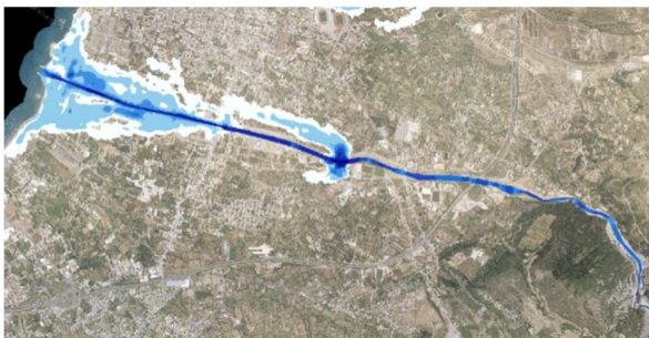
Σχήμα 3.141: Σχηματική απεικόνιση έκτασης - βάθους και ταχυτήτων ροής πλημμύρας του π. Γλαύκου με περίοδο επαναφοράς T=1000 ετών για μη μόνιμη ροή (MIKE FLOOD).
