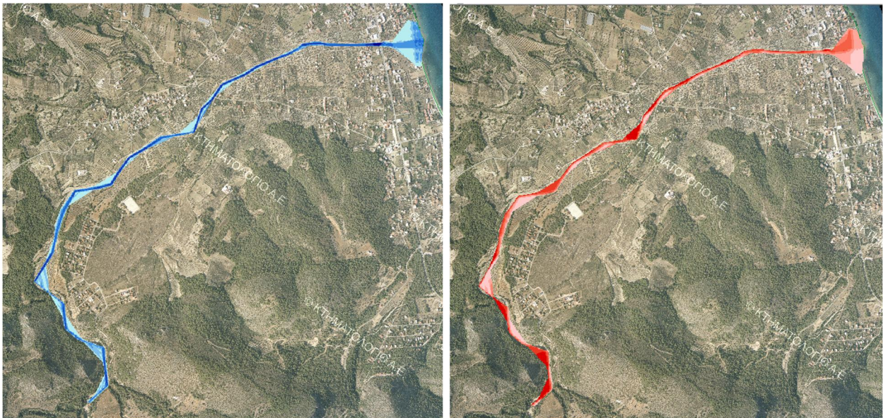
Σχήμα 3.2: Σχηματική απεικόνιση έκτασης - βάθους και ταχυτήτων ροής πλημμύρας του ρ. Φουρνιά με περίοδο επαναφοράς T=100 ετών για μη μόνιμη ροή (HEC-RAS).
