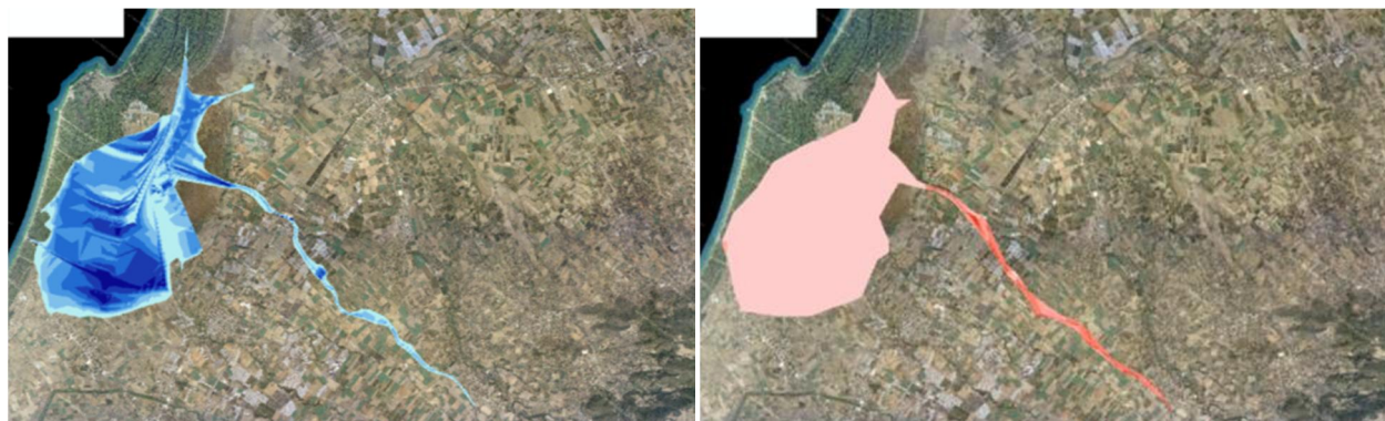
Σχήμα 3.93: Σχηματική απεικόνιση έκτασης - βάθους και ταχυτήτων ροής πλημμύρας του ρ. Ρούσκουλα με περίοδο επαναφοράς T=50 ετών για μη μόνιμη ροή (HEC-RAS).
