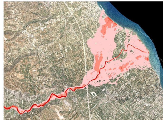
Σχήμα 3.45: Σχηματική απεικόνιση έκτασης - βάθους και ταχυτήτων ροής πλημμύρας του π. Ασωπού με περίοδο επαναφοράς T=100 ετών για μη μόνιμη ροή (MIKE FLOOD).
