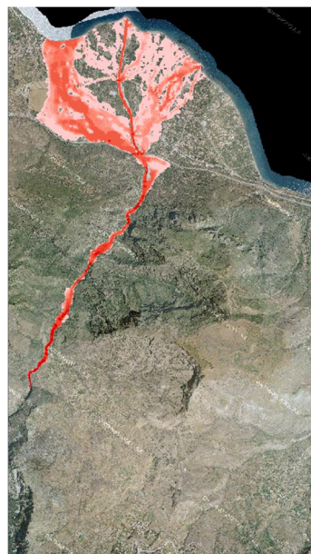
Σχήμα 3.57: Σχηματική απεικόνιση έκτασης - βάθους και ταχυτήτων ροής πλημμύρας του π. Βουραϊκού με περίοδο επαναφοράς T=100 ετών για μη μόνιμη ροή (MIKE FLOOD).
