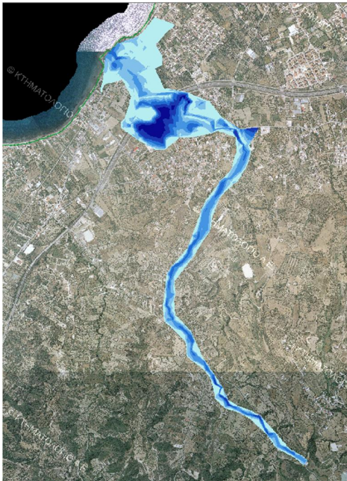
Σχήμα 3.80: Σχηματική απεικόνιση έκτασης - βάθους και ταχυτήτων ροής πλημμύρας του ρ. Κουριχάλη με περίοδο επαναφοράς T=1000 ετών για μη μόνιμη ροή (HEC-RAS).
