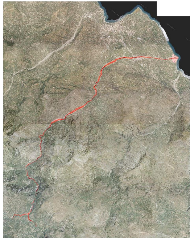
Σχήμα 3.66 : : Σχηματική απεικόνιση έκτασης - βάθους και ταχυτήτων ροής πλημμύρας του π. Σελινούντα με περίοδο επαναφοράς T=50 ετών για μη μόνιμη ροή (MIKE FLOOD).
