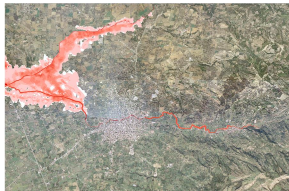
Σχήμα 3.166: Σχηματική απεικόνιση έκτασης - βάθους και ταχυτήτων ροής πλημμύρας του ρ. Σοχιά με περίοδο επαναφοράς T=1000 ετών για μη μόνιμη ροή (MIKE FLOOD).
