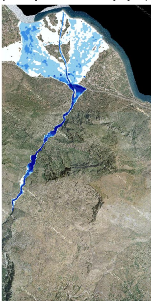
Σχήμα 3.57: Σχηματική απεικόνιση έκτασης - βάθους και ταχυτήτων ροής πλημμύρας του π. Βουραϊκού με περίοδο επαναφοράς T=100 ετών για μη μόνιμη ροή (MIKE FLOOD).
