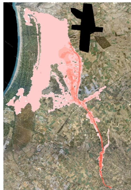
Σχήμα 3.150: Σχηματική απεικόνιση έκτασης - βάθους και ταχυτήτων ροής πλημμύρας του π. Λαρισσού ή Μάνα με περίοδο επαναφοράς T=100 ετών για μη μόνιμη ροή (MIKE FLOOD).
