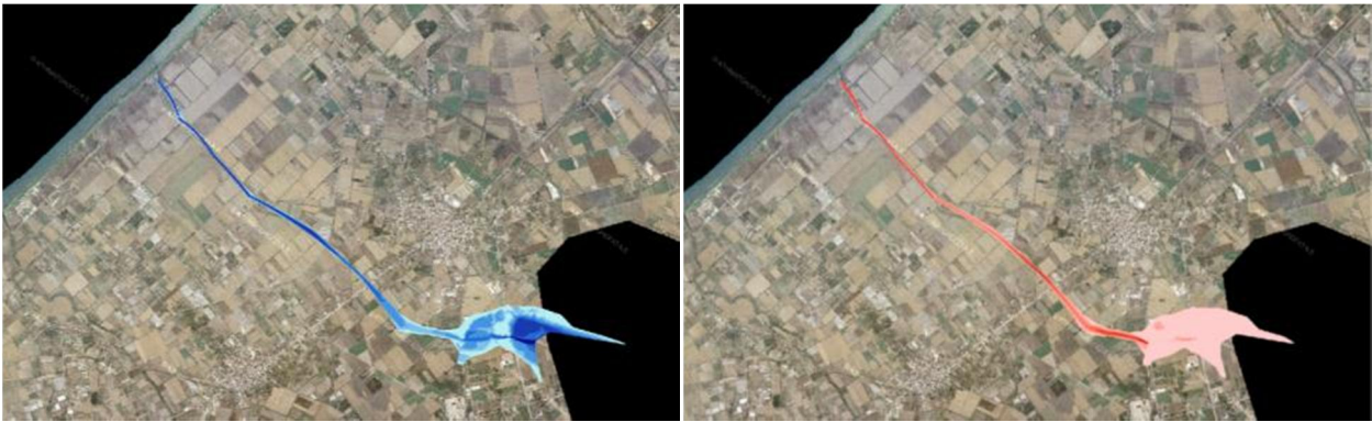
Σχήμα 3.118: Σχηματική απεικόνιση έκτασης - βάθους και ταχυτήτων ροής πλημμύρας του ρ. Μελισσός με περίοδο επαναφοράς T=50 ετών για μη μόνιμη ροή (HEC-RAS).
