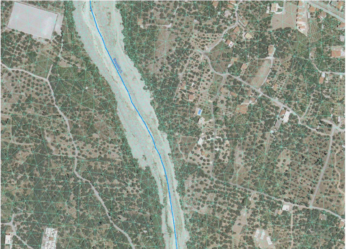
Σχήμα 2.28: Σχηματική απεικόνιση μοντελοποίησης στο MIKE με τριγωνικά πεπερασμένα στοιχεία σε περιοχή εντός και εκτός κοίτης του ποταμού.
