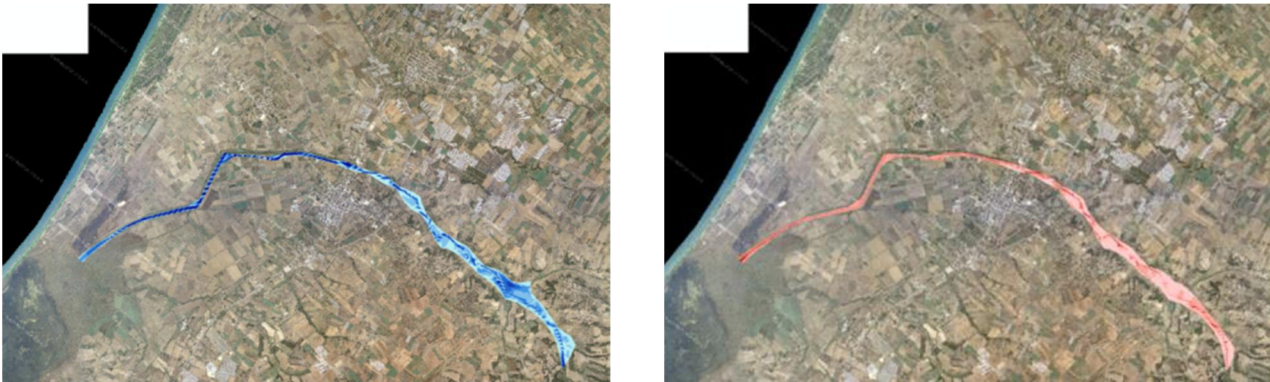
Σχήμα 3.98: Σχηματική απεικόνιση έκτασης - βάθους και ταχυτήτων ροής πλημμύρας του π. Βέργα με περίοδο επαναφοράς T=50 ετών για μη μόνιμη ροή (HEC-RAS).
