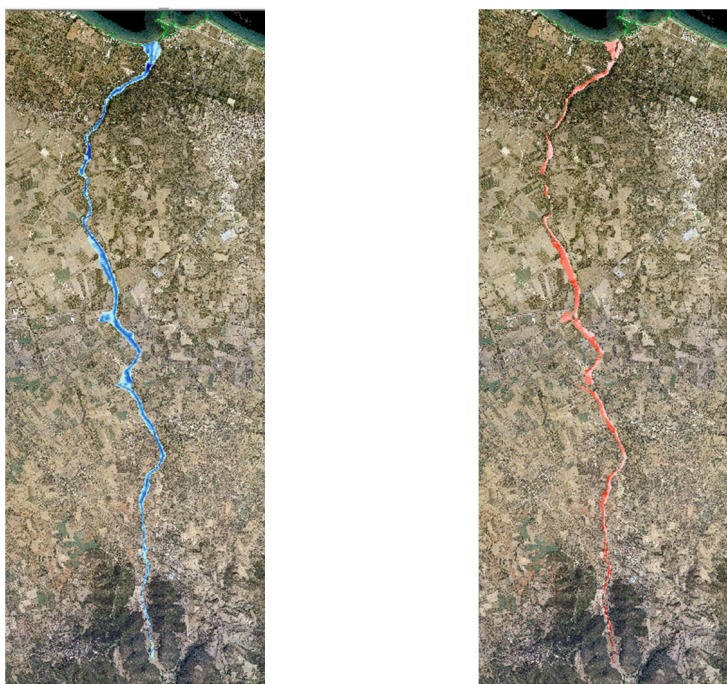
Σχήμα 3.84: Σχηματική απεικόνιση έκτασης - βάθους και ταχυτήτων ροής πλημμύρας του ρ. Ρέθι με περίοδο επαναφοράς T=100 ετών για μη μόνιμη ροή (HEC-RAS).
