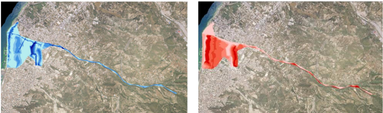
Σχήμα 3.73: Σχηματική απεικόνιση έκτασης - βάθους και ταχυτήτων ροής πλημμύρας του ρ. Βουντένη με περίοδο επαναφοράς T=50 ετών για μη μόνιμη ροή (HEC-RAS).
