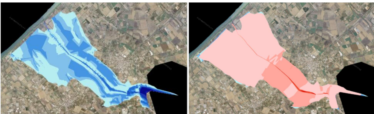
Σχήμα 3.120: Σχηματική απεικόνιση έκτασης - βάθους και ταχυτήτων ροής πλημμύρας του ρ. Μελισσός με περίοδο επαναφοράς T=1000 ετών για μη μόνιμη ροή (HEC-RAS).
