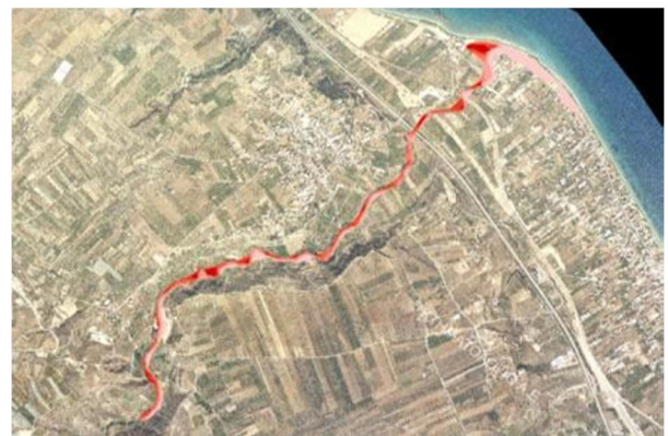
Σχήμα 3.52: Σχηματική απεικόνιση έκτασης - βάθους και ταχυτήτων ροής πλημμύρας του ρ. Σελίανδρου με περίοδο επαναφοράς T=100 ετών για μη μόνιμη ροή (HEC-RAS).
