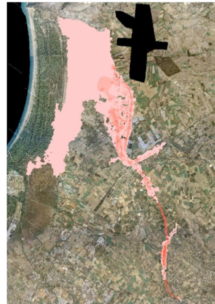
Σχήμα 3.149: Σχηματική απεικόνιση έκτασης - βάθους και ταχυτήτων ροής πλημμύρας του π. Λαρισσού ή Μάνα με περίοδο επαναφοράς T=50 ετών για μη μόνιμη ροή (MIKE FLOOD).
