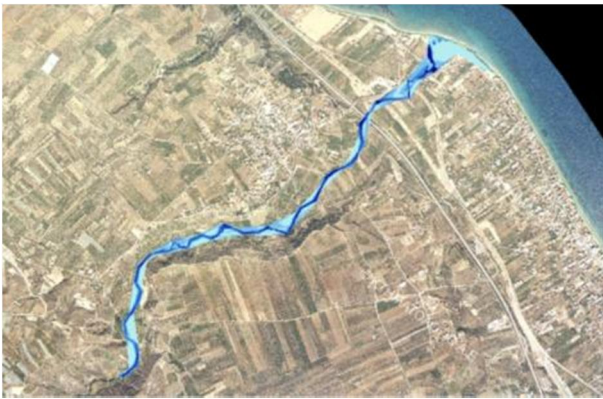
Σχήμα 3.51: Σχηματική απεικόνιση έκτασης - βάθους και ταχυτήτων ροής πλημμύρας του ρ. Σελίανδρου με περίοδο επαναφοράς T=50 ετών για μη μόνιμη ροή (HEC-RAS).
