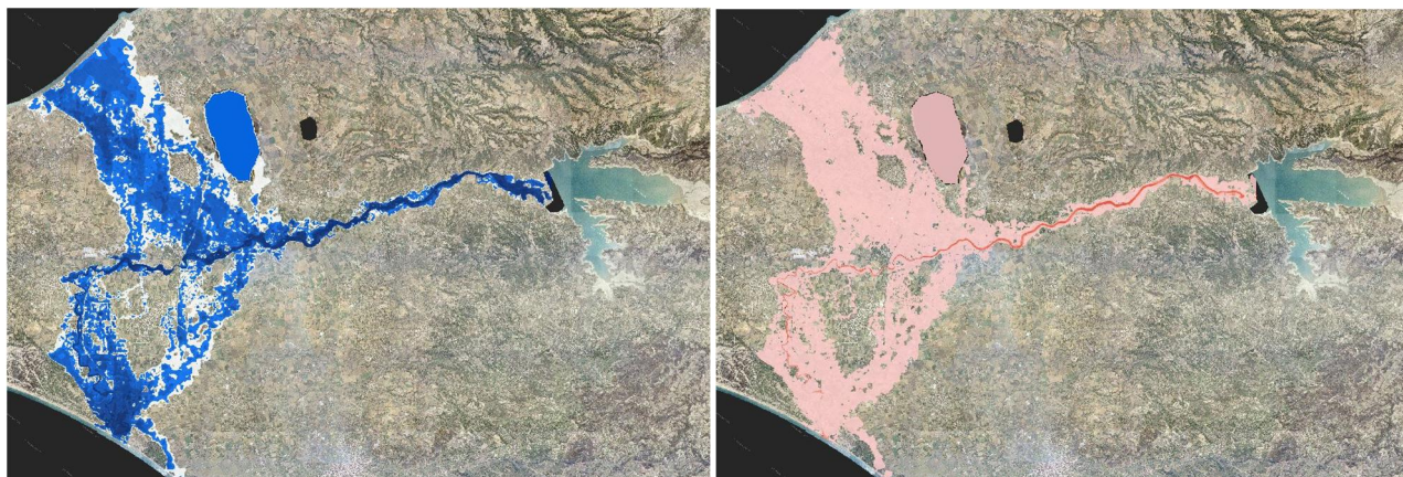
Σχήμα 3.156: Σχηματική απεικόνιση έκτασης - βάθους και ταχυτήτων ροής πλημμύρας του π. Πηνειού με περίοδο επαναφοράς T=1000 ετών για μη μόνιμη ροή (MIKE FLOOD).
