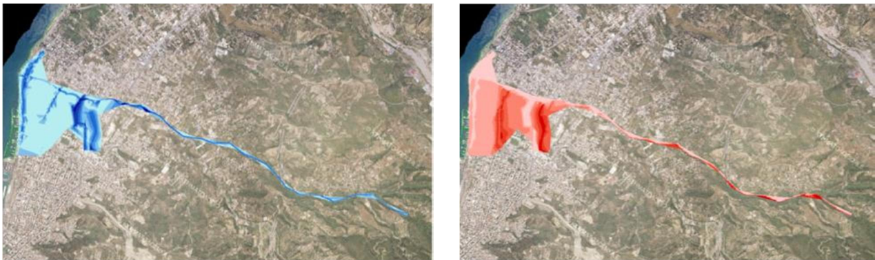
Σχήμα 3.73: Σχηματική απεικόνιση έκτασης - βάθους και ταχυτήτων ροής πλημμύρας του ρ. Βουντένη με περίοδο επαναφοράς T=50 ετών για μη μόνιμη ροή (HEC-RAS).
