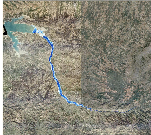
Σχήμα 3.176: Σχηματική απεικόνιση έκτασης - βάθους και ταχυτήτων ροής πλημμύρας του π. Πηνειακού Λάδωνα με περίοδο επαναφοράς T=1000 ετών για μη μόνιμη ροή (MIKE FLOOD).
