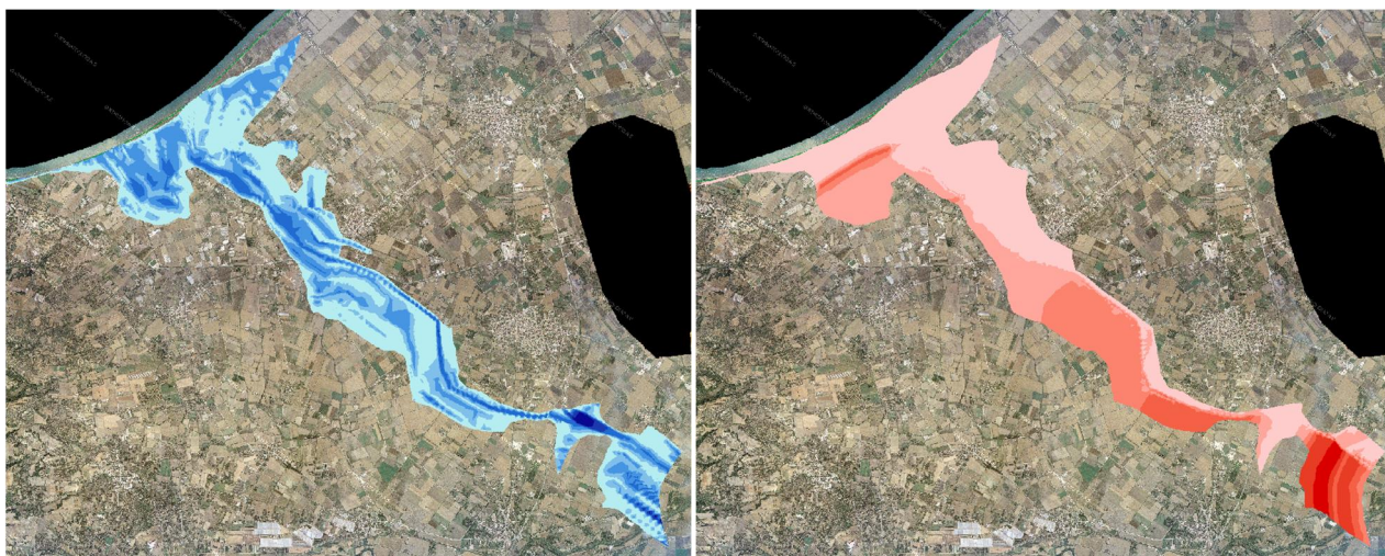
Σχήμα 3.124: Σχηματική απεικόνιση έκτασης - βάθους και ταχυτήτων ροής πλημμύρας του ρ. Ανισάτος με περίοδο επαναφοράς T=100 ετών για μη μόνιμη ροή (HEC-RAS).
