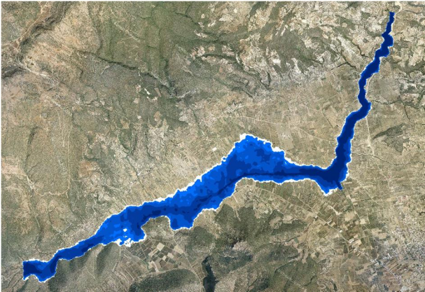
Σχήμα 3.8: Σχηματική απεικόνιση έκτασης - βάθους και ταχυτήτων ροής πλημμύρας του π. Ασωπού με περίοδο επαναφοράς T=1000 ετών για μη μόνιμη ροή (MIKE FLOOD).
