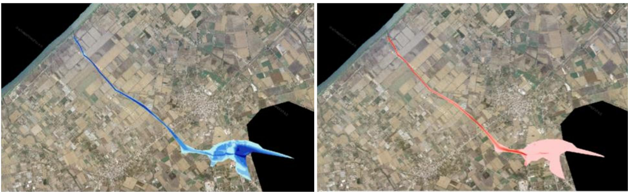
Σχήμα 3.119: Σχηματική απεικόνιση έκτασης - βάθους και ταχυτήτων ροής πλημμύρας του ρ. Μελισσός με περίοδο επαναφοράς T=100 ετών για μη μόνιμη ροή (HEC-RAS).
