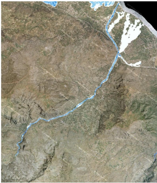
Σχήμα 3.61: Σχηματική απεικόνιση έκτασης - βάθους και ταχυτήτων ροής πλημμύρας του π. Κερυνίτη με περίοδο επαναφοράς T=50 ετών για μη μόνιμη ροή (MIKE FLOOD).
