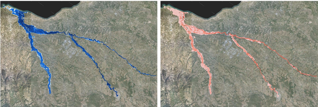
Σχήμα 3.144: Σχηματική απεικόνιση έκτασης - βάθους και ταχυτήτων ροής πλημμύρας του π. Πείρου με περίοδο επαναφοράς T=50 ετών για μη μόνιμη ροή (MIKE FLOOD).
