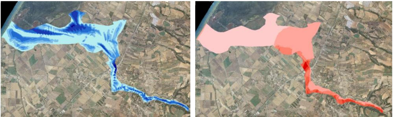
Σχήμα 3.108: Σχηματική απεικόνιση έκτασης - βάθους και ταχυτήτων ροής πλημμύρας του ρ. Γουβού με περίοδο επαναφοράς T=50 ετών για μη μόνιμη ροή (HEC-RAS).
