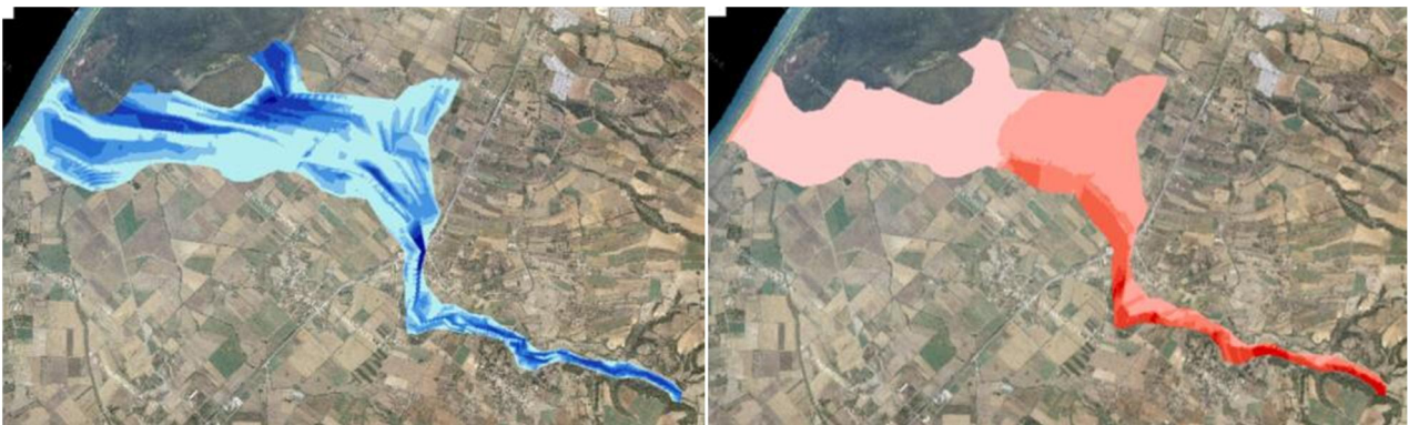
Σχήμα 3.109: Σχηματική απεικόνιση έκτασης - βάθους και ταχυτήτων ροής πλημμύρας του ρ. Γουβού με περίοδο επαναφοράς T=100 ετών για μη μόνιμη ροή (HEC-RAS).
