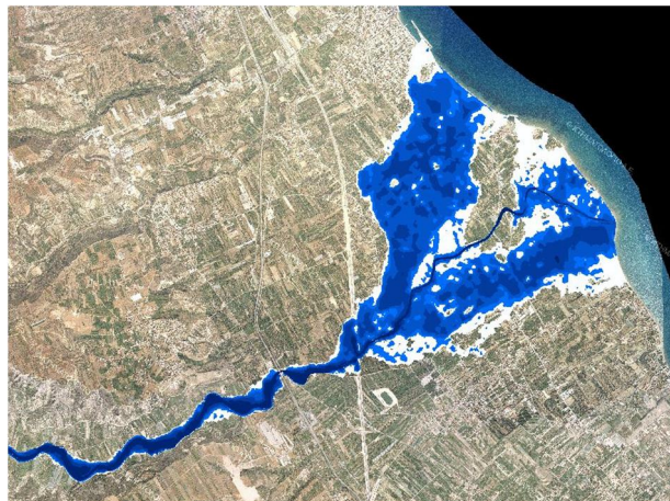
Σχήμα 3.45: Σχηματική απεικόνιση έκτασης - βάθους και ταχυτήτων ροής πλημμύρας του π. Ασωπού με περίοδο επαναφοράς T=100 ετών για μη μόνιμη ροή (MIKE FLOOD).
