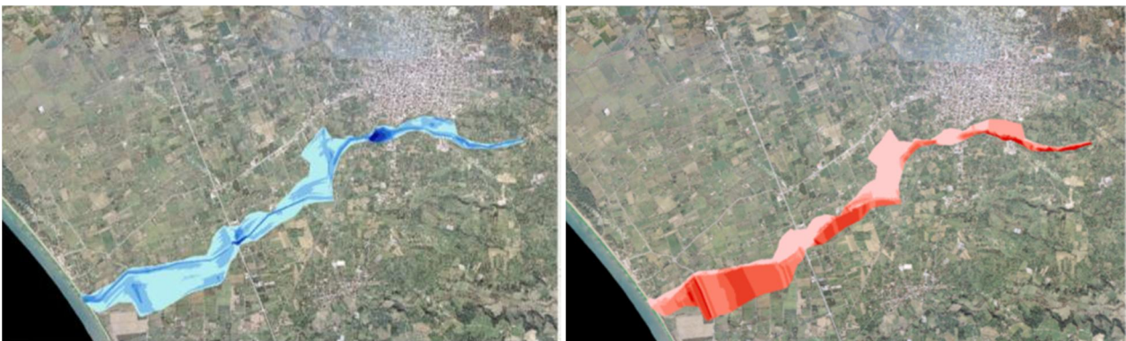
Σχήμα 3.129: Σχηματική απεικόνιση έκτασης - βάθους και ταχυτήτων ροής πλημμύρας του ρ. Μουντρούμη με περίοδο επαναφοράς T=100 ετών για μη μόνιμη ροή (HEC-RAS).
