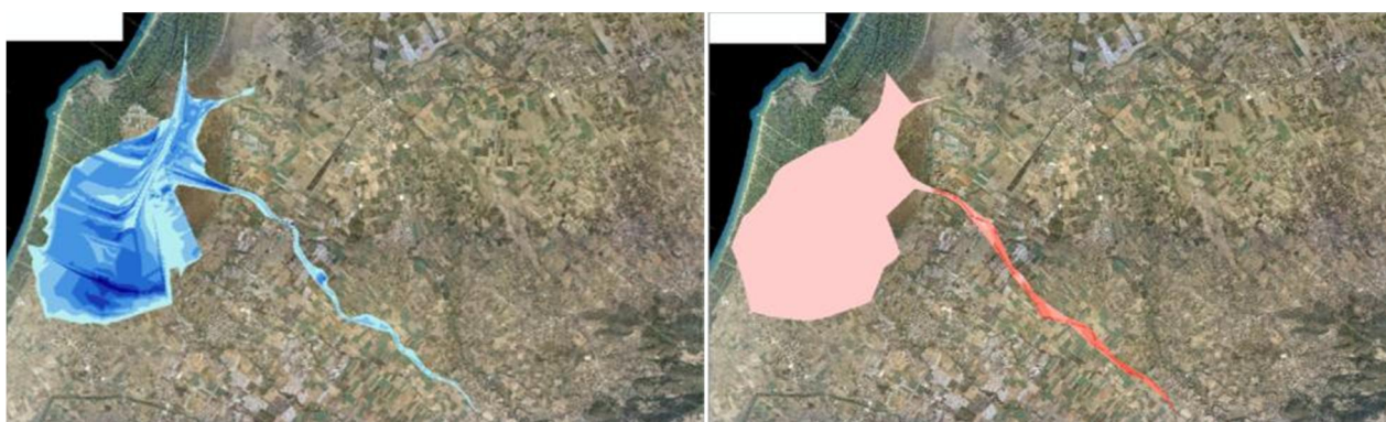
Σχήμα 3.94: Σχηματική απεικόνιση έκτασης - βάθους και ταχυτήτων ροής πλημμύρας του ρ. Ρούσκουλα με περίοδο επαναφοράς T=100 ετών για μη μόνιμη ροή (HEC-RAS).
