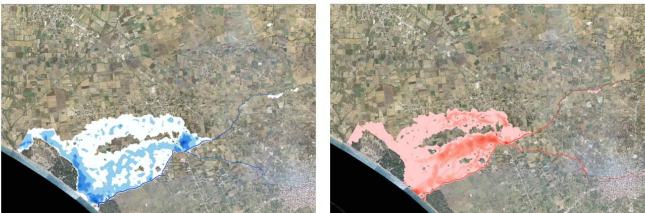
Σχήμα 3.160: Σχηματική απεικόνιση έκτασης - βάθους και ταχυτήτων ροής πλημμύρας του ρ. Γκουρλέσσα με περίοδο επαναφοράς T=100 ετών για μη μόνιμη ροή (MIKE FLOOD).
