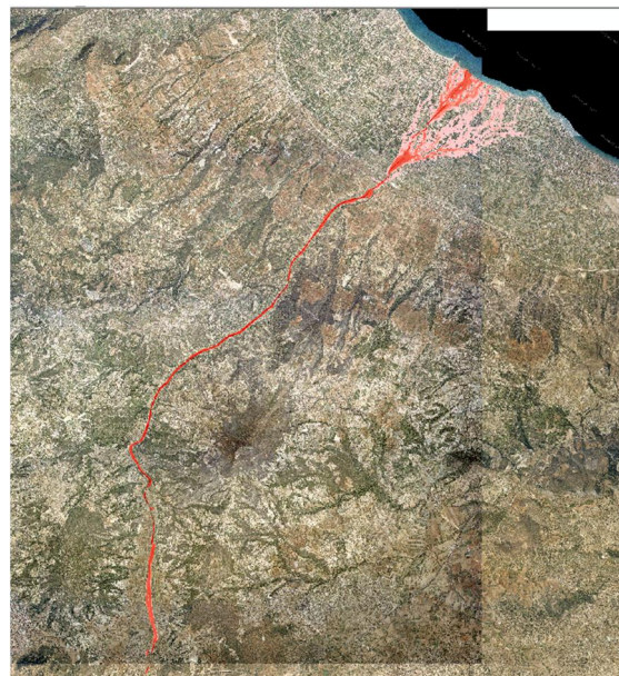
Σχήμα 3.40: Σχηματική απεικόνιση έκτασης - βάθους και ταχυτήτων ροής πλημμύρας του ρ. Ζαπάντη με περίοδο επαναφοράς T=100 ετών για μη μόνιμη ροή (MIKE FLOOD).
