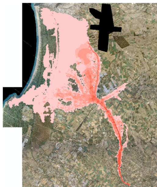
Σχήμα 3.151: Σχηματική απεικόνιση έκτασης - βάθους και ταχυτήτων ροής πλημμύρας του π. Λαρισσού ή Μάνα με περίοδο επαναφοράς T=1000 ετών για μη μόνιμη ροή (MIKE FLOOD).
