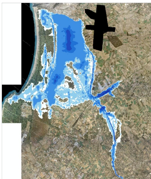
Σχήμα 3.151: Σχηματική απεικόνιση έκτασης - βάθους και ταχυτήτων ροής πλημμύρας του π. Λαρισσού ή Μάνα με περίοδο επαναφοράς T=1000 ετών για μη μόνιμη ροή (MIKE FLOOD).
