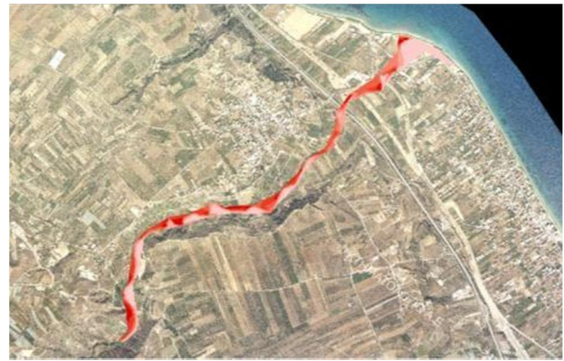
Σχήμα 3.51: Σχηματική απεικόνιση έκτασης - βάθους και ταχυτήτων ροής πλημμύρας του ρ. Σελίανδρου με περίοδο επαναφοράς T=50 ετών για μη μόνιμη ροή (HEC-RAS).
