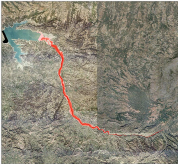
Σχήμα 3.176: Σχηματική απεικόνιση έκτασης - βάθους και ταχυτήτων ροής πλημμύρας του π. Πηνειακού Λάδωνα με περίοδο επαναφοράς T=1000 ετών για μη μόνιμη ροή (MIKE FLOOD).
