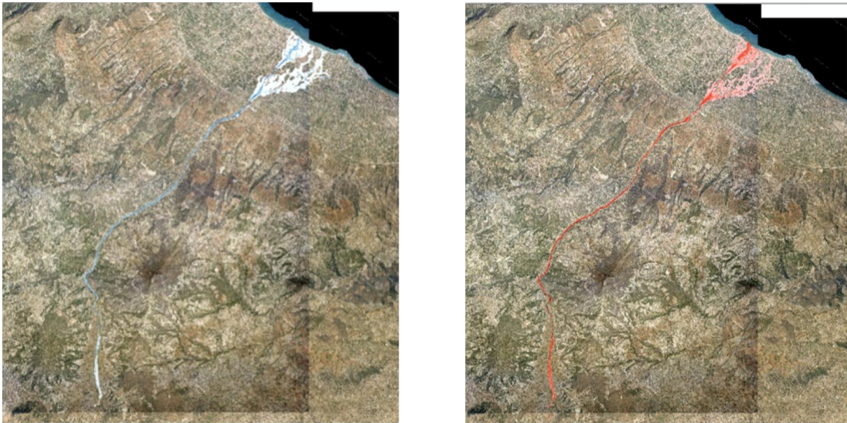
Σχήμα 3.39 : Σχηματική απεικόνιση έκτασης - βάθους και ταχυτήτων ροής πλημμύρας του ρ. Ζαπάντη με περίοδο επαναφοράς T=50 ετών για μη μόνιμη ροή (MIKE FLOOD).
