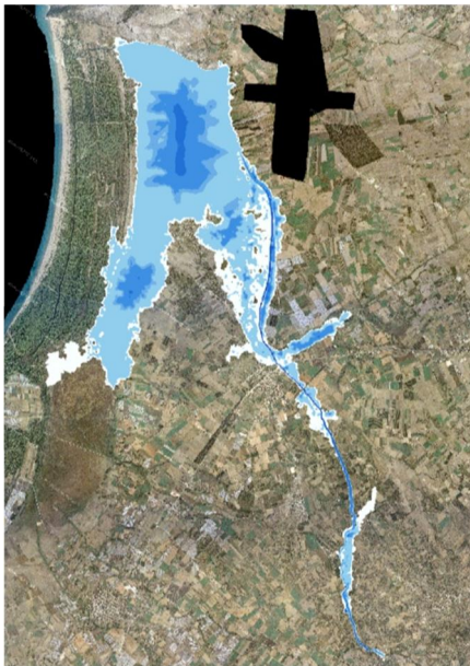
Σχήμα 3.149: Σχηματική απεικόνιση έκτασης - βάθους και ταχυτήτων ροής πλημμύρας του π. Λαρισσού ή Μάνα με περίοδο επαναφοράς T=50 ετών για μη μόνιμη ροή (MIKE FLOOD).
