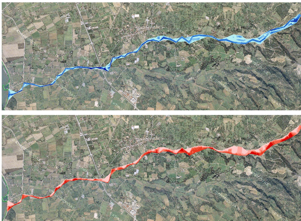
Σχήμα 3.133: Σχηματική απεικόνιση έκτασης - βάθους και ταχυτήτων ροής πλημμύρας του ρ. Λατίφη με περίοδο επαναφοράς T=50 ετών για μη μόνιμη ροή (HEC-RAS).
