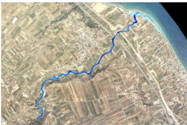
Σχήμα 3.52: Σχηματική απεικόνιση έκτασης - βάθους και ταχυτήτων ροής πλημμύρας του ρ. Σελίανδρου με περίοδο επαναφοράς T=100 ετών για μη μόνιμη ροή (HEC-RAS).
