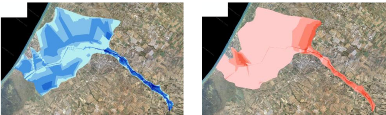
Σχήμα 3.100: Σχηματική απεικόνιση έκτασης - βάθους και ταχυτήτων ροής πλημμύρας του π. Βέργα με περίοδο επαναφοράς T=1000 ετών για μη μόνιμη ροή (HEC-RAS).
