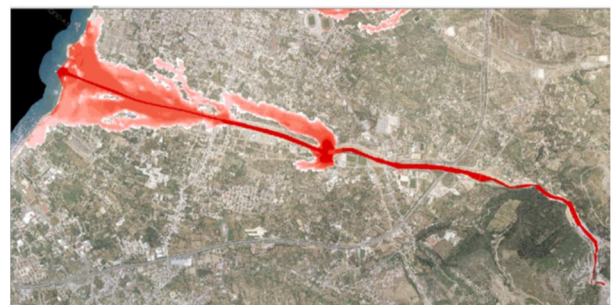
Σχήμα 3.141: Σχηματική απεικόνιση έκτασης - βάθους και ταχυτήτων ροής πλημμύρας του π. Γλαύκου με περίοδο επαναφοράς T=1000 ετών για μη μόνιμη ροή (MIKE FLOOD).
