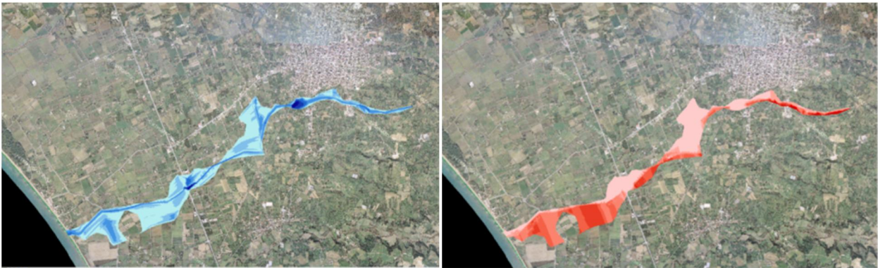
Σχήμα 3.128: Σχηματική απεικόνιση έκτασης - βάθους και ταχυτήτων ροής πλημμύρας του ρ. Μουντρούμη με περίοδο επαναφοράς T=50 ετών για μη μόνιμη ροή (HEC-RAS).
