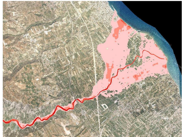
Σχήμα 3.44: Σχηματική απεικόνιση έκτασης - βάθους και ταχυτήτων ροής πλημμύρας του π. Ασωπού με περίοδο επαναφοράς T=50 ετών για μη μόνιμη ροή (MIKE FLOOD).
