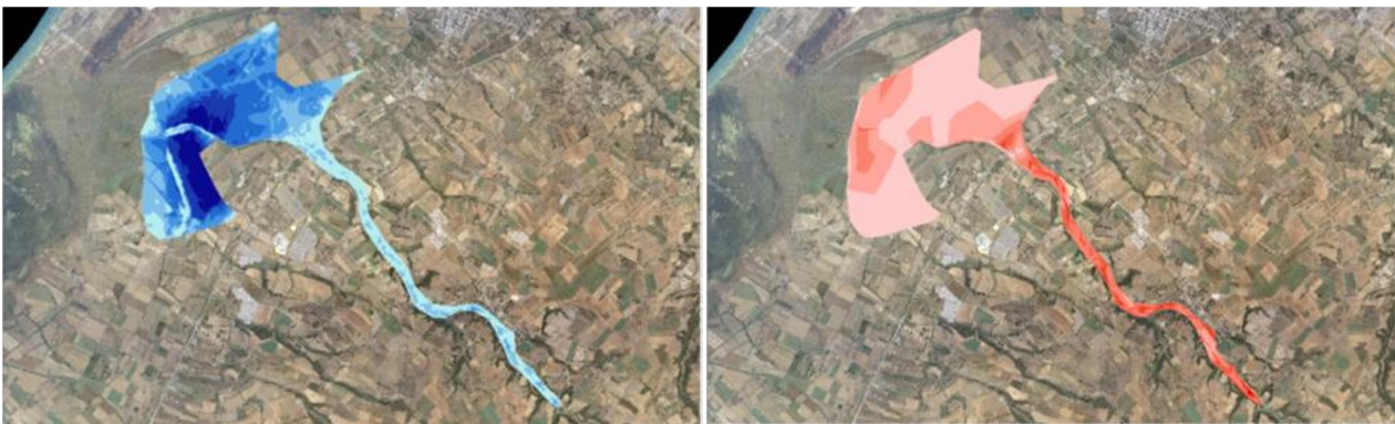
Σχήμα 3.104: Σχηματική απεικόνιση έκτασης - βάθους και ταχυτήτων ροής πλημμύρας του ρ. Καπελεταίικου με περίοδο επαναφοράς T=100 ετών για μη μόνιμη ροή (HEC-RAS).
