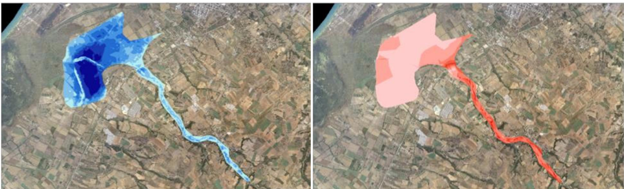
Σχήμα 3.105: Σχηματική απεικόνιση έκτασης - βάθους και ταχυτήτων ροής πλημμύρας του ρ. Καπελεταίικου με περίοδο επαναφοράς T=1000 ετών για μη μόνιμη ροή (HEC-RAS).
