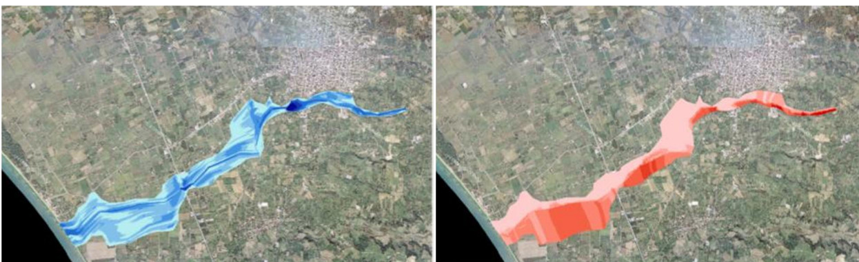
Σχήμα 3.130: Σχηματική απεικόνιση έκτασης - βάθους και ταχυτήτων ροής πλημμύρας του ρ. Μουντρούμη με περίοδο επαναφοράς T=1000 ετών για μη μόνιμη ροή (HEC-RAS).
