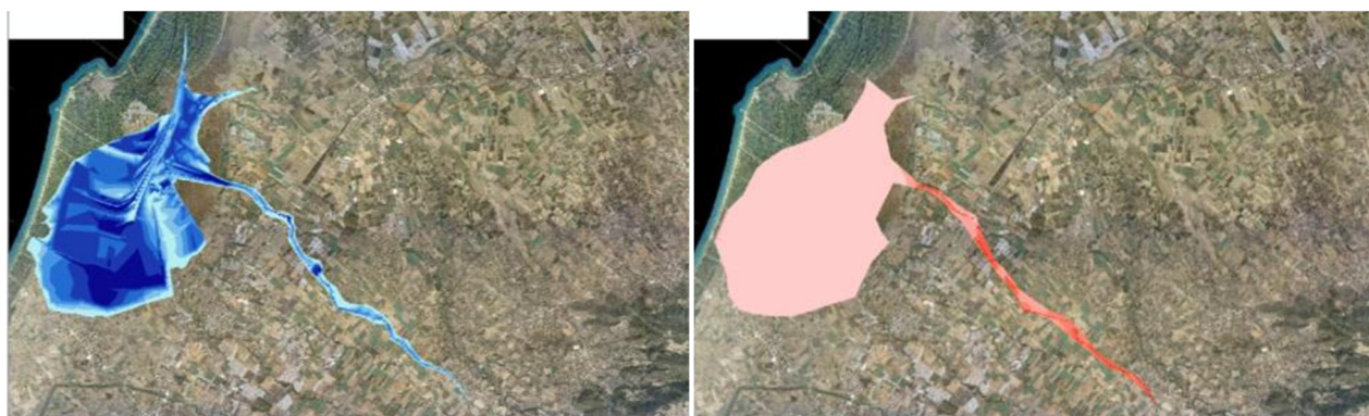
Σχήμα 3.95: Σχηματική απεικόνιση έκτασης - βάθους και ταχυτήτων ροής πλημμύρας του ρ. Ρούσκουλα με περίοδο επαναφοράς T=1000 ετών για μη μόνιμη ροή (HEC-RAS).
