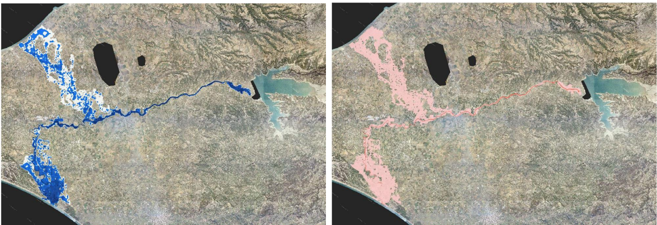
Σχήμα 3.154: Σχηματική απεικόνιση έκτασης - βάθους και ταχυτήτων ροής πλημμύρας του π. Πηνειού με περίοδο επαναφοράς T=50 ετών για μη μόνιμη ροή (MIKE FLOOD).
