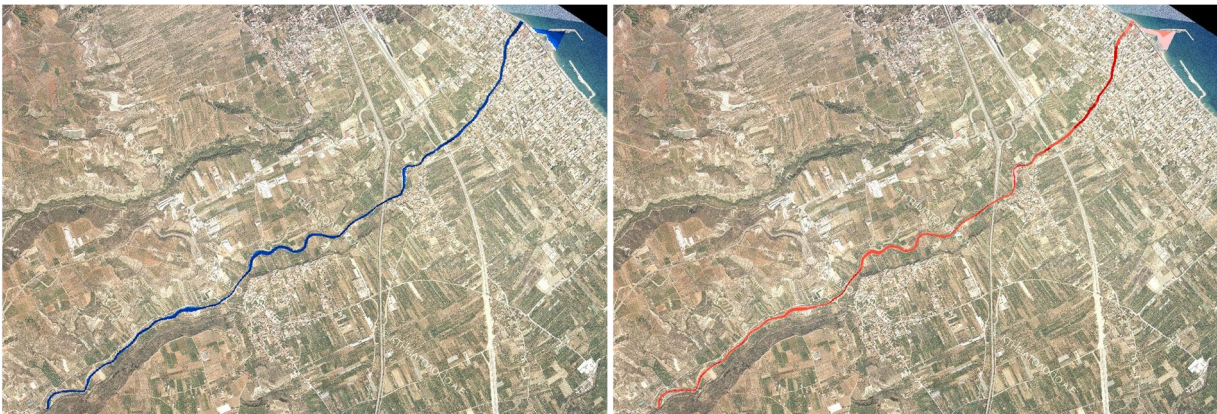
Σχήμα 2.1: Σχηματική απεικόνιση έκτασης - βάθους και ταχυτήτων ροής πλημμύρας του ρ. Ελισσών με περίοδο επαναφοράς T=50 ετών για μη μόνιμη ροή (MIKE FLOOD).
