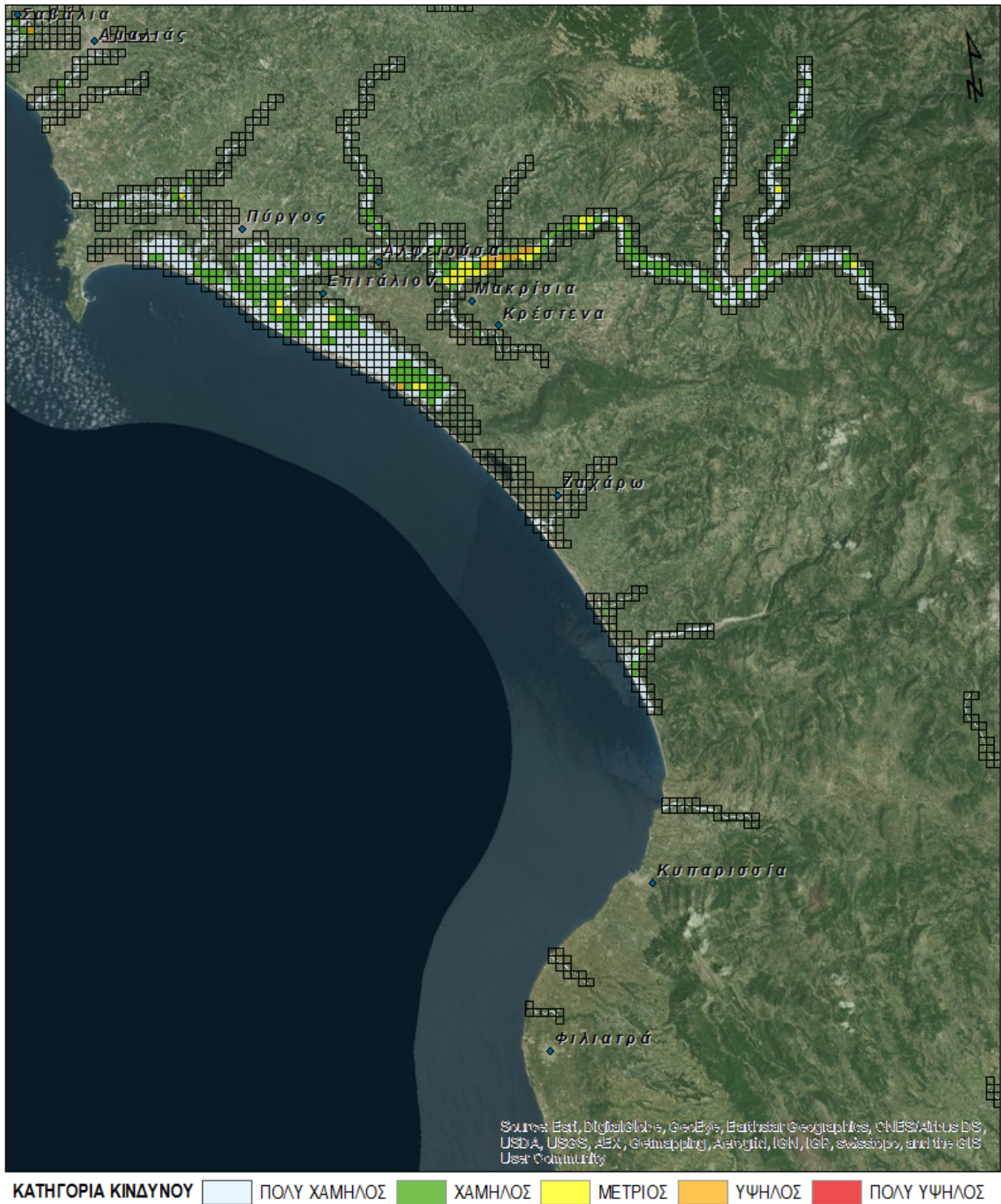
Εικόνα 5.20: Αξιολόγηση επιπτώσεων πλημμύρας για T=50 έτη - ΖΔΥΚΠ GR01RAK0004-Χαμηλές περιοχές π. Αλφειού και παράκτια ζώνη χειμάρρων από το ύψος της πόλης Κρέστενα μέχρι τα Φιλιατρά (περιοχές π. Νέδα, ρ. Καλού Νερού, ρ. Φιλιατρινό και λοιπών χειμάρρων)
