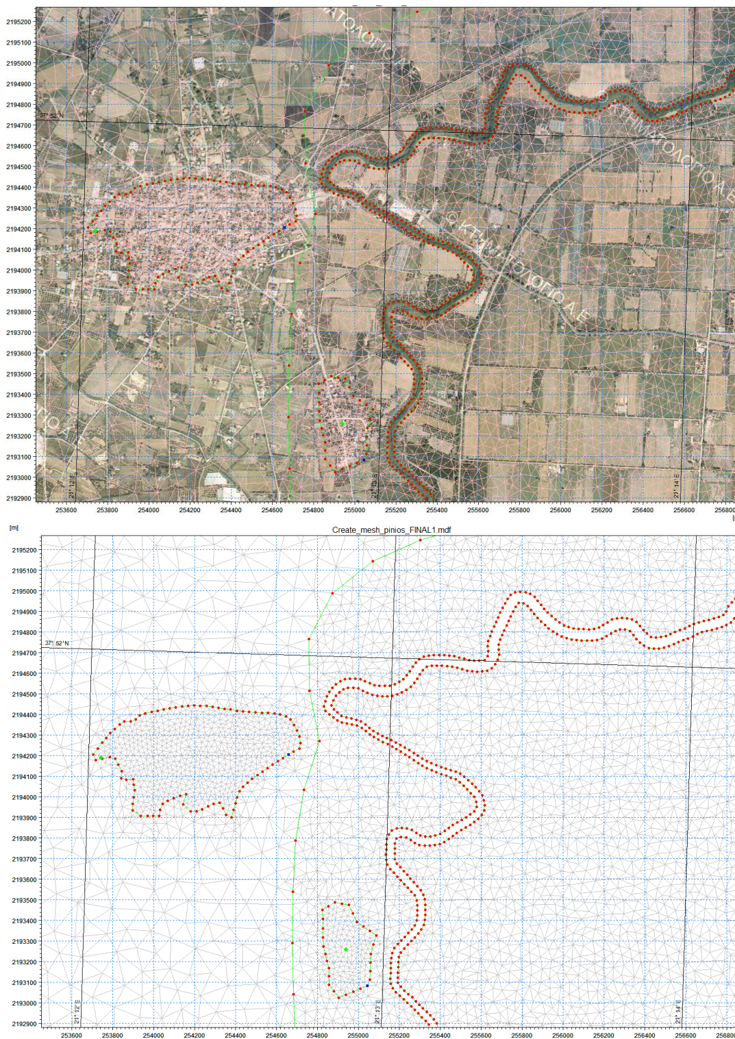
Σχήμα 5.4: Σχηματική απεικόνιση μοντελοποίησης σε περιοχή εκτός κοίτης του ποταμού με τριγωνικά πεπερασμένα στοιχεία
