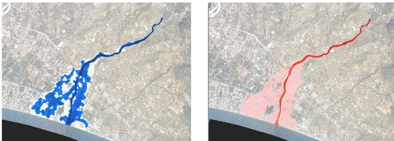
Σχήμα 3.42: Σχηματική απεικόνιση έκτασης-βάθους και ταχυτήτων ροής πλημμύρας του ρ. Βαθύ Λαγκάδι με περίοδο επαναφοράς T=1000 ετών για μη μόνιμη ροή (MIKE FLOOD).
