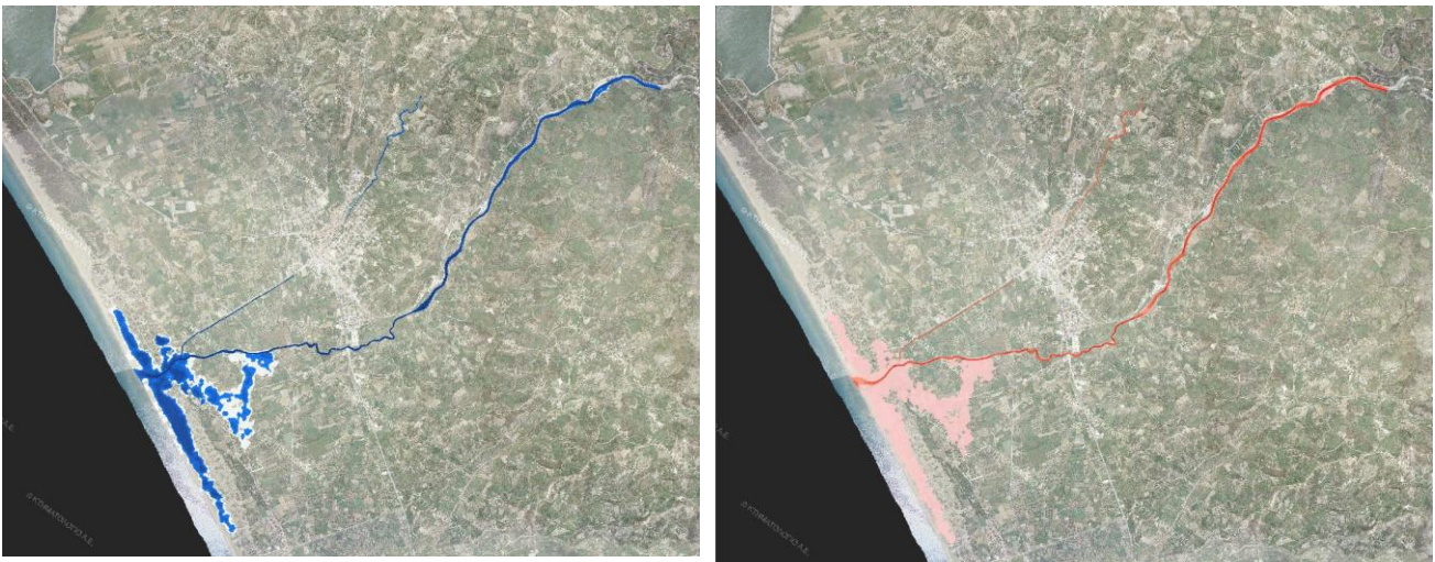
Σχήμα 3.102: Σχηματική απεικόνιση έκτασης βάθους και ταχυτήτων ροής πλημμύρας του ρ. Ζαχαραίικου με περίοδο επαναφοράς T=50 ετών για μη μόνιμη ροή (MIKE FLOOD).
