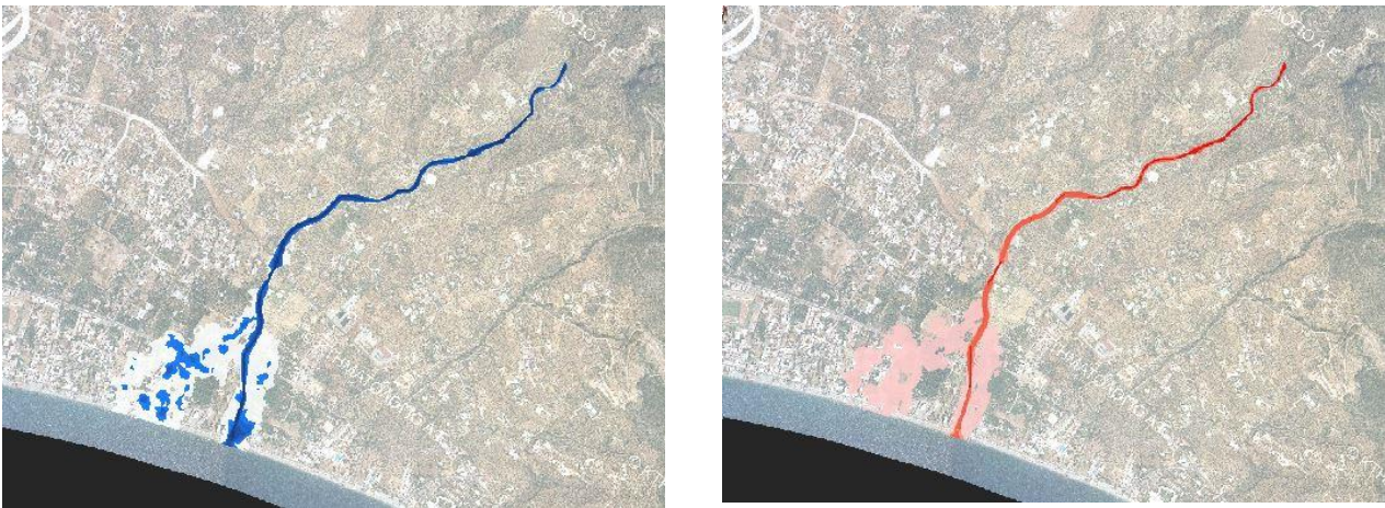
Σχήμα 3.41: Σχηματική απεικόνιση έκτασης βάθους και ταχυτήτων ροής πλημμύρας του ρ. Βαθύ Λαγκάδι με περίοδο επαναφοράς T=100 ετών για μη μόνιμη ροή (MIKE FLOOD).
