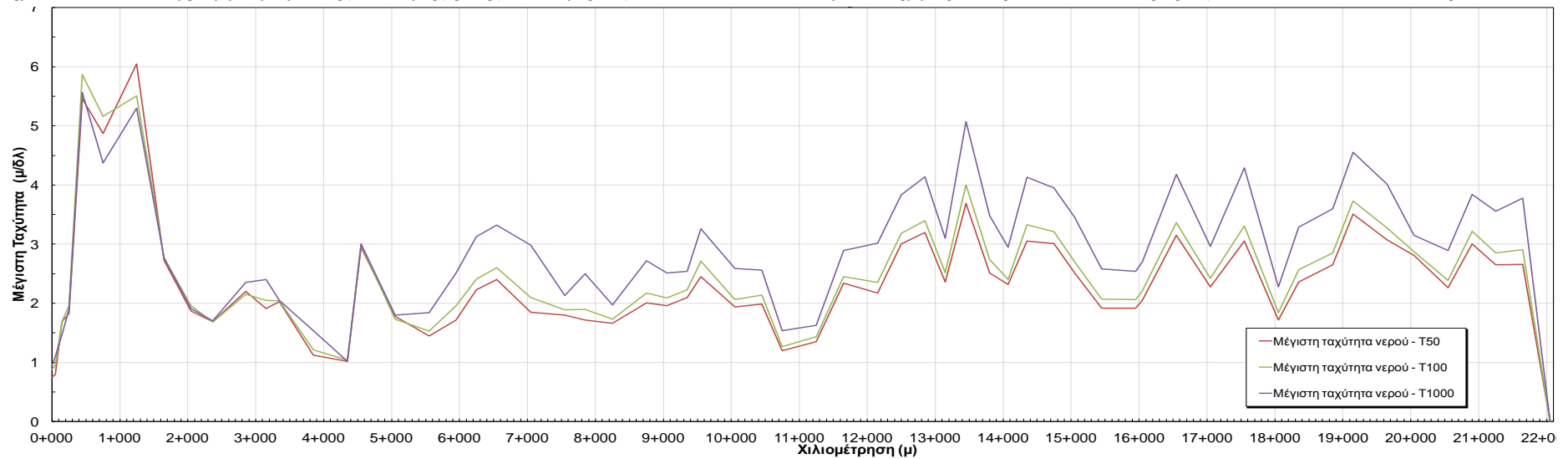
Σχήμα 3.101 Διάγραμμα μέγιστης ταχύτητας ροής κατά μήκος του π. Λεστενίτσα για πλημμύρα περιόδου επαναφοράς T=50,100 και 1000 έτη
